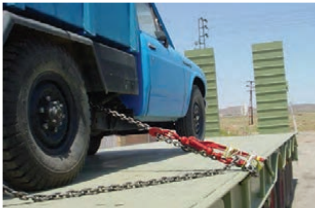
شکل ۲۲- نمونه‌ای از مهار نادرست یک اتومبیل
