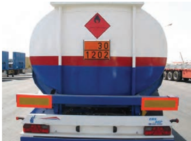
شکل ۲۰- پلاک نارنجی رنگ و علامت مشخصه (لوزی خطر) نصب شده در پشت یک تانکر
