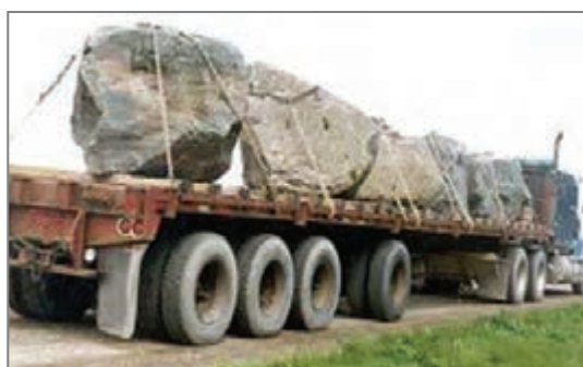
شکل ۱۶- نمونه‌ای از مهار صحیح سنگ‌ها
