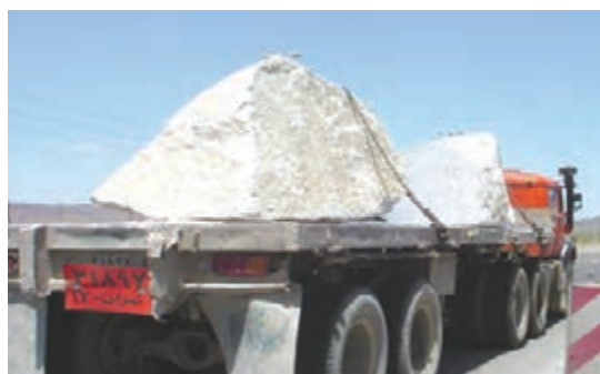
شکل ۱۷- نمونه‌ای از مهار نادرست سنگ‌ها
