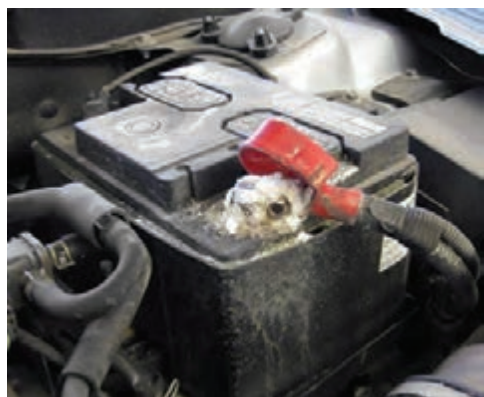
شکل ۴۱- سولفاته کردن قطب باتری
