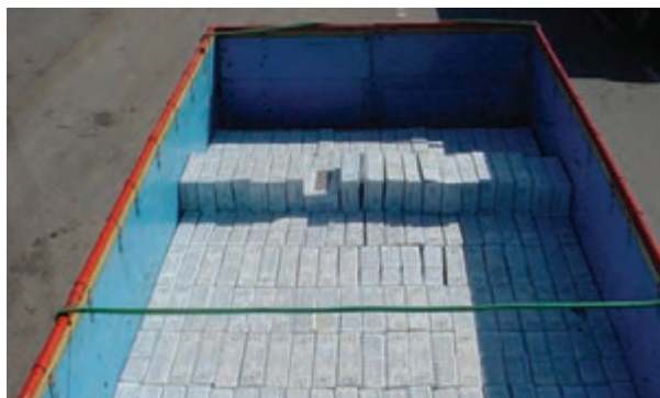
شکل ۵۴- نحوه پک کردن بارهای محاط
