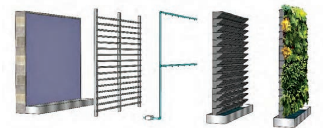
نحوه اتصال گلدان‌های کاشت روی شبکه‌های فلزی
