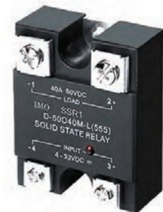
شکل ۶۵-۷ یک نمونه رله جامد صنعتی
