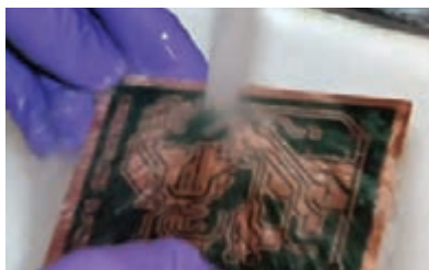
شکل ۳-۲۵- شست و شوی فیبر بعد از ظهور
