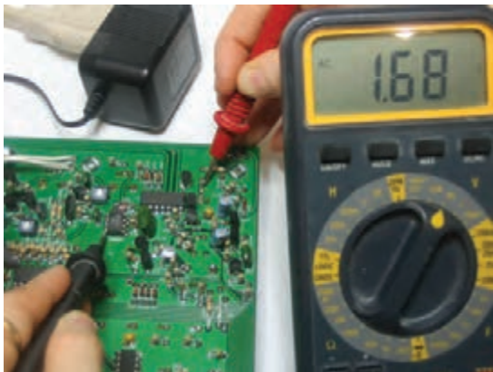
شکل ۵-۵- ولتاژگیری در مدار
