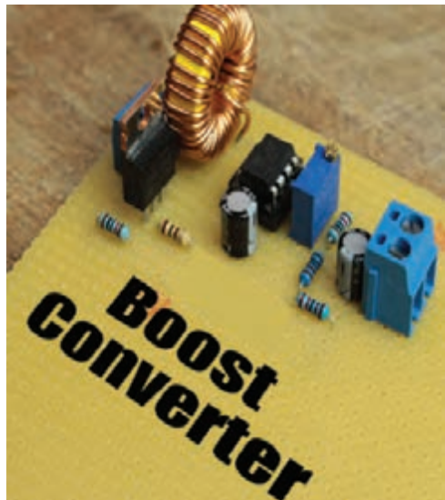
شکل ۳۱-۲- یک نمونه مدار مبدل DC به DC
