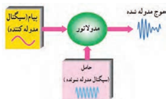
شکل ۶-۴۸ بلوک دیاگرام نحوه انجام مدولاسیون
