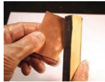
شکل ۶-۳- پرداخت کردن لبه فیبر
