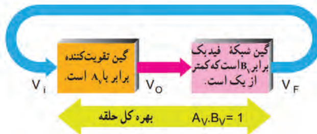
شکل ۶-۳۰ بررسی اصل بارک‌هاوزن
