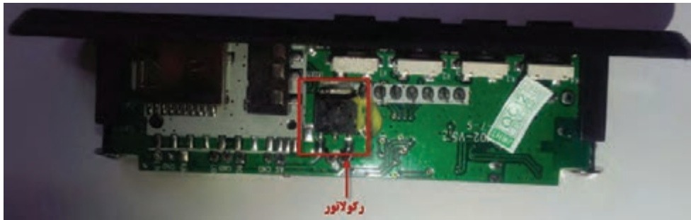
شکل ۵-۸- برد MP۳ با رگولاتور ۷۸۰۵ داخلی
