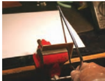
شکل ۷-۳- بریدن فیبر با اره آهن‌بر
