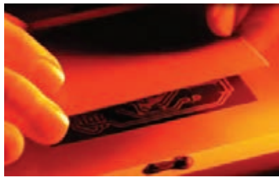
شکل ۳-۲۱- قرار دادن فیبر روی نقشه
