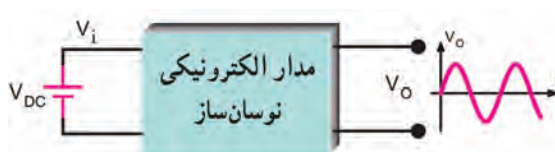
شکل ۲۳-۶ نقشه بلوکی نوسان‌ساز سینوسی
