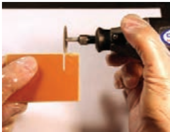
شکل ۸-۳- بریدن فیبر با مینی‌فرز
