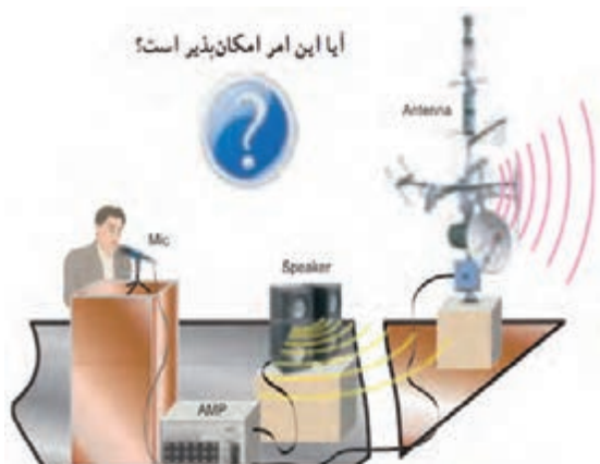
شکل ۶-۴۷ تبدیل امواج صوتی به امواج الکترومغناطیس
