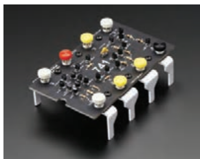
شکل ۴-۵۴- مدار داخلی آی سی ۷۴۱ با قطعات مجزا
