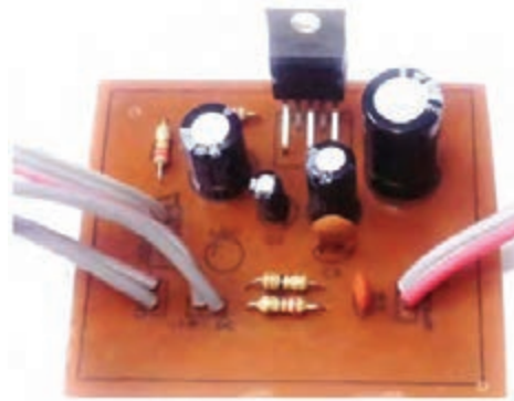
شکل ۴-۹۰- مدار مونتاژ شده تقویت کننده
