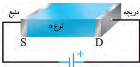
شکل ۴-۱۷- نیمه‌هادی با ناخالصی N به عنوان کانال
