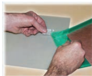
شکل ۳-۱۱- جدا کردن روکش لمینت
