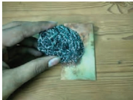
شکل ۳-۹- تمیز کردن فیبر مسی
