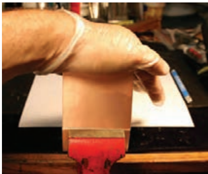
شکل ۳-۵- شکستن فیبر خام به وسیله گیره فلزی
