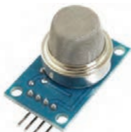
شکل ۹۸-۴- ماژول تشخیص گاز خانگی
