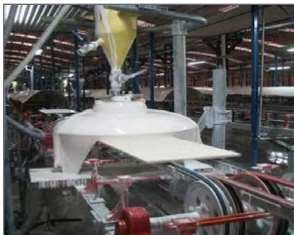
شکل ۲۳- لعاب‌زنی به روش آبشاری
