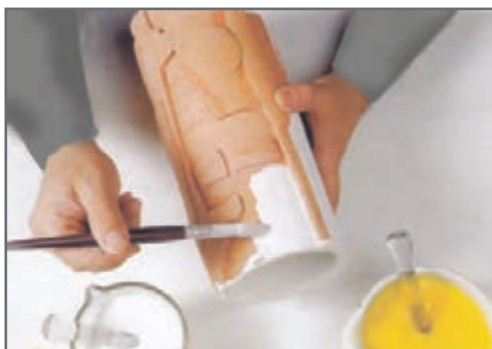
شکل ۱۱- اعمال لعاب بر روی سطح بیرونی قطعه
