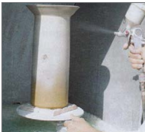
ب - لعاب‌زنی با استفاده از روش اسپری کردن
