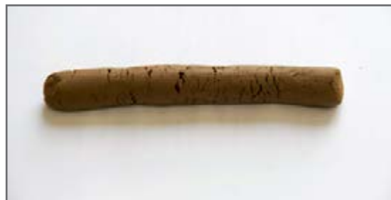
گل با شکل‌پذیری نامناسب - دارای ترک
