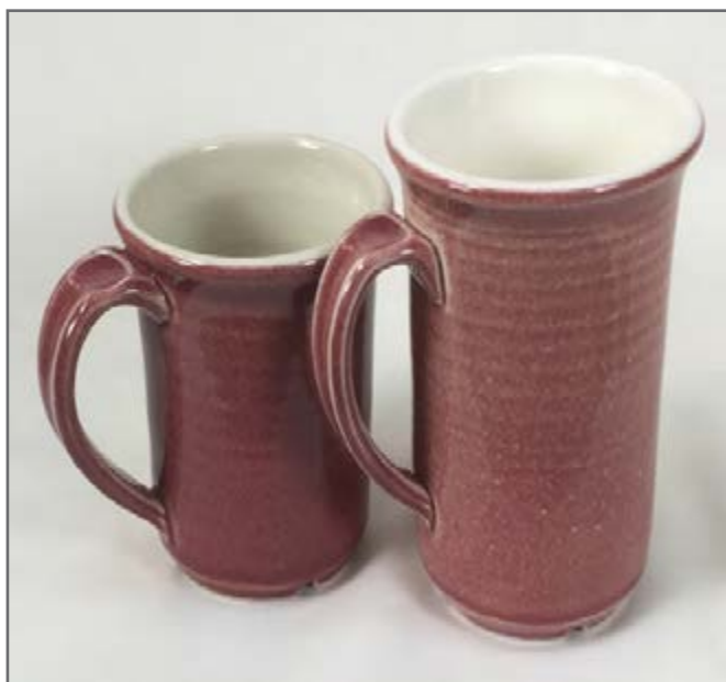
شکل ۲۵- لعاب با دمای پخت نامناسب
