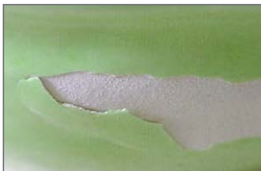
شکل ۲۷- عیب پوسته شدن لعاب
