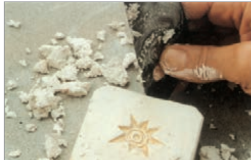
شکل ۱۲- تراشیدن طرح بر روی قالب گچی
