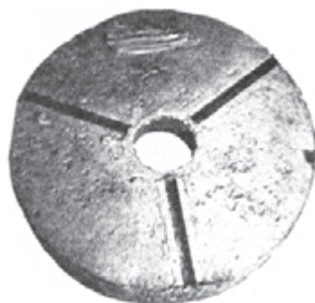
نمونه از قطعه با عیوب آخال و سک‌های میکروسکوپی
