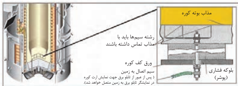
شکل ۱۰- شماتیک اتصال سیم ارت در کوره القایی
