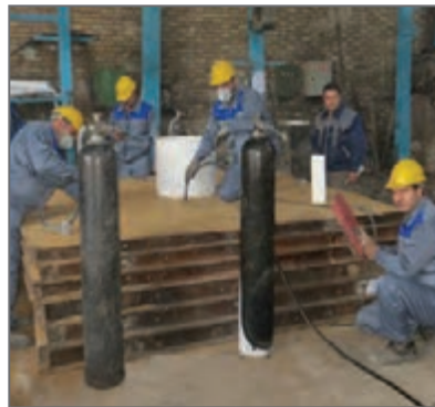
ب) دمش گاز CO 2 جهت استحکام بخشی قالب
