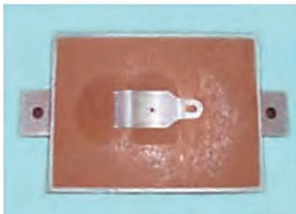
شکل ۲۱. سطح قالب‌های زیرین را پودر جدایش بزنید.
