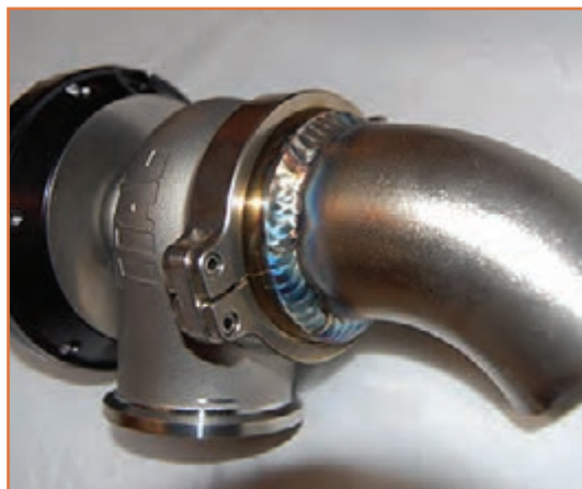
الف - جوش کاری دو قطعه فولادی
