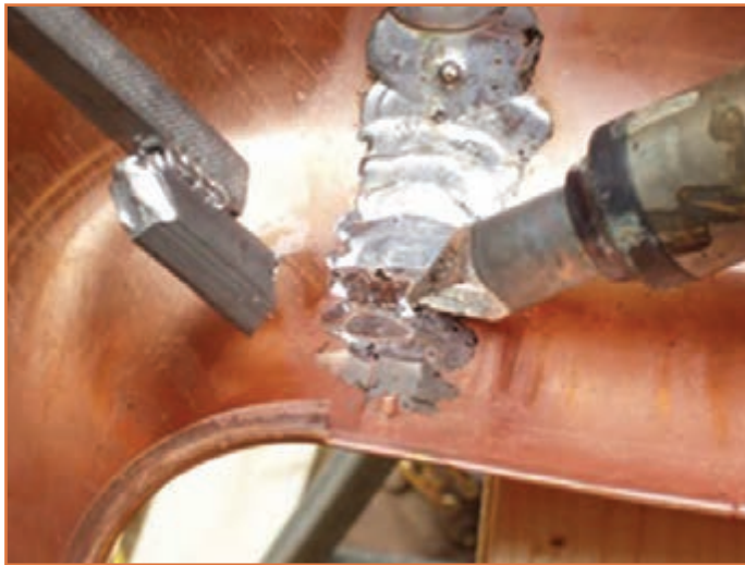
شکل ۲۲ - پرکردن درز اتصال به وسیله مذاب لحیم
