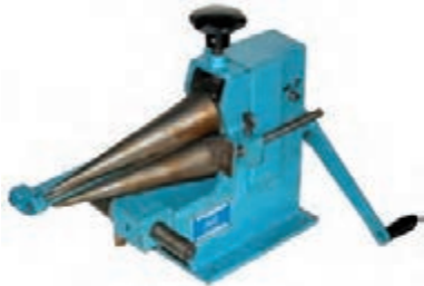
شکل ۲-۲۲ نورد خاص در تولید مخروط ناقص
