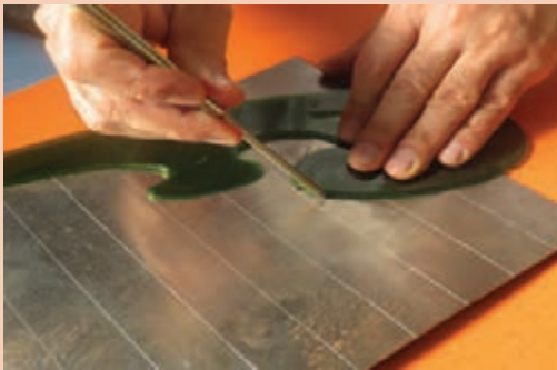
شکل ۳۴-۱- خط کشی ورق فلزی با پیستوله
