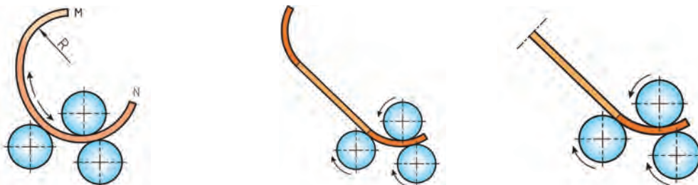
شکل ۲-۷- مراحل رول کاری با دستگاه نورد صاف‌کننده ساده
