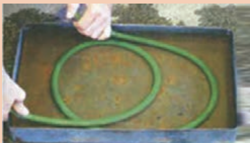
شکل ۳-۳۸- کنترل سلامت شیلنگ‌ها
