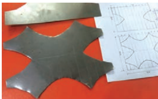
شکل ۴۲-۱- کنترل برش نهایی مطابق با نقشه
