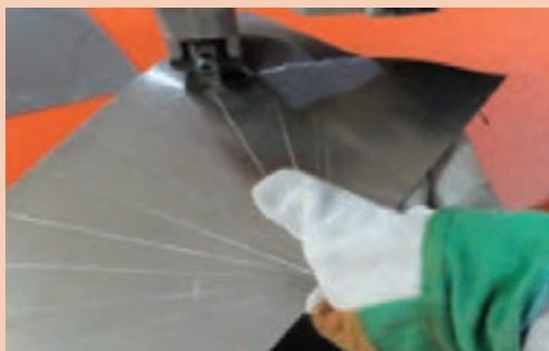
ب) برش کاری منحنی با نیبلر
