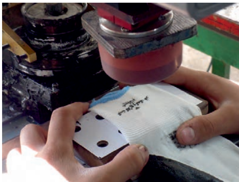
شکل ۳-۳۷ چاپ یک دستکش کار به روش بالشتکی
