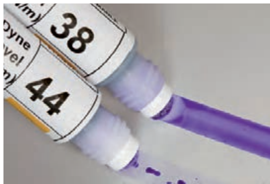
شکل ۳-۴۳ روش استفاده از ماژیک تستر
