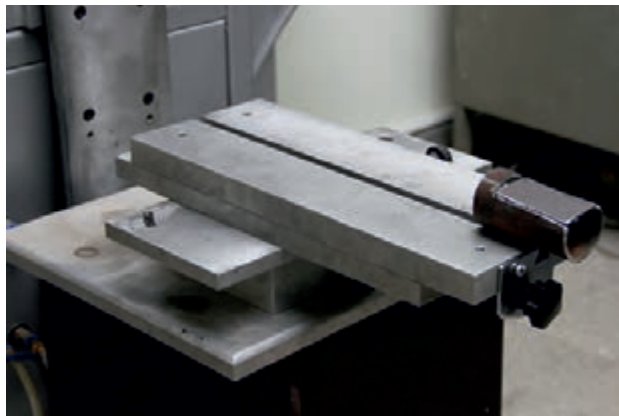
شکل ۵-۸ بستن قالب جای میز دستگاه
