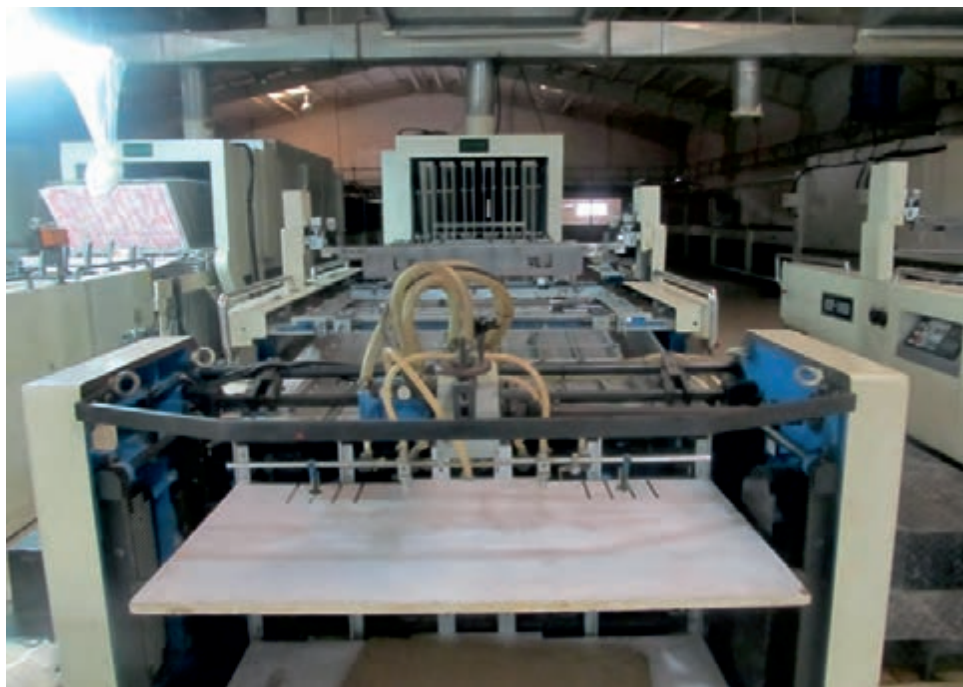
شکل ۲-۲۲ ماشین تمام اتوماتیک اسکرین با سرعت بالا
