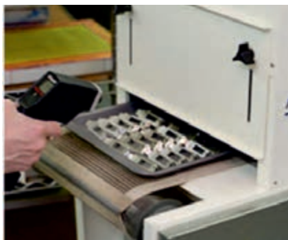
شکل ۳-۶۷- سنجش میزان حرارت خشک کن شکل
