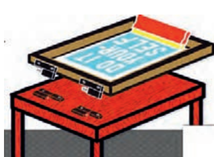
شکل ۲۶-۴ پیچ و لولا به همراه خروسک
