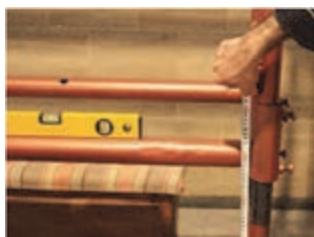
شکل ۱۹ و ۲۰- بستن اجزاء دستگاه با رعایت صحیح فواصل و موازی با افق
