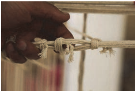
شکل ۵۷- نوع گره مورد استفاده در بستن نخ گرت نقش به نخ‌های شلیت
