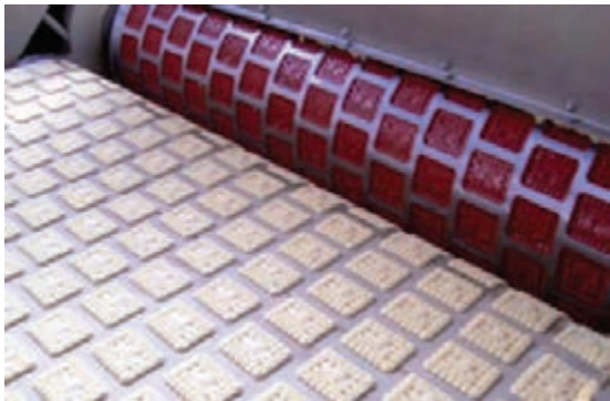
شکل ۷- قالب‌زنی بیسکویت با ماشین قالب‌زن دوار
