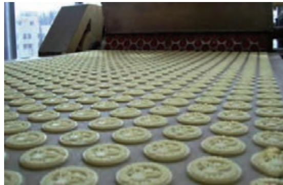
شکل ۷- قالب‌زنی بیسکویت با ماشین قالب‌زن دوار
