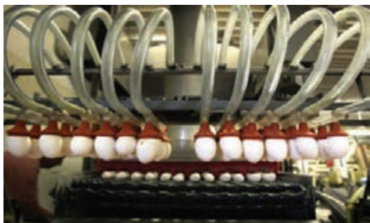
روش برداشتن تخم‌مرغ‌ها توسط دستگاه به صورت خودکار
