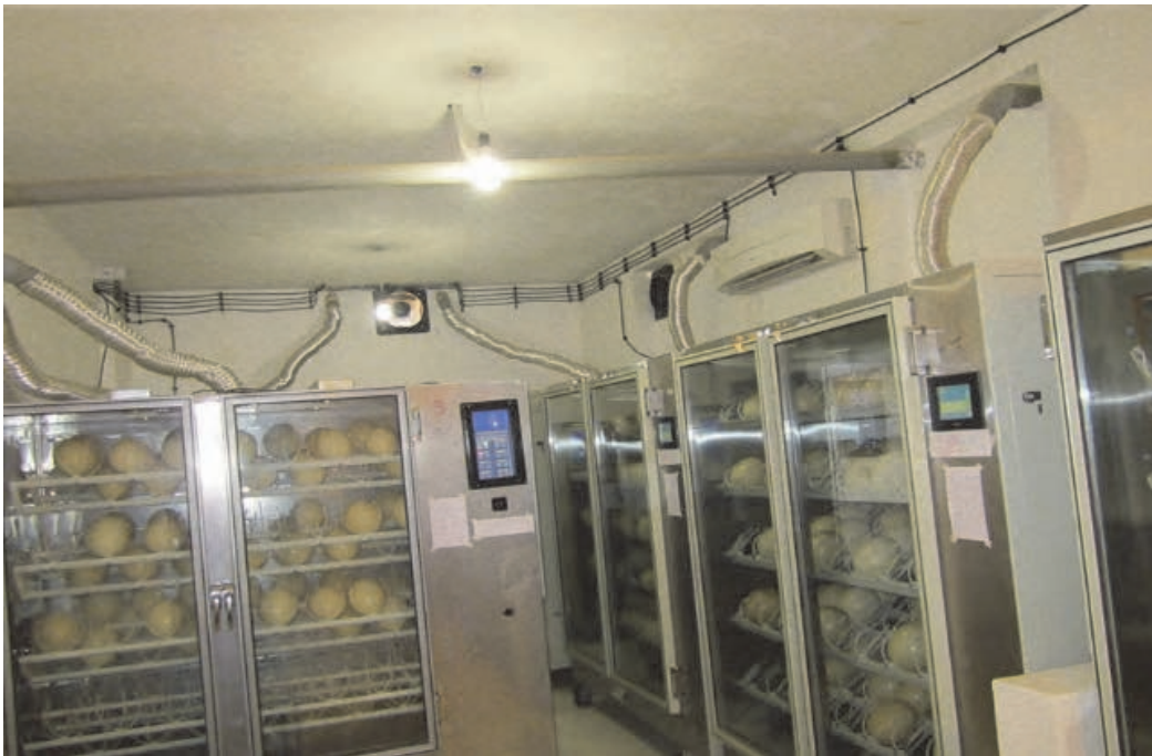
دستگاه ستر مخصوص شترمرغ در سالن جوجه‌کشی
