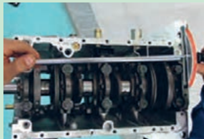
شکل ۴۶. باز کردن پیچ های یاتاقان
