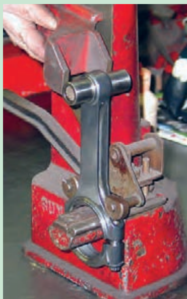
شکل ۸۲. پیچیدگی شاتون، اندازه گیری و اصلاح آن
