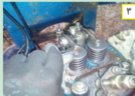
شکل ۳۷. فیلرگیری موتور تراکتور دوچرخ
