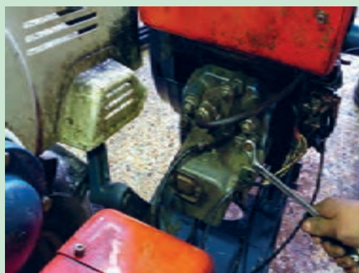
شکل ۵۳. باز کردن درپوش سوپاپ‌ها
