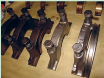
شکل ۴۸. برداشتن کپه های یاتاقان و چیدن آنها
