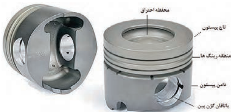
شکل ۶. پیستون و قسمت‌های مختلف آن
