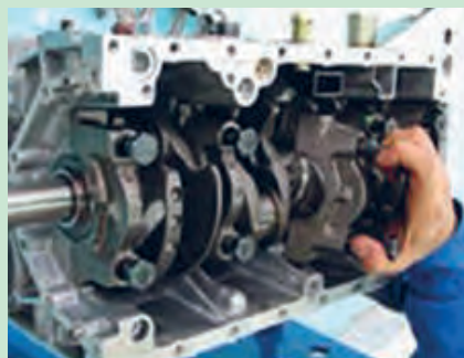
شکل ۴۸. برداشتن کپه های یاتاقان و چیدن آنها
