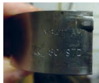
شکل ۲۳. تغییر ضخامت یاتاقان در سایزهای مختلف
