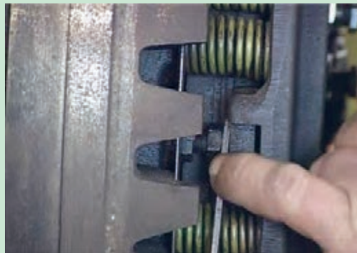
شکل ۳۹. تنظیم کلاچ محور تواندهی
