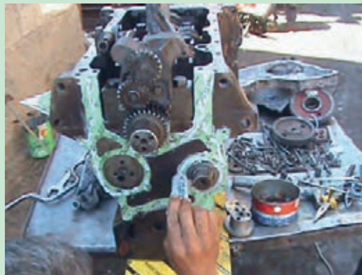
شکل ۱۰۶. چسباندن واشر صفحه پشت چرخ دنده های تایمینگ شکل ۱۰۷. نصب صفحه پشت چرخ دنده های تایمینگ
