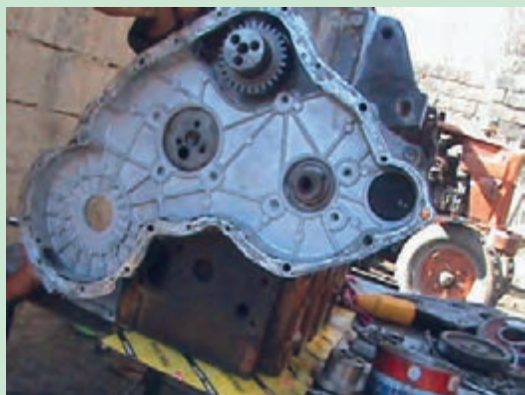
شکل ۱۰۶. چسباندن واشر صفحه پشت چرخ دنده های تایمینگ شکل ۱۰۷. نصب صفحه پشت چرخ دنده های تایمینگ
