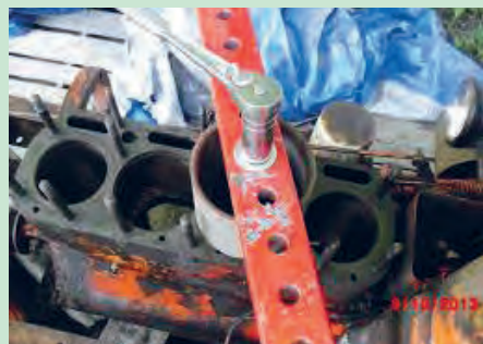
شکل ۹۰. جازدن بوش با ابزار
