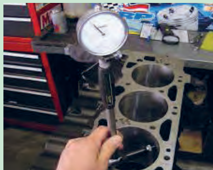
شکل ۷۶. اندازه‌گیری قطر سیلندر با میکرومتر داخلی
