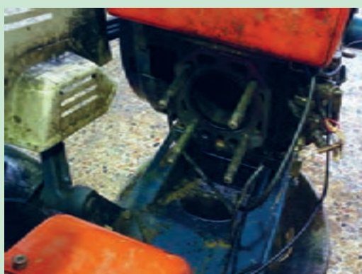
شکل ۵۶. برداشتن سر سیلندر
