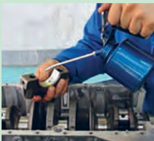
شکل ۹۵. روغنکاری یاتاقان ها قبل از نصب
