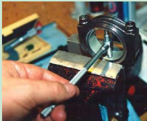
شکل ۸۳. کنترل بیضی شدن سر بزرگ شاتون
