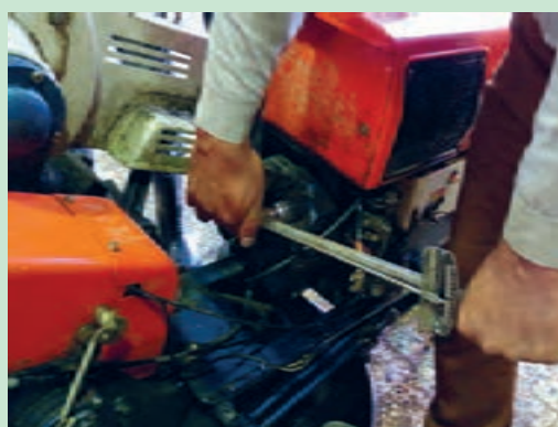
شکل ۵۵. باز کردن سر سیلندر
