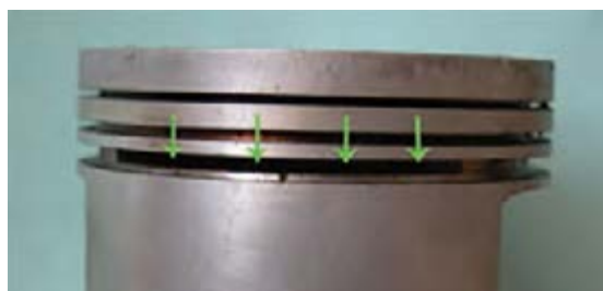
شکل ۹. ترتیب قرار گرفتن رینگها و موقعیت شیار عرضی پیستون زیر ناحیه قرار گرفتن رینگ روغنی
