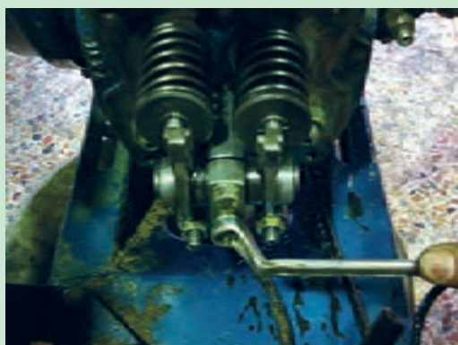
شکل ۵۴. باز کردن مجموعه اسبک‌ها
