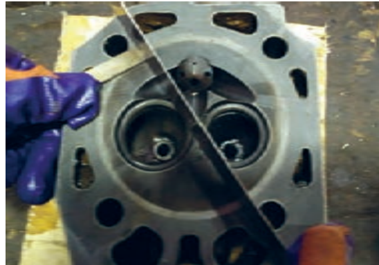
شکل ۶۵. کنترل تابیدگی سرسیلندر تراکتور دوچرخ
