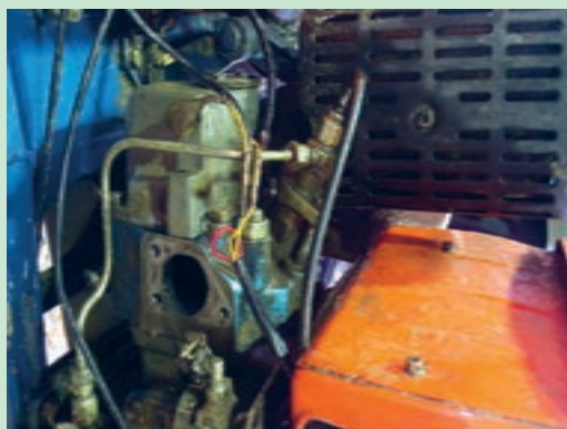
شکل ۵۲. باز کردن مانیفولد هوا
