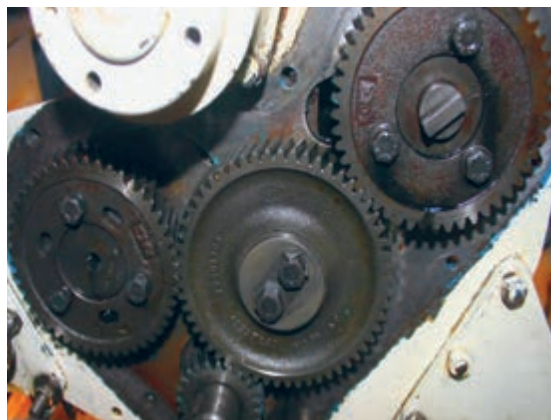
شکل ۲۷. چرخ دنده‌های تایمینگ در سینی جلو موتور
