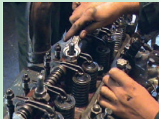
شکل ۴۵. باز کردن پیچ‌های پایه اسبک
