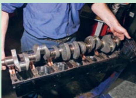
شکل ۴۹. برداشتن میل لنگ
