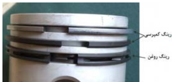
شکل ۹. ترتیب قرار گرفتن رینگها و موقعیت شیار عرضی پیستون زیر ناحیه قرار گرفتن رینگ روغنی
