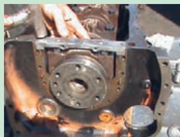
شکل ۹۷. جا زدن قطعه آب بندی کارتر
