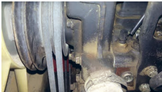
شکل ۱۰. محل فشنگی آب روی تراکتور MF۳۹۹
