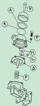
شکل ۳۷. شکل شماتیک و نمای برش خورده پمپ مقدماتی تراکتور MF285
