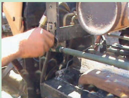
شکل ۴۱- باز کردن انباره اگزوز تراکتور MF۳۹۹
