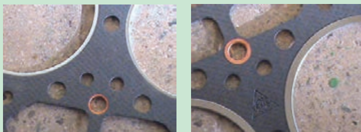
شکل ۸۷. تفاوت ضخامت قسمت‌های مسی روی واشر سرسیلندر
