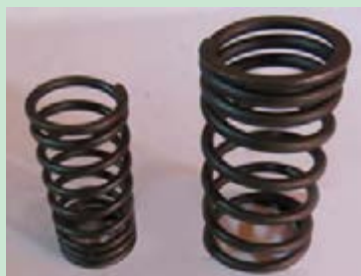
شکل ۱۸. فنرهای سوپاپ در تراکتور MF۲۸۵
