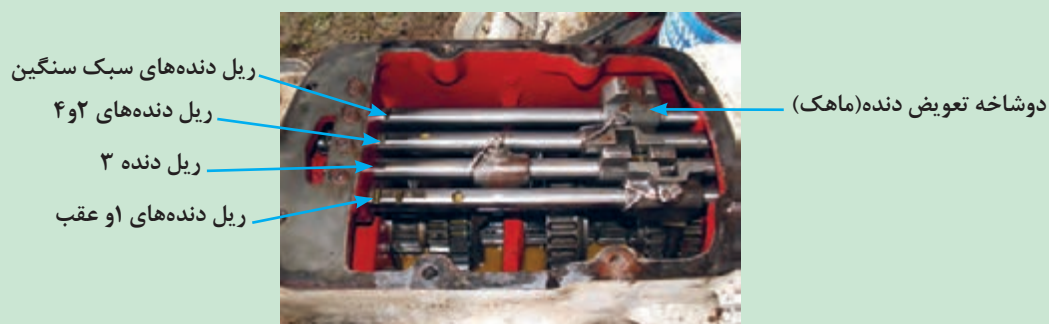
شکل ۳۰. جعبه دنده تراکتور MF285
