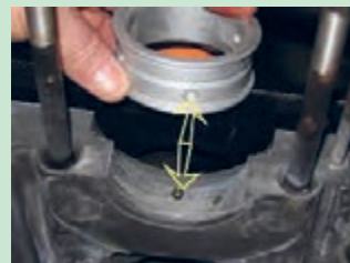
شکل ۹۳. قرار گرفتن سوراخ روغن مقابل هم
