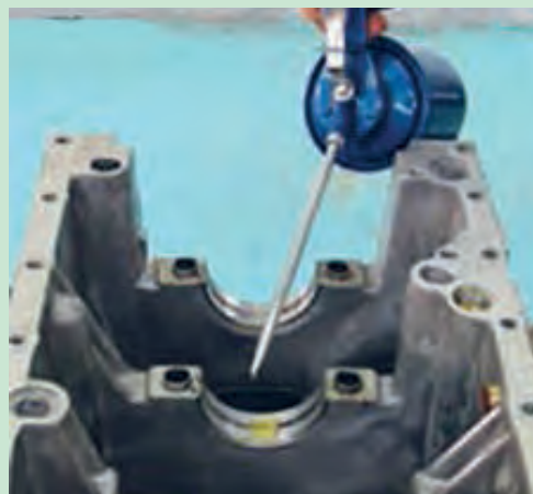
شکل ۹۵. روغنکاری یاتاقان ها قبل از نصب
