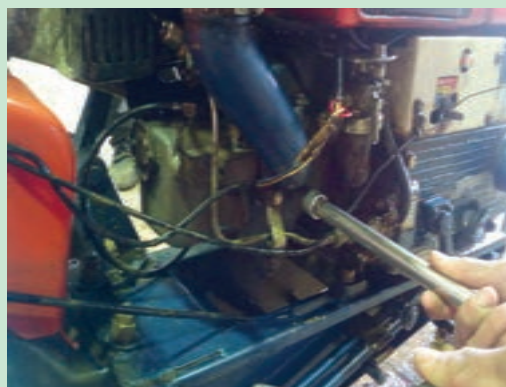
شکل ۵۲. باز کردن مانیفولد هوا
