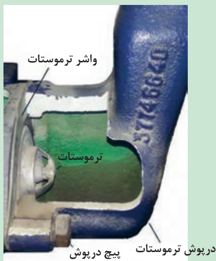
شکل ۱۷. نمای برش خورده ترموستات تراکتور MF۲۸۵
