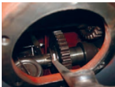
شکل ۲۱. محور تواندهی در حالت موتور گرد
