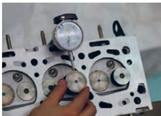
شکل ۷۳. روش کنترل لقی بین سوپاپ و گیت
