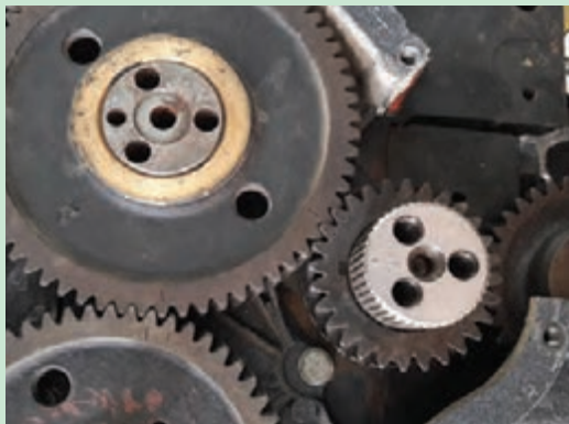
شکل ۱۰۹. علامت‌های تایمینگ روی چرخ دنده‌ها
