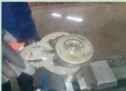
شکل ۵۲. نحوه خارج کردن رینگ از روی پیستون
