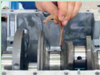
شکل ۵۰. برداشتن یاتاقان های ثابت و بغل یاتاقانی
