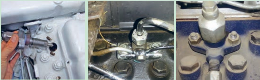
شکل ۳۴ الف. اتصالات انژکتور تراکتور MF285 شکل ۳۴ ب. اتصالات انژکتور تراکتور MF399 شکل ۳۵. خارج کردن انژکتور
