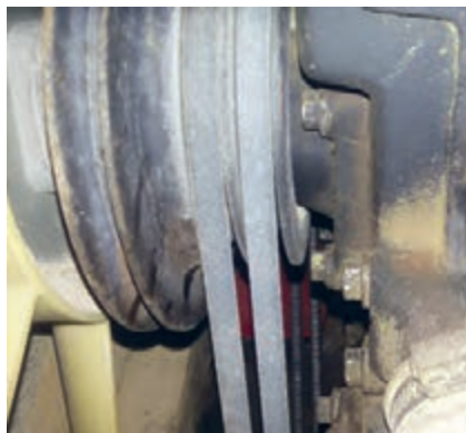
شکل ۷. استفاده از دو تسمه در تراکتور MF۳۹۹
