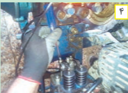
شکل ۳۷. فیلرگیری موتور تراکتور دوچرخ
