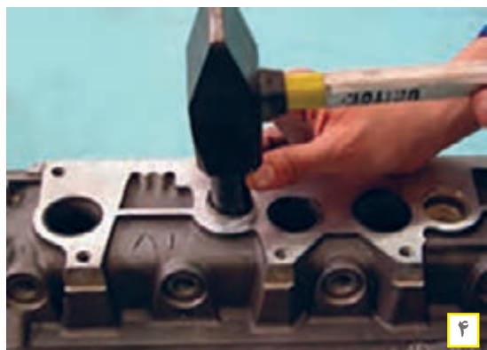
شکل ۶۹. روش تعویض پولک سر سیلندر
