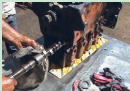
ب- خارج کردن میل سوپاپ
