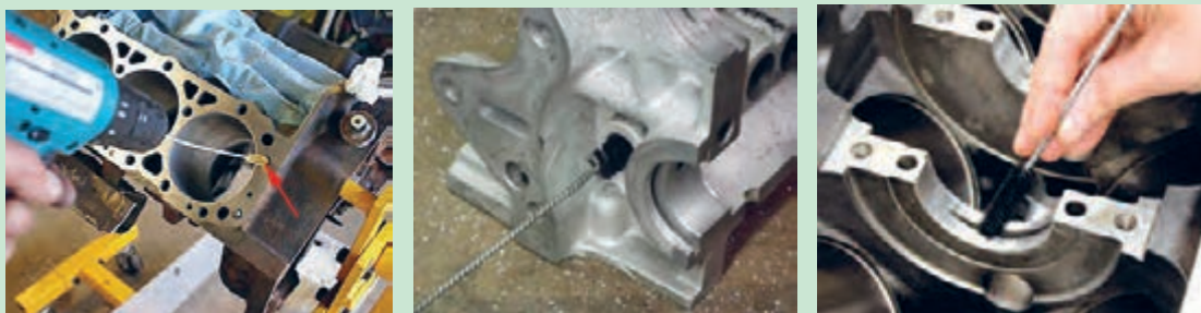
شکل ۵۹. تمیز کردن مجاری آب و روغن
