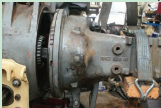
شکل ۷. باز کردن پوسته قیفی تراکتور MF285
