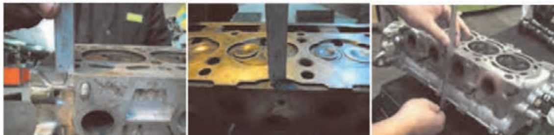
شکل ۸۳. کنترل ارتفاع مجاز کف تراشی سر سیلندر
