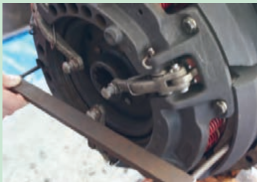
شکل ۳۸. تنظیم انگشتی‌های کلاچ
