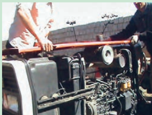
شکل ۴۰. برداشتن کاپوت تراکتور MF۳۹۹
