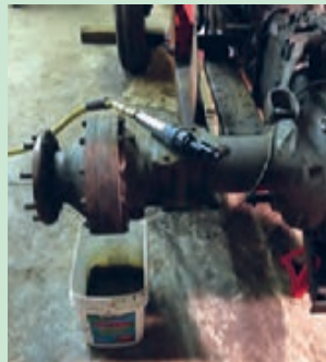
شکل ۳۲. کاهنده نهایی بعد از باز کردن چرخ
