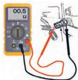
شکل ۴۹. کنترل فشنگی روغن
