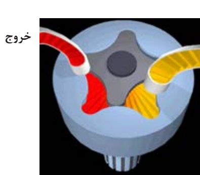
شکل ۴۳. پمپ روغن روتوری
