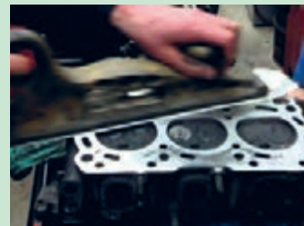
شکل ۶۶. تمیز کردن سطح بلوکه سیلندر با سنباده زنی دستی و الکتریکی
