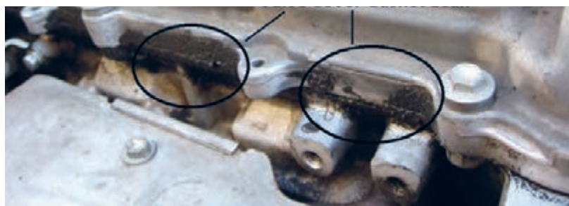
شکل ۲۷. نشستی روغن از درپوش سوپاپ‌ها
