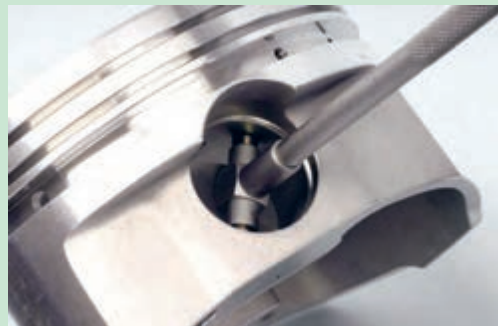
شکل ۸۱. اندازه گیری لقی گزن بین در پیستون
