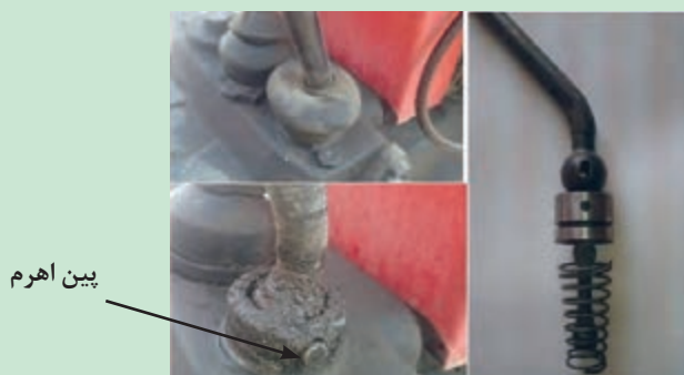
شکل ۲۹. خارج کردن اهرم‌های تعویض دنده
