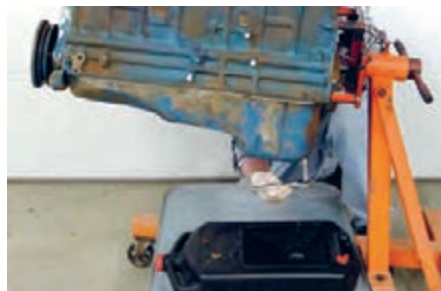
شکل ۳۳. موتور نصب شده روی استند
