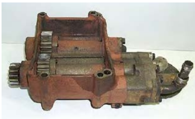
شکل ۴۴. بالانس‌های نصب شده روی پمپ روغن
