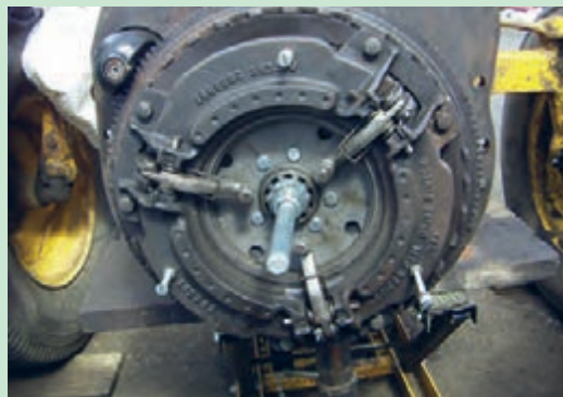
شکل ۳۷. سوار کردن مجموعه کلاچ روی فلاپیول
