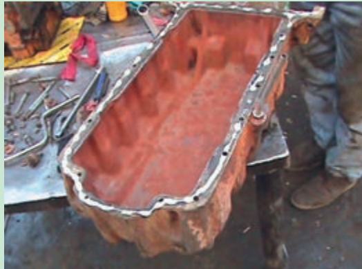
شکل ۱۱۴. جسابندن واشر کارتر
