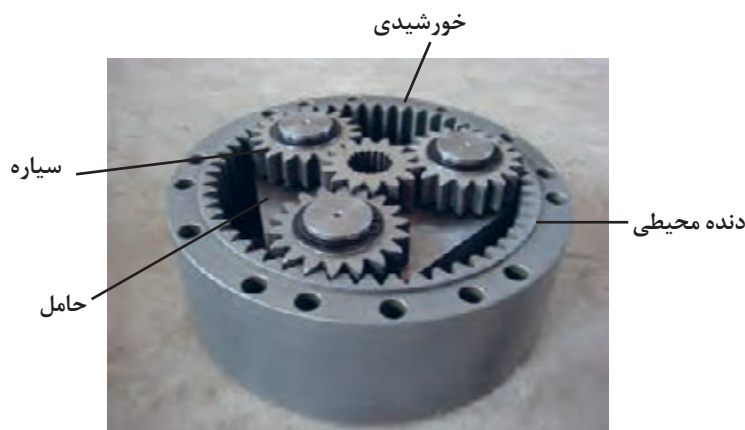
شکل ۱۱. جعبه دنده سیاره‌ای
