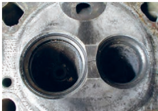
شکل ۶۶. ترک خوردگی سرسیلندر در محفظه احتراق
