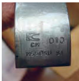
شکل ۲۳. تغییر ضخامت یاتاقان در سایزهای مختلف
