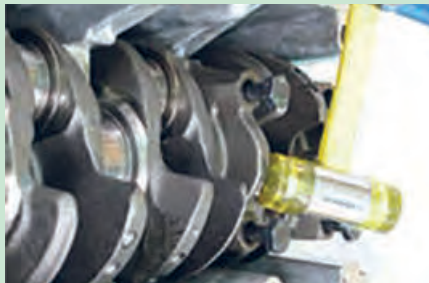
شکل ۴۷. شل کردن کپه های یاتاقان
