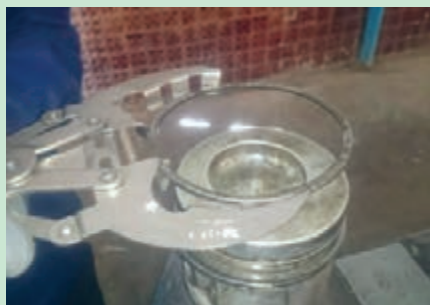
شکل ۵۲. نحوه خارج کردن رینگ از روی پیستون
