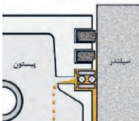
شکل ۱۲. بازگرداندن روغن اضافه توسط رینگ روغن
