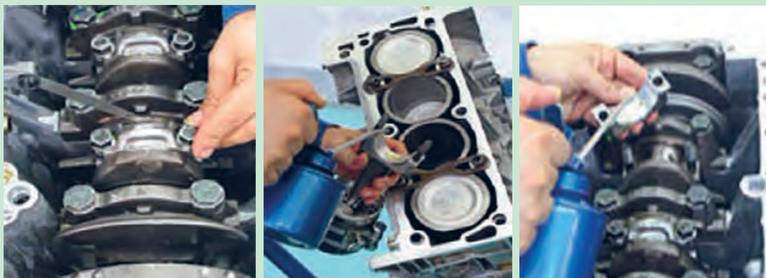
شکل ۱۰۲. کنترل لقی شاتون روی محور میل لنگ
