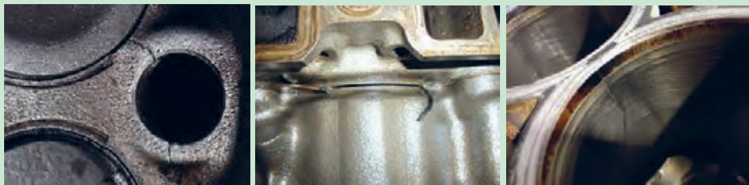
شکل ۶۲. ترک در سیلندر و بلوکه سیلندر
