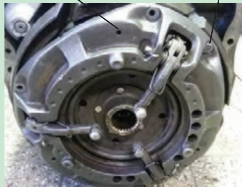
شکل ۲۵. جدا کردن مجموعه کلاچ از فلاپویل
