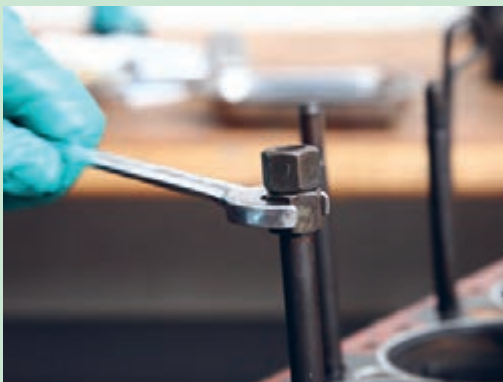
شکل ۵۱. باز کردن پیچ های دوسر دنده به وسیله دو عدد مهره
