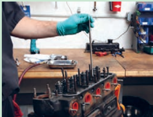
شکل ۴۷. خارج کردن میل تپت‌ها
