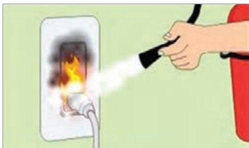
شکل ۱۳-۳ عدم استفاده از کپسول آب در آتش سوزی های برقی
