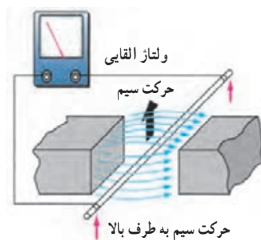
شکل ۸-۲۳- اساس کار یک ژنراتور ساده
