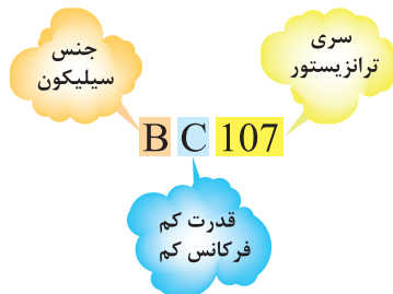
شکل ۶۷-۱۴ مشخصات ترانزیستور BC107
