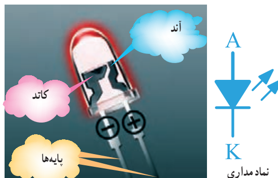
شکل ۳۰-۱۳- نماد فنی و ساختمان داخلی LED
