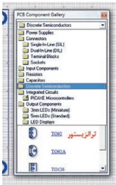
شکل ۴۹-۶- انتخاب پایه‌های ترانزیستور BC547
