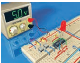
شکل ۷-۴- بستن مدار روی بردبرد و آزمایش آن
