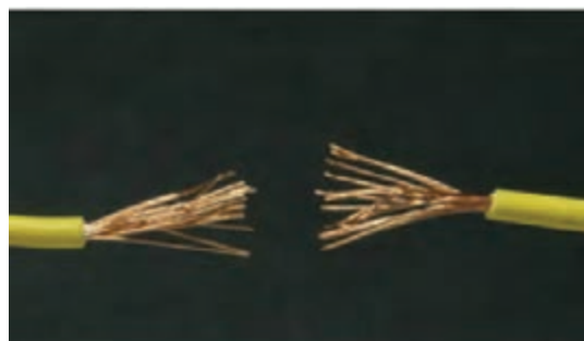
تارها را در هم بتنید و مجموعه اتصال را صاف و هماهنگ کنید.
