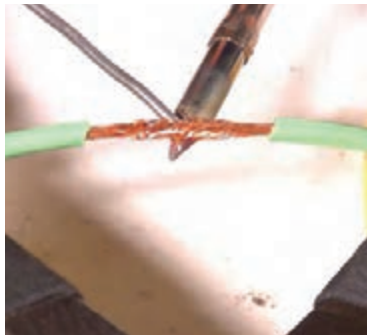
شکل ۴۹-۱- لحیم یک اتصال با سیم افشان
