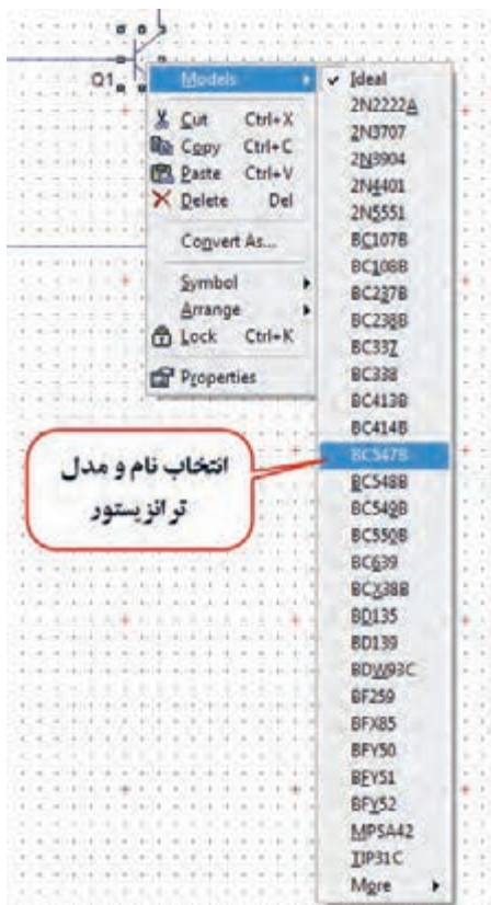
شکل ۱۹-۶- نحوه انتخاب نام و مدل ترانزیستور
