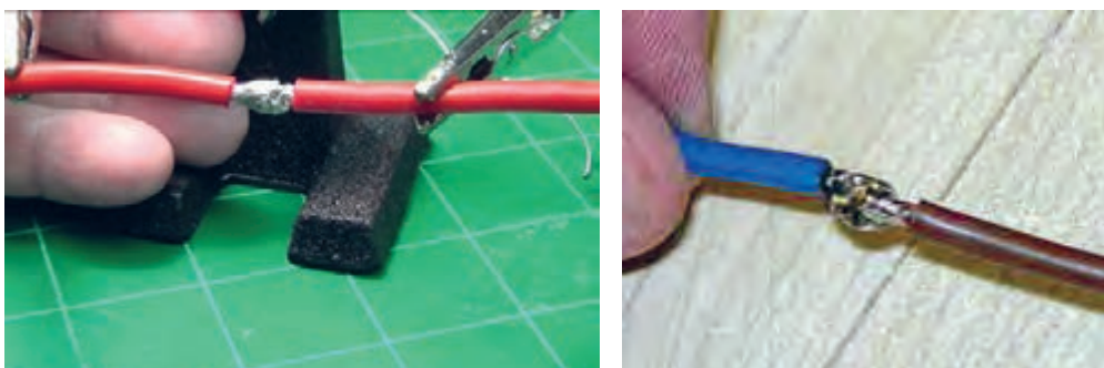
شکل ۱-۵۳ - اتصال دو رشته سیم افشان
