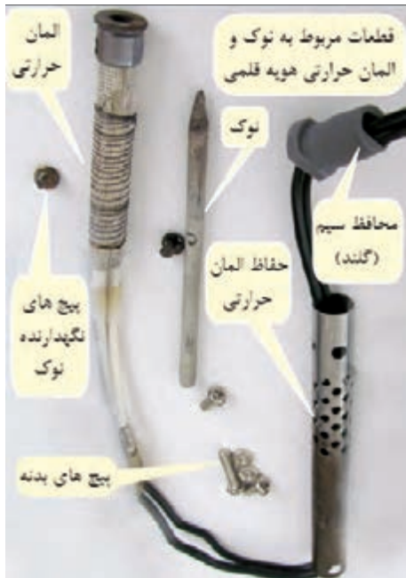
شکل ۹۵-۱ - مراقبت از اجزاء داخلی هویه قلمی
