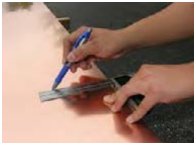
الف - تعیین اندازه فیبر
