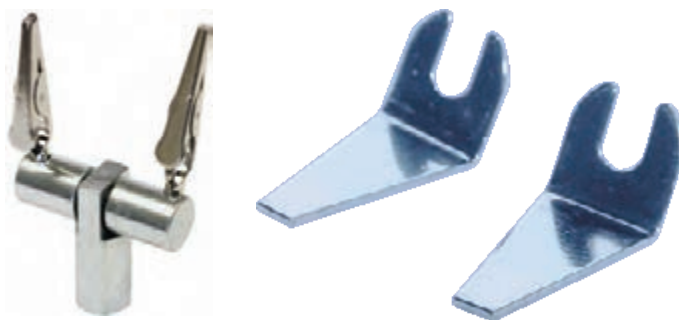
شکل ۴۵-۱- گیره لحیم کاری ونوع دیگر نوک هویه
