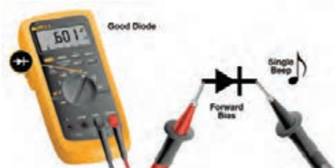
شکل ۳-۶- وضعیت تست دیود در بایاس موافق
