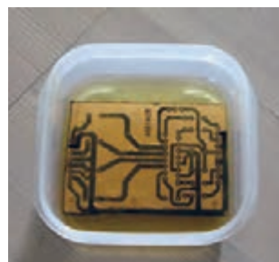
شکل ۷-۱۴- اندازه سطح محلول اسید و آب ۲میلیمتر بالاتر از فیبر
