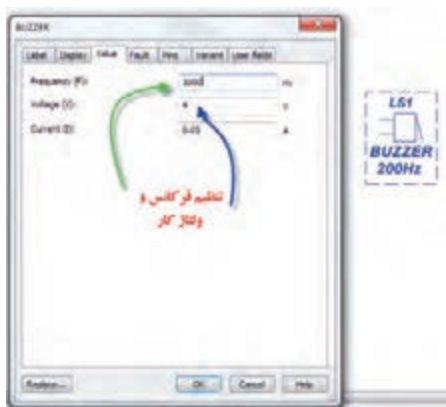
شکل ۶-۲۵- تنظیم فرکانس و ولتاژ کار بی‌زر
