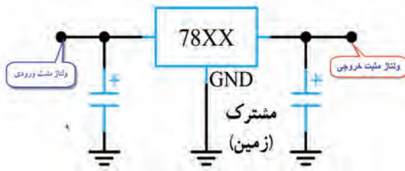
شکل ۷۱-۳- مدار استاندارد قرار گرفتن آی‌سی در مدار
