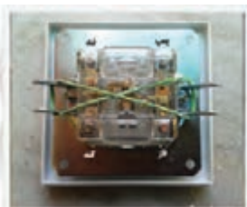
شکل ۲-۸۰ - ساختمان داخلی کلید کولر
