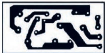
شکل ۲۲-۵- طرح مدار چاپی
