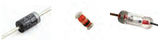
شکل ۳-۳- تصویر چند نوع دیود با نوار رنگی
