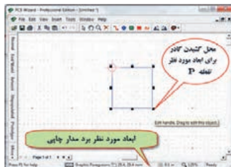
شکل ۳۸-۶ نحوه تعیین اندازه برد مدار چاپی
