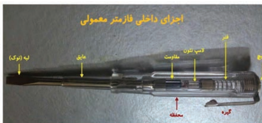
شکل ۲-۳۷- ساختمان داخلی فازمتر
