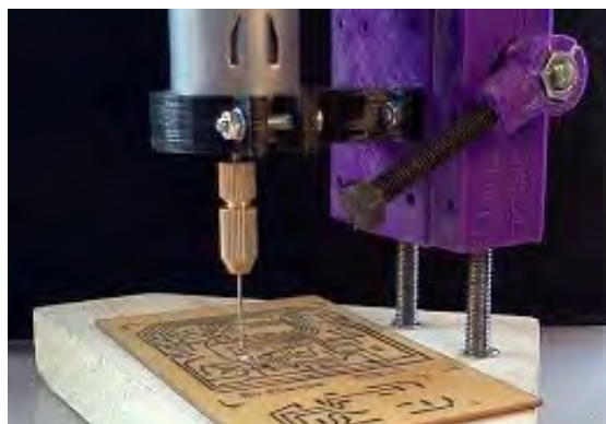
شکل ۱۸-۷- سوراخ کاری پایه قطعات با مته مناسب
