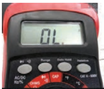
شکل ۳-۶- وضعیت تست دیود در بایاس موافق
