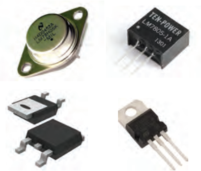
شکل ۷۲-۳- بسته بندی آی‌سی‌های رگولاتور
