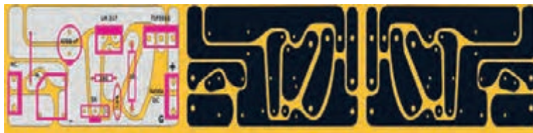
شکل ۲۰-۵- طراحی مدار چاپی و نقشه معکوس مدار چاپی
