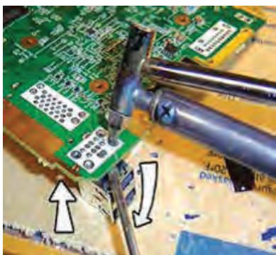
شکل ۸۷-۱- استفاده از قلع کش حرارتی
