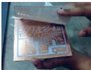
شکل ۱۱-۷- جدا کردن کاغذ از سطح روی فیبر
