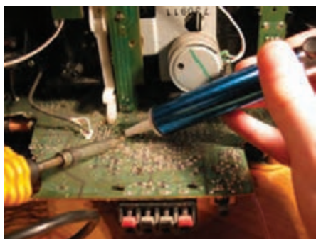
شکل ۸۴-۱- مراحل ذوب شدن و مکش قلع
