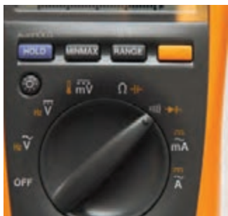
شکل ۳-۵- مولتی متر دیجیتالی در حالت آزمایش دیود
