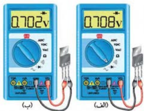
شکل ۴-۴- ولتاژ موافق کلکتور-بیس و امیتر-بیس
