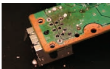
ب- برداشتن لحیمها و آزاد کردن پایهها
