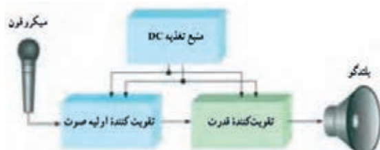
شکل ۴-۱۷- بلوک دیاگرام آمپلی فایر صوتی
