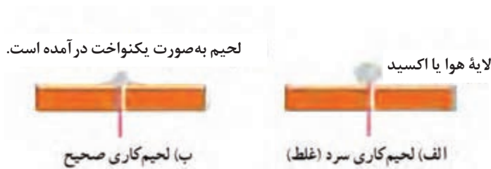
شکل ۵۰-۱- لحیم‌کاری صحیح و غلط
