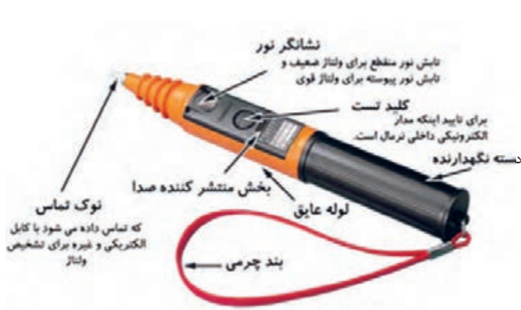
شکل ۳۸-۲- ساختمان داخلی فازمتر دیجیتالی
