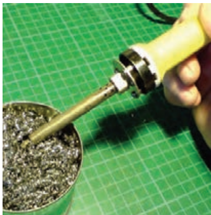
شکل ۴۲-۱ - تمیز کردن نوک هویه با اسفنج مخصوص
