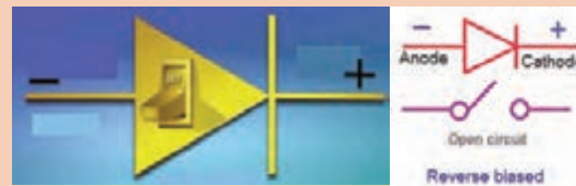
شکل ب ۸-۳- دیود ایده‌آل در بایاس مخالف
