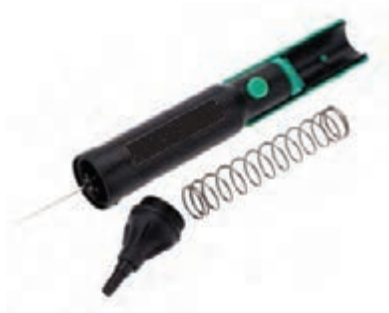
شکل ۸۹-۱ - باز کردن قلع کش پیستونی
