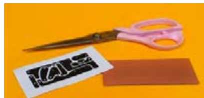
شکل ۷-۷- برش طرح مدار چاپی از کاغذ
