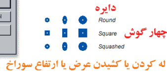
شکل ۶-۳۵- تعیین ویژگی‌های Padها
