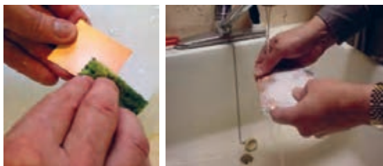
شکل ۱۹-۵- شستشو و تمیز کردن فیبر مدار چاپی
