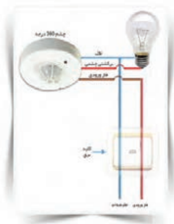
شکل ۲-۷۱- یک نمونه نقشه رله چشمی راه پله
