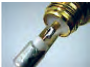
شکل ۱-۷۰- اتصال کابل کوآکسیال به فیش آنتن
