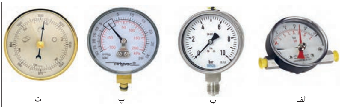
شکل ۱۰- انواع گیج فشار برای چهار نوع فشار
