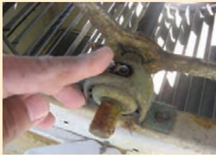
محل روغن کاری یاتاقان
