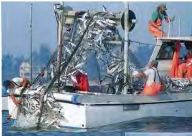
شکل ۳۵- استفاده از وینچ برای جمع‌آوری تورهای گوش‌گیر بزرگ و سنگین
