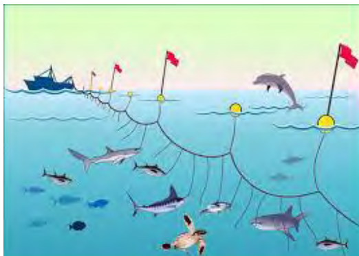
شکل ۲۲- لانگ لاین شناور سطحی
