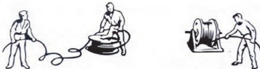
شکل ۱۹- اصول باز کردن حلقه طناب سیمی با قرقره
