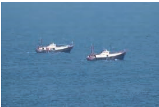
شکل ۴۸- دو فروند کشتی ماهیگیری ترالر زوجی در حین عملیات تورکشی
