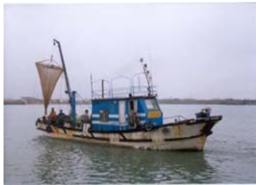
شکل ۴۱- شناورهای ماهیگیری مجهز به تور قیفی ویژه صید ماهی کیلکا در دریای خزر
