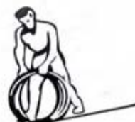
شکل ۱۸- اصول باز کردن حلقه طناب سیمی بدون قرقره
