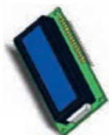
LCD کاراکتری برای نمایش اطلاعاتی مانند فاصله
