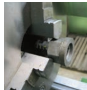
الف: بستن قطعه شش گوش در سه‌نظام
