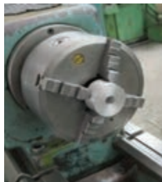
ب: بستن قطعه گرد در چهار نظام
