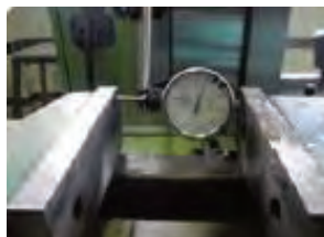
تنظیم گیره به کمک ساعت اندازه گیری
