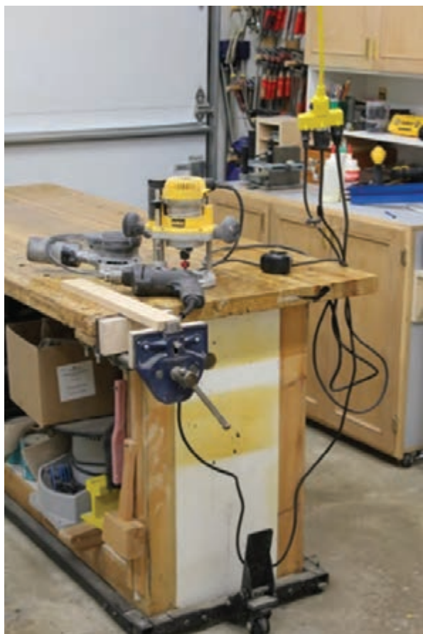
استفاده از پریز سقفی (منظم بودن سیم‌ها)
