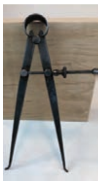
پرگار پاشنه‌ای برای اندازه برداری و اندازه‌گیری و انتقال اندازه‌های داخلی قطعه کار
