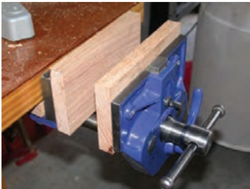
گیره صفحه‌ای که دو صفحه چوبی برای جلوگیری از آسیب قطعه کار به داخل آن نصب شده است.
