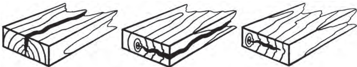
شکاف چوب در اثر سرمای شدید
