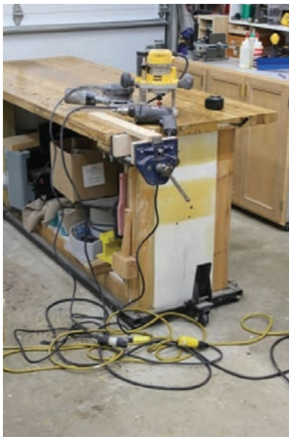
استفاده از پریز زمینی (نامنظم بودن سیم‌ها)
