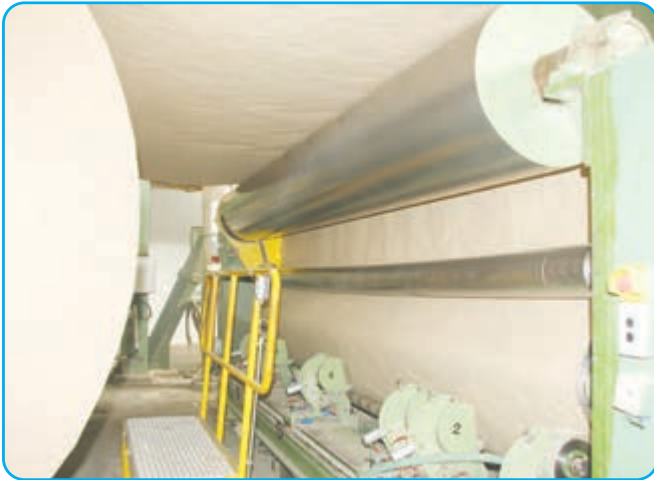
غلتک آهنی برای صاف کردن خمیر کاغذ
