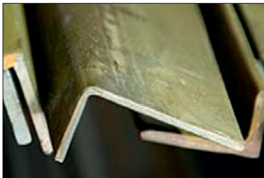
شکل ۲-۳۶ نبشی دو بال نامساوی
