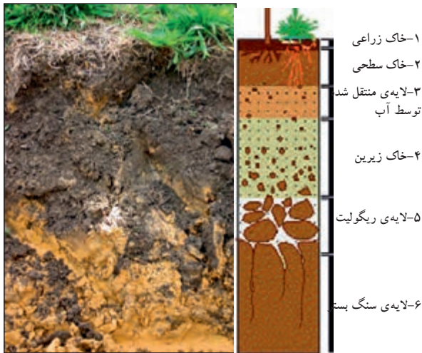
شکل ۱-۲ لایه‌های مختلف خاک با دانه‌بندی متفاوت
