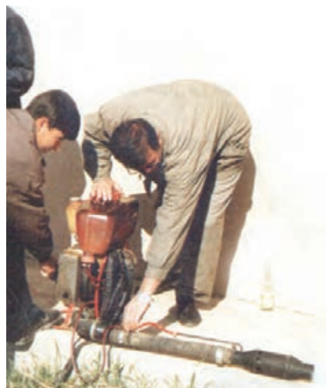
شکل ۲۵-۳- آماده سازی و روشن کردن شعله افکن
