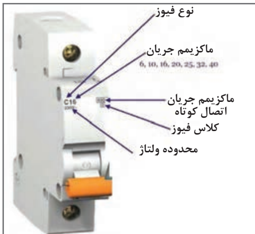
شکل ۱- مشخصات یک نوع فیوز مینیاتوری
