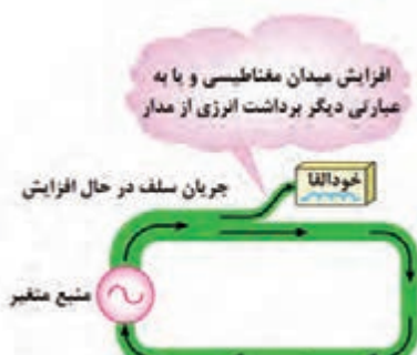
شکل ۲۶ - ذخیره انرژی در سیم پیچ
