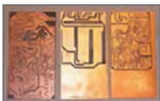
شکل ۱۱۹- انتقال طرح روی فیبر
