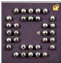
شکل ۲۱- تصویر ظاهری انواع پکیج‌های BGA
