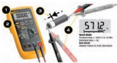
شکل ۳۲- تست دیود ناسالم و اتصال کوتاه
