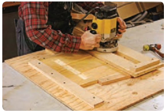
شکل ۳-۲۹ شابلون تسریع کننده و حفاظتی اورفرز
