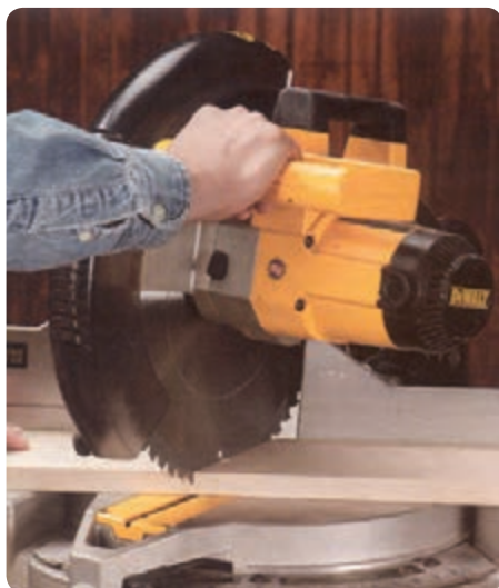
شکل ۲-۵ حرکت اهرمی در اره گرد فارسی بر
