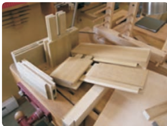
شکل ۴-۱ اتصالات مختلف در صنایع چوب
