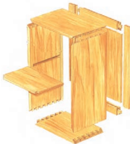
شکل ۶-۱۳۳ پرسپکتیو انفجاری کابینت
