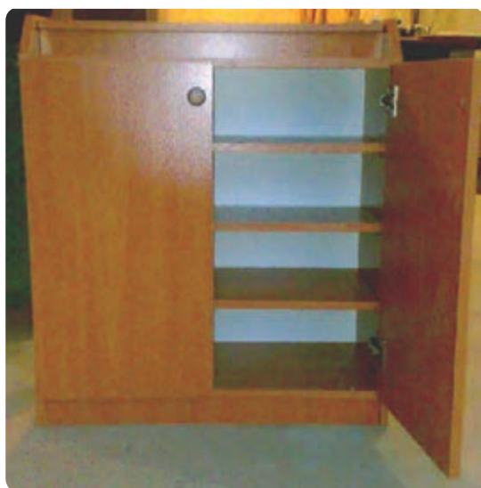
شکل ۶-۱۳۲ نصب پراق آلات در کابینت جاکفشی
