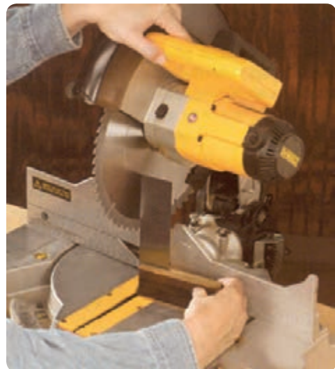
شکل ۷-۲ تنظیم عمود بودن تیغه پشت به صفحه
