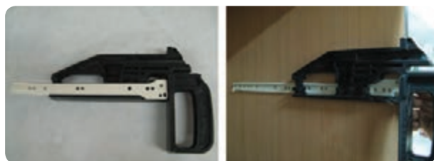
شکل ۲۷-۷ گونبای مخصوص نصب ریل
