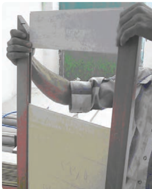
شکل ۶-۹۵ مونتاژ در قابدار با تنگ لته‌ای
