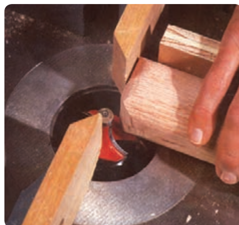
شکل ۲-۶۳ فرز زدن کله چوب با اورفرز دستی برقی
