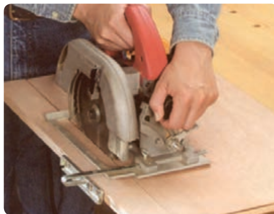
شکل ۲-۲۲ برش عرضی با گونیای ماشین
