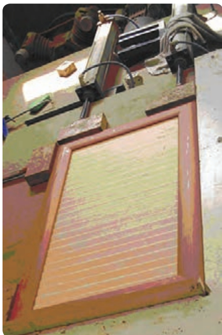
شکل ۶-۹۷ تنگ نیوماتیکی جهت مونتاژ در قابدار کابینت
