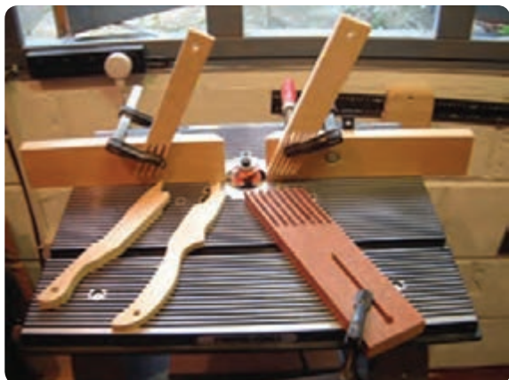
شکل ۳-۲۸ شانه‌های حفاظتی به صورت عمودی
