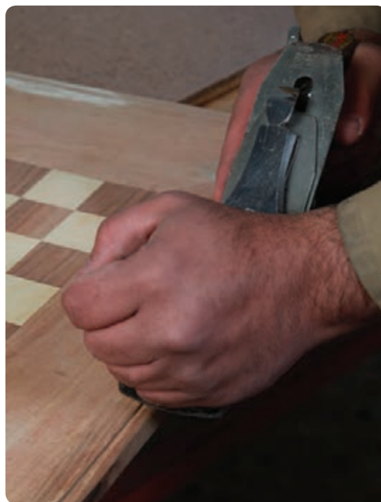
شکل ۶-۷۹ رنده کردن زهوار چوبی
