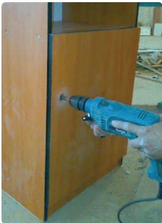
شکل ۱۲۳-۶ در آوردن جای قفل سوئیچی
