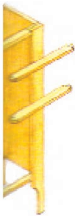
شکل ۶۳-۸ موقعیت قیدهای عرضی داخلی در کابینت پایه‌دار
