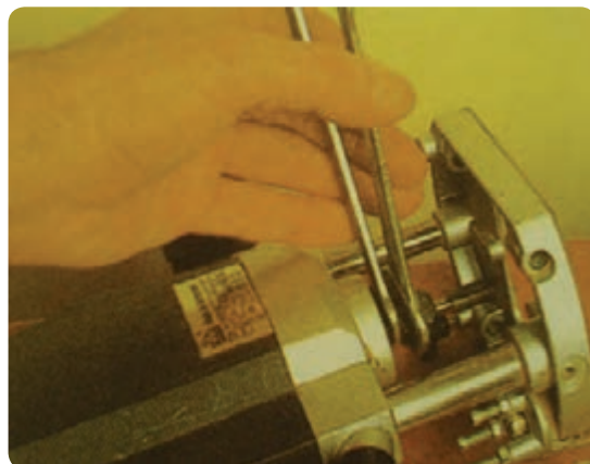
شکل ۴۲-۲ باز و بسته کردن تیغه به کمک دو آچار تخت
