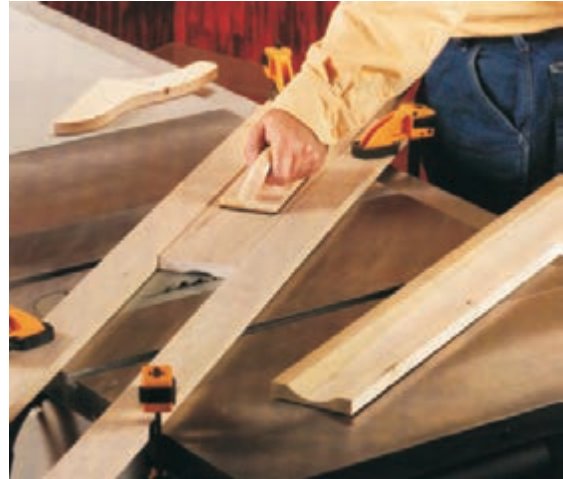
شکل ۱۸-۳ شابلون کمکی برای هدایت قطعه چوب روی اره گرد
