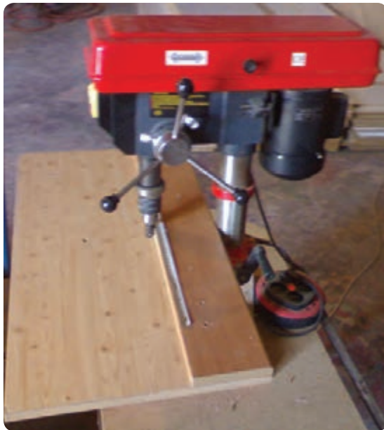
شکل ۶-۷۰- دریل ستونی همراه با شابلن جهت سوراخ‌کاری
