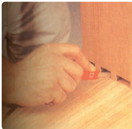
شکل ۶-۱۳۸ خط‌کشی جای فاق روی قطعه دیگر
