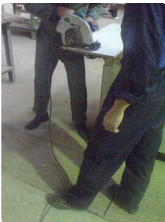
شکل ۲۷-۲ سیم سیار در مسیر نباشد
