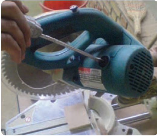
شکل ۲-۱۷ - بازدید زغال کلکتور الکتروموتور در ماشین اره گرد فارسی بر
