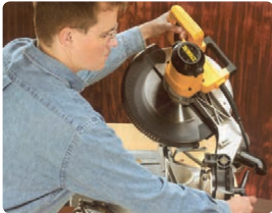
شکل ۹-۲ تنظیم زاویه چرخش اره گرد
