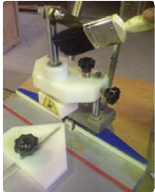
شکل ۱۱۶-۲ تمیز کردن مفصل‌های حرکتی ماشین دم چلچله‌زن
