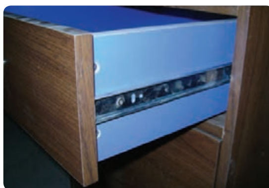
شکل ۶-۵۶ ریل مکانیکی نصب شده در بدنه جعبه
