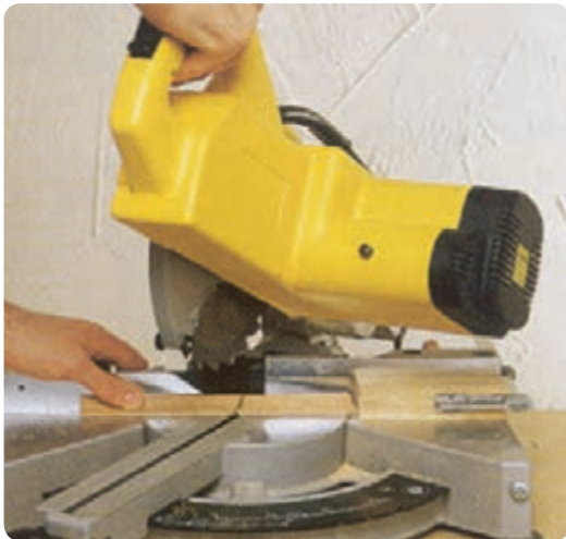
شکل ۲-۱۲- برش قائم با اره گرد فارسی بر
