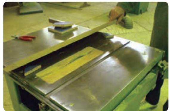
شکل ۳-۳۹ قراردادن دوعدد زیرسری برای ساخت گونیا
