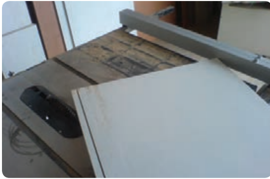
شکل ۶-۶۹- کنشکاف زدن جهت پشت بند
