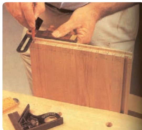
شکل ۶-۱۳۶ خط‌کشی اتصال دم‌چلچله دورو مخفی
