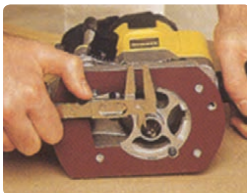
شکل ۶۸-۲ اندازه‌گیری قطر شفت فرز
