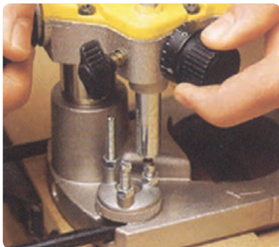
شکل ۷۲-۲ پیچ‌های تنظیم دستگاه
