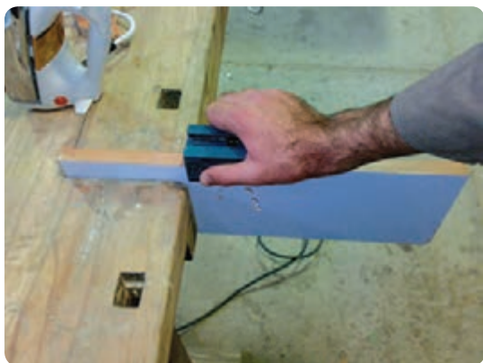
شکل ۱۵۶-۲ رنده پرداخت لبه نوار روکش لبه چسبان
