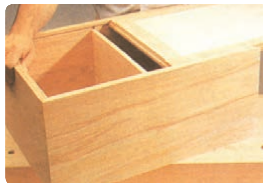
شکل ۱۴۳-۶ قرارگیری پشت بند در کنشکاف بدنه کابینت
