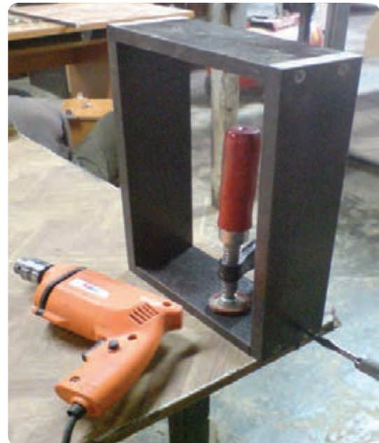
شکل ۶-۱۰۸ مونتاژ دستی جعبه کشو
