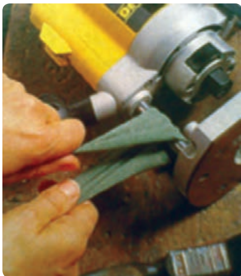
شکل ۲-۶۶ تمیز کردن میله‌های کنسویی اورفرز
