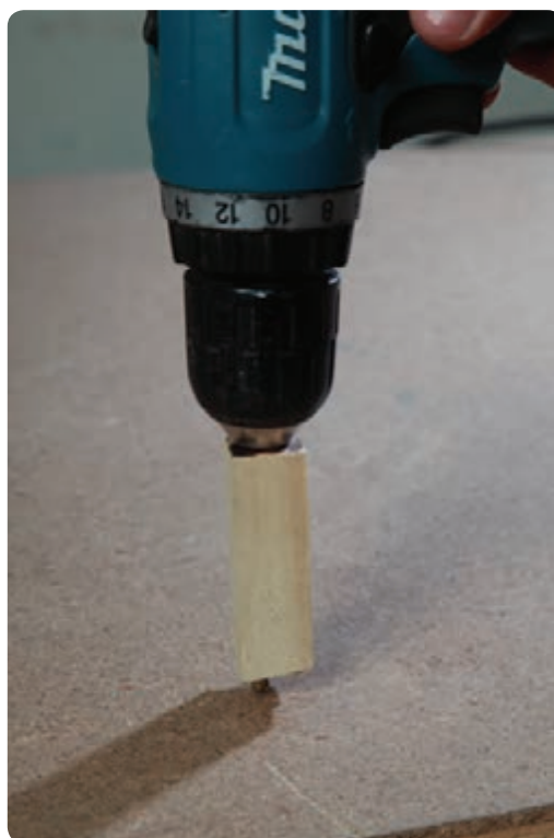
شکل ۳۳۲-۳ سوراخ دریل قطعه کنترل اندازه عمق
