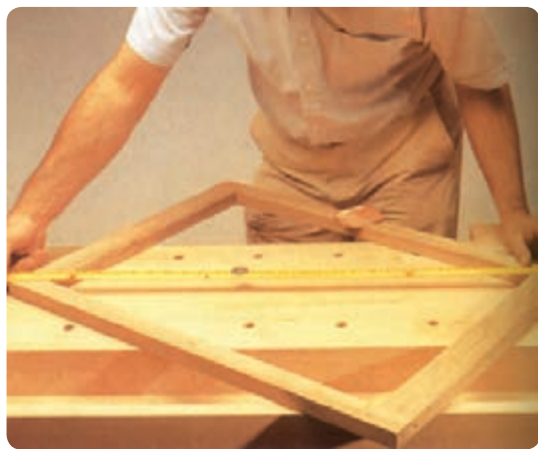
شکل ۱۵۰-۶ اطمینان از گونیی قاب
