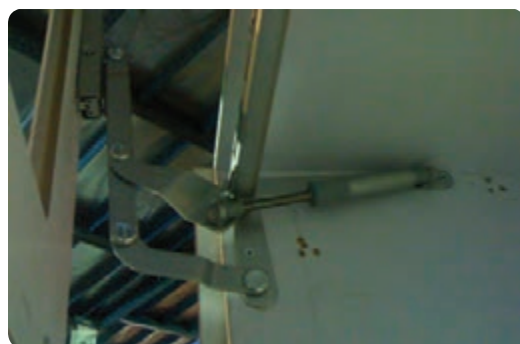
شکل ۶-۳۸ در کابینت نصب شده با جک اتوبوسی
