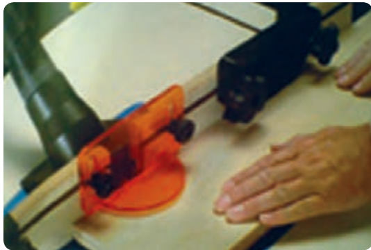
شکل ۲-۷۵ رعایت حفاظت ایمنی در فرزکاری
