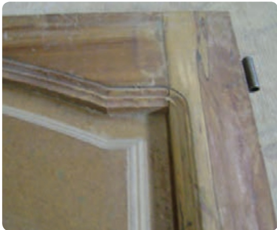
شکل ۶-۸۹ ابزار زدن قاب و تنکه
