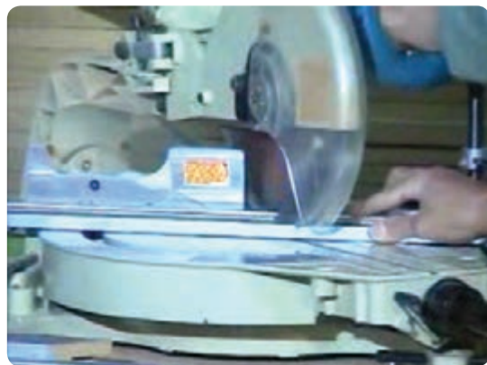
شکل ۶-۹۲ برش پروفیل‌ها با دستگاه فارسی بر
