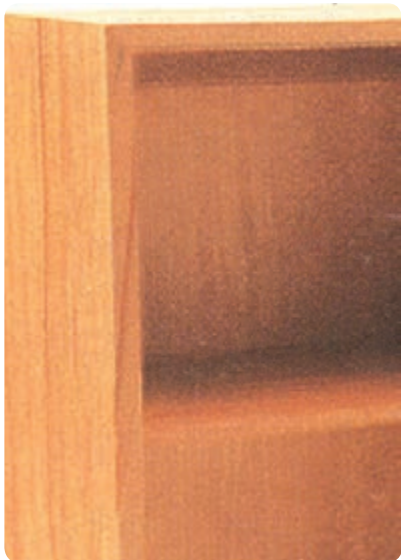
شکل ۶-۷ سقف و کف همرو با بدنه
