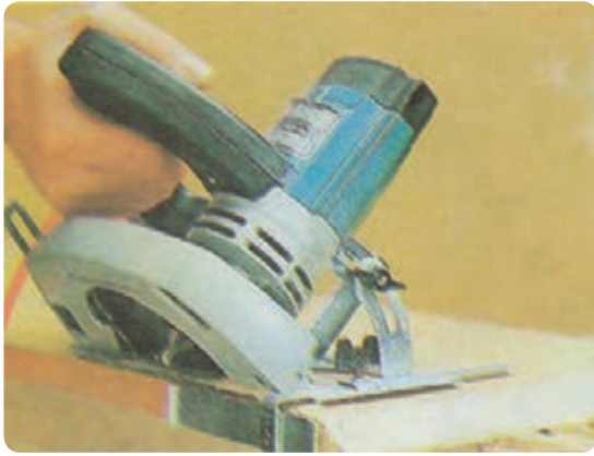
شکل ۳۷-۲ برش تحت زاویه به وسیله گونیای دستگاه
