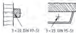
پیچ و میخها، بستها در برش، با خط محور و علائم اختصاری همراه با اندازه نمایش داده می شوند.
