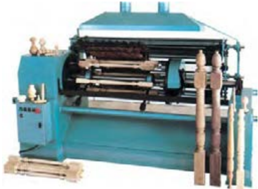
شکل ۱۱-۳ - ماشین فرای تمام اتوماتیک
