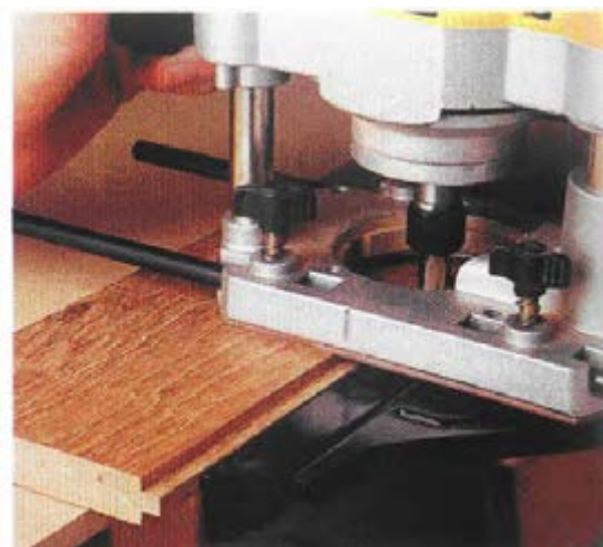
شکل ۱۶-۴. دوراهه زدن، با دستگاه اورفرز.
