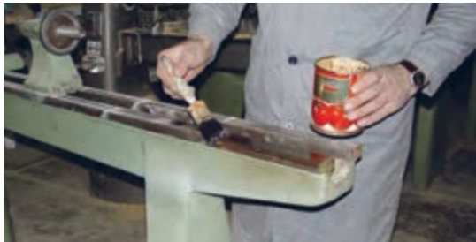
شکل ۱۱-۴۵- تمیزکاری قسمت‌های ضروری و بدون رنگ ماشین.
