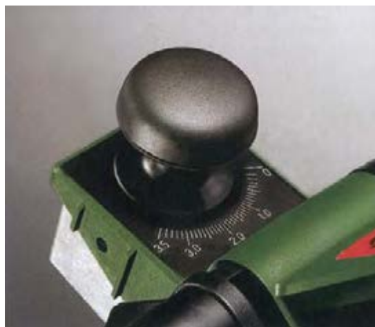
شکل ۴-۱۴. پیچ تنظیم صمفه برای پوشالبرداری
