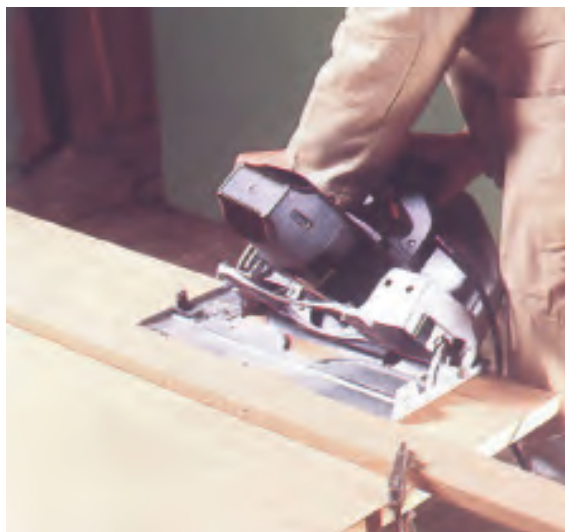
شکل ۱۳-۱۲- صفحه‌ی دستگاه تمت زاویه تنظیم شده است.
