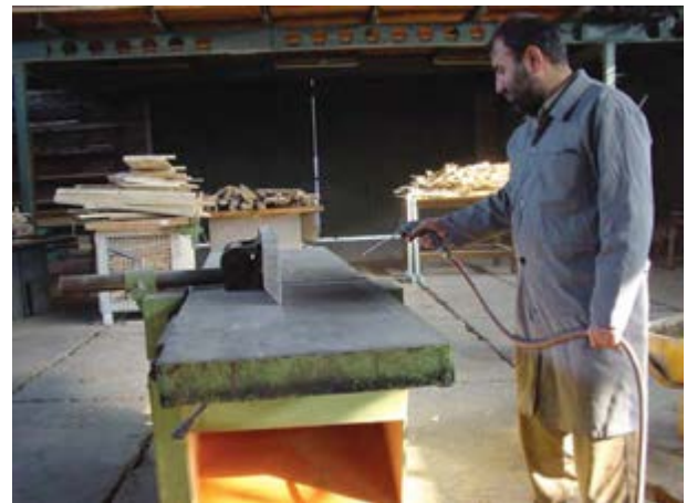
شکل ۱۲-۶- غبارگیری ماشین با شیلنگ باد.
