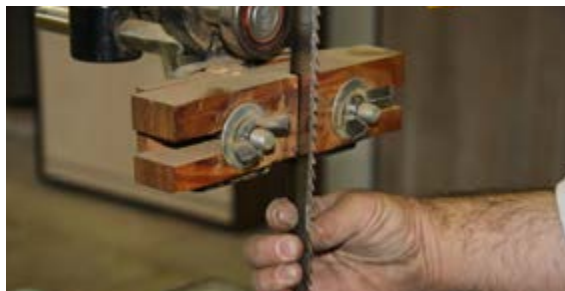
شکل ۳۴-۱- کنترل لازم تیغه قبل از کار.
