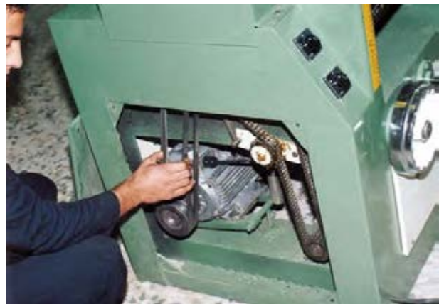
شکل ۸-۸- کنترل مقدار کشش تسمه‌ها.
