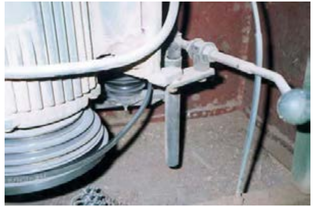
شکل ۱۱-۶- خارج کردن تسمه از پولی.
