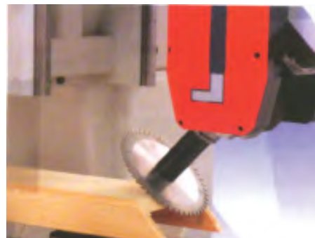
شکل ۳- CNC برش چوب.
