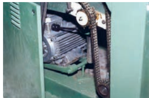
شکل ۷-۱۳ ب - حفاظ تسمه، زنجیر، الکتروموتور و ...
