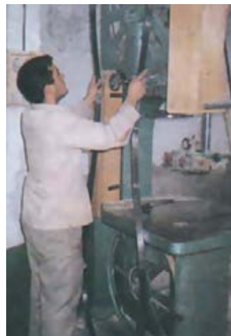
شکل ۱۰-۲- نمونه‌ی خارج کردن تیغه اره.
