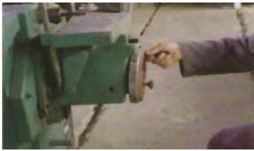
شکل ۱۰-۳- میله و سیستم تنظیم ارتفاع صفحه‌ی متمرک.
