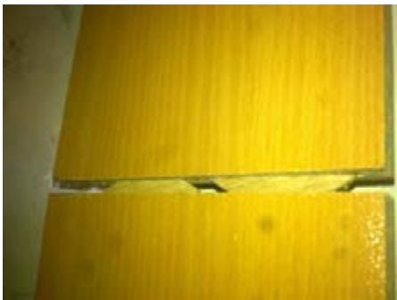
شکل ۱۱-۱۷- اتصال سر به سر؛ با زاویه‌ی صفر گونیا.
