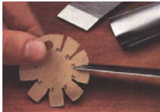
شکل ۴-۵- شابلن مخصوص کنترل زاویه‌ی رنده.
