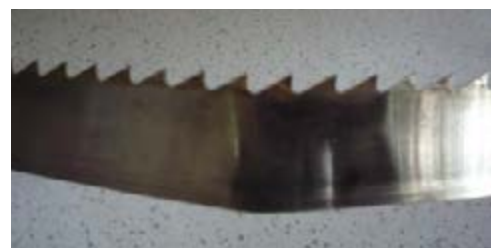
شکل ۶۹-۱- ترک پشت تیغه اره.
