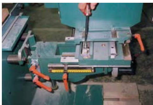
شکل ۱۰-۲۱ - سفت کردن پیچ‌های شل شده.
