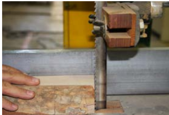
شکل ۳۲-۱- شرایط ایمنی دست، هنگام کار با اره.
