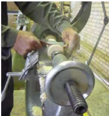
شکل ۱۱-۲۱- نمونه‌ی سنباده‌کاری قطعه چوب فراطی شده.
