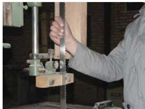
شکل ۵۱-۱- کنترل سفتی تیغه به کمک دست.
