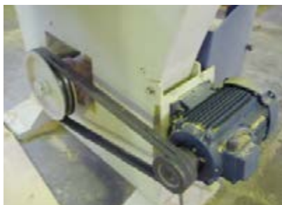
شکل ۳-۴- انتقال نیرو توسط تسمه.
