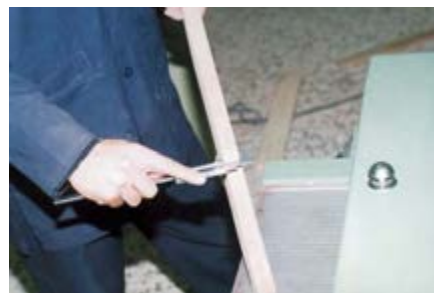
شکل ۴۸-۷- کنترل ضخامت چوب گندگی شده، با کولیس.
