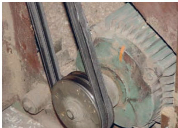
شکل ۱۰-۴- الکتروموتور ماشین کفرنده.
