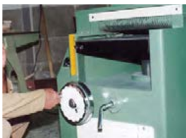
شکل ۲۱-۷- آزمایش (۹۰) بودن حرکت صفحه‌ی متمرک.
