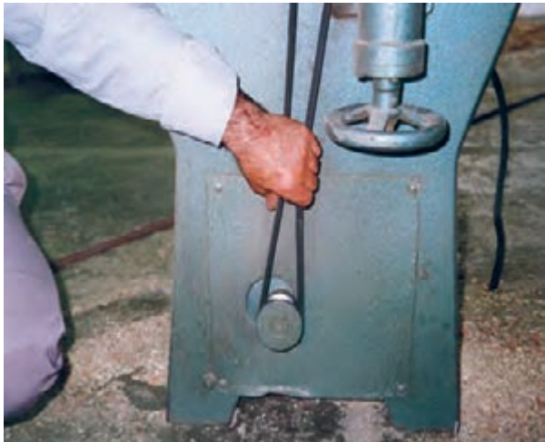
شکل ۱۰-۱۰- کنترل تسمه‌ی ماشین.
