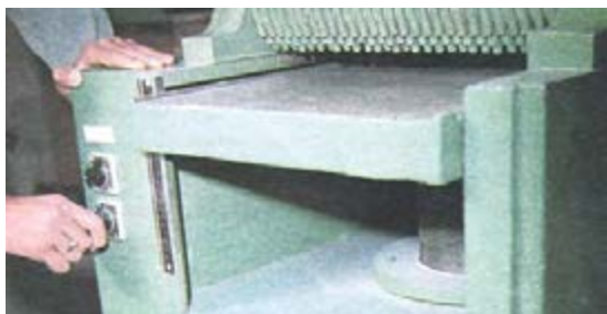
شکل ۷-۳۰- نمونه‌ی ایستادن در هنگام روشن کردن ماشین.
