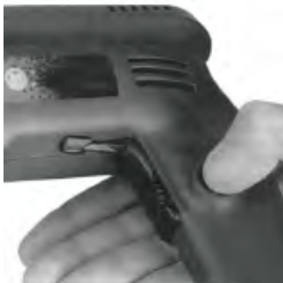
شکل ۱۹-۴۳- (رها کردن کلید و کار دائم دریل).
