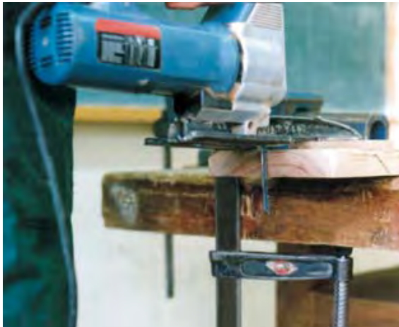
شکل ۱۵-۳۵. صفحه، کاملاً روی چوب قرار نگرفته است.
