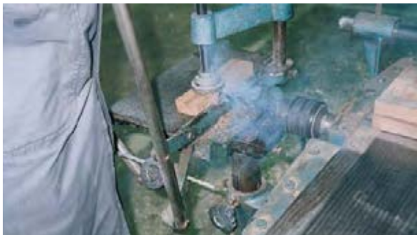
شکل ۹-۲۶- سوهتن چوب به هنگام کم کنی.
