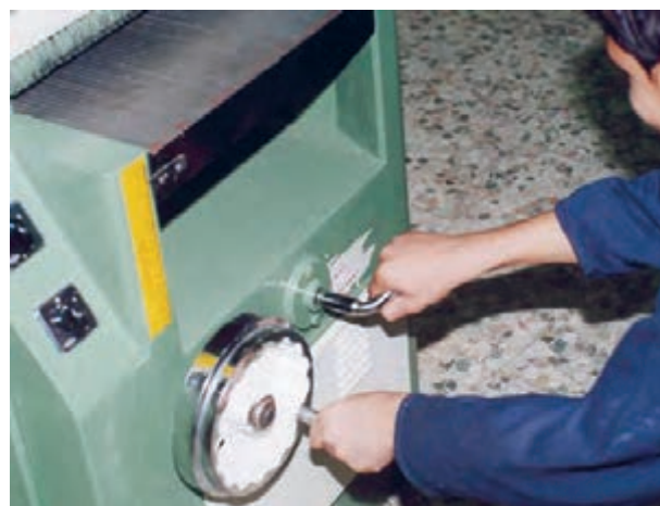
شکل ۱۹-۷- تنظیم صفحه و ممک نمودن اهرم مربوطه.
