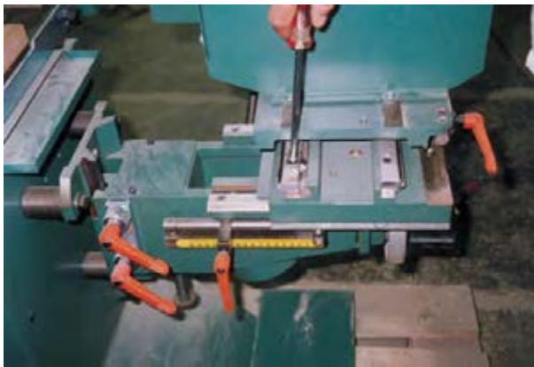
شکل ۱۰-۱۴- کنترل پیچ‌های دستگاه هدایت.
