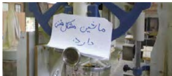
شکل ۱۰-۳. پگه‌نگی نمایش هشدارهای لازم برای کاربران بعدی.
