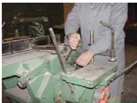
شکل ۹-۱۲- قرار دادن مته در سه نظام.
