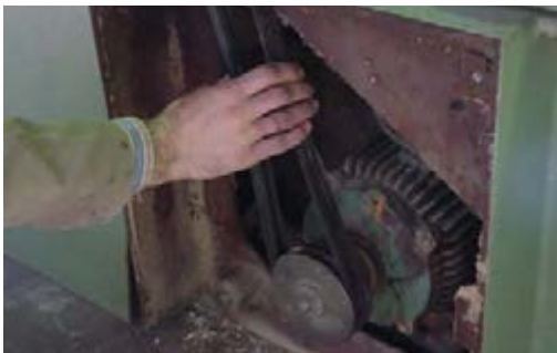
شکل ۶-۶ - کنترل شل و سفتی تسمه.
