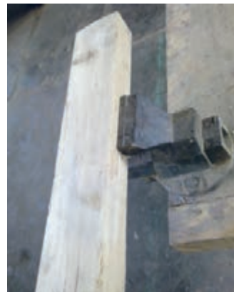
شکل ۲۸-۱۴- بستن قطعه چوب به گیره.
