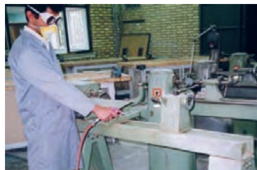
شکل ۱۱-۴۴- گردگیری و نظافت ماشین فراطی.
