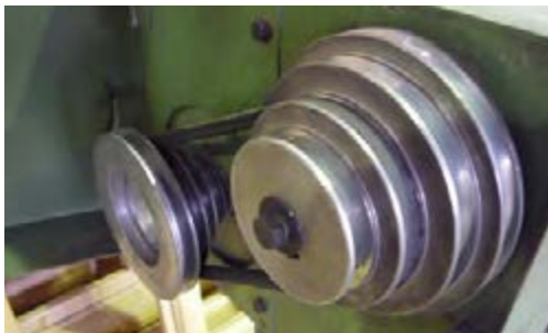
شکل ۱۱-۱۱- انتقال نیرو و تغییر دور توسط پولی پله‌ای.
