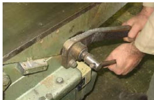
شکل ۱۳-۵- تنظیم مقدار بار.
