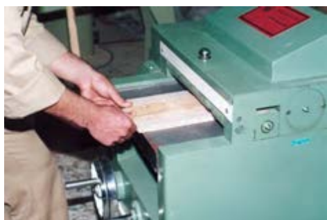
شکل ۳۷-۷- نمونه‌ی زدن چوب نازک.
