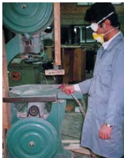
شکل ۱۱-۳. نظافت ماشین پس از کار.
