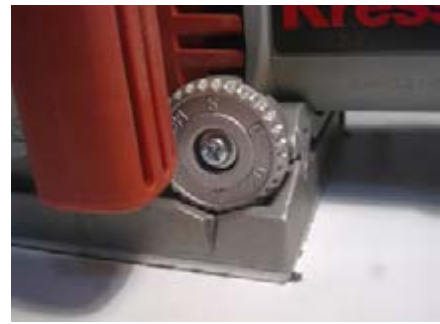
شکل ۱۷-۵- پیچ تنظیم عمق شیار.
