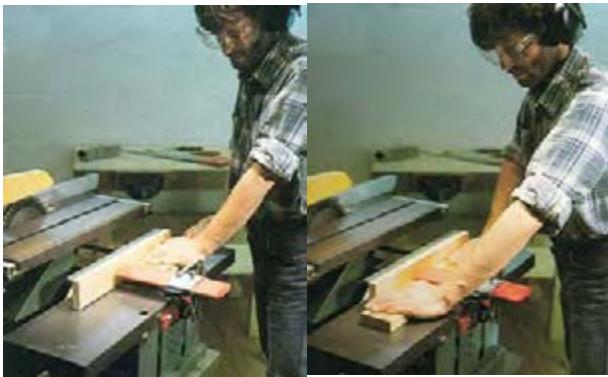
شکل ۱-۴۴-۱- گونیایی کردن چوب قبل از برش.
