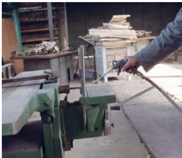
شکل ۱۰-۱۱- غبارگیری قطعات ماشین.
