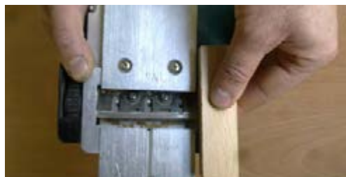
شکل ۱۴-۲۵- استقرار تیغه در شیار.
