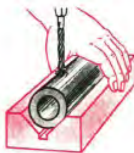
شکل ۱۹-۳۸- سوراخ‌کاری جسم استوانه‌ای.
