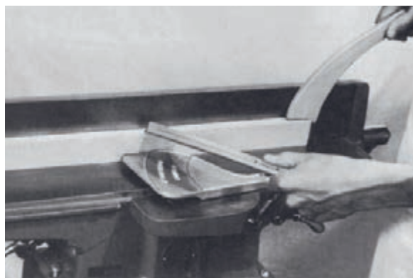
شکل ۱۷-۴ الف - رنده کردن انتهای چوب‌های باریک.
