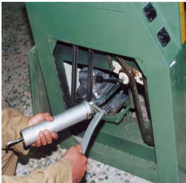
شکل ۸-۷- گریس‌کاری ممبرهای انتقال نیرو.
