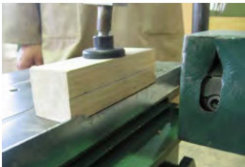
شکل ۹-۱۶- نمونه‌ی قرار دادن چوب (روی صفحه).
