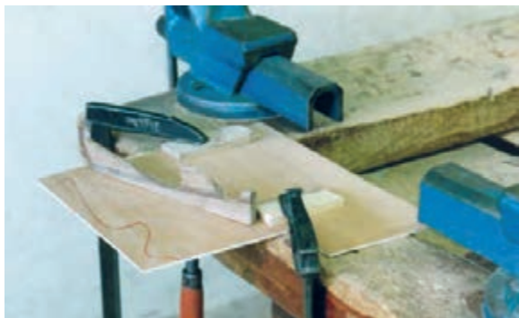
شکل ۱۴۵-۱۵. قطعه کار، با روشی درست و با گیره دستی روی میز محکم می‌شود.
