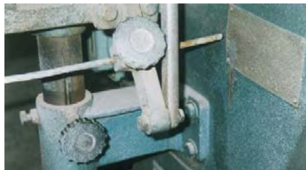
شکل ۹-۸ - سیستم تنظیم عمق کُم.
