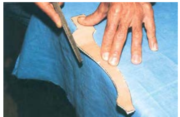
شکل ۲۲- ۱۸. نمونه‌ی پرداخت کردن مسیر برش.
