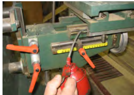
شکل ۱۰-۱- (روغن‌کاری ریل‌ها و کشوهای صفحه‌ی متمرک).
