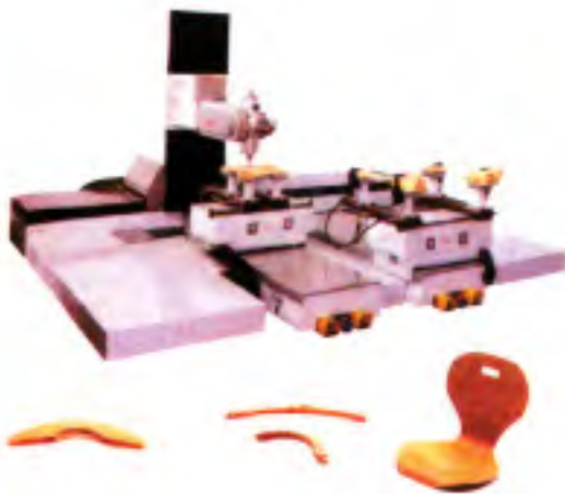
شکل ۱۳- دستگاه C.N.C دستگاه فرز و سوراخکاری مدل چهار محور.
