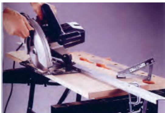
شکل ۱۳-۱۴- برش با استفاده از تکیه‌گاه.
