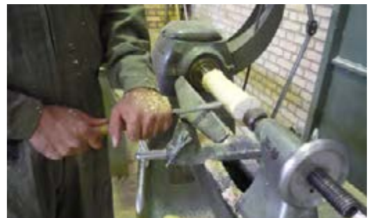
شکل ۱۱-۵۵. نمونه‌ی گرد کردن قطعه چوب پف‌مورده.
