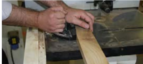
شکل ۱۳-۱- گونیا‌ی متغیر و مدرج، برای برش عرضی.
