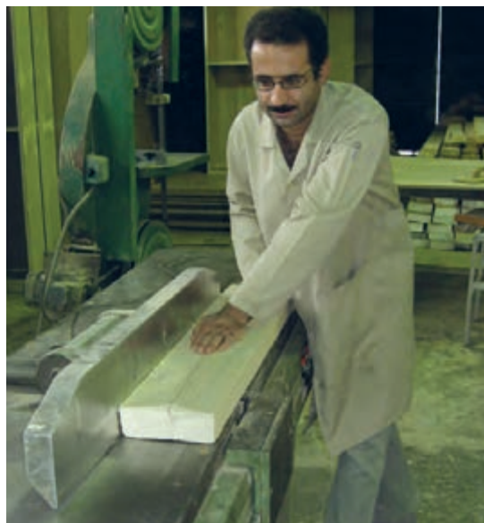
شکل ۱۶-۴ - طرز ایستادن صحیح در کنار ماشین.
