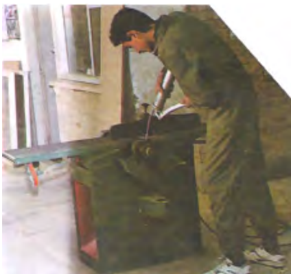
شکل ۱۴-۶- گریس‌کاری یاتاقان‌های توپی رنده.
