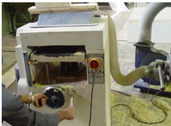
شکل ۷-۴۰- تنظیم دهانه‌ی گندگی.
