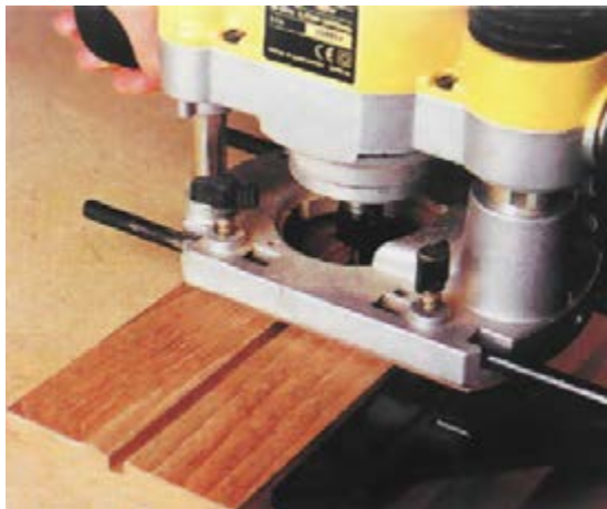
شکل ۱۶-۳. کنشکاف زدن، با دستگاه اور فرز.
