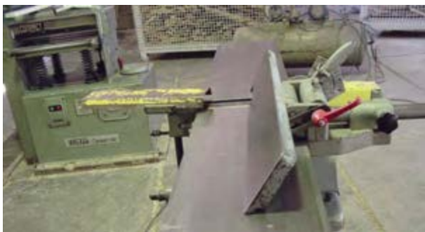
شکل ۳۴-۴- تنظیم زاویه ۴۵ درجه گونیای رنده.
