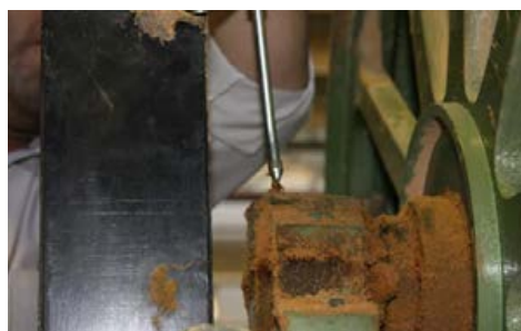
شکل ۳-۱۳- گریس کاری یاتاقان فلکه اره.
