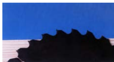
بیرون زدگی تیغه، مناسب است.
