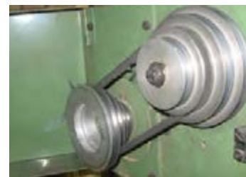
شکل ۶-۱۱- پولی تبدیل دور.
