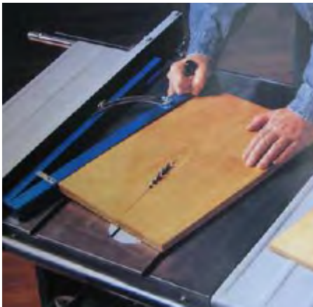
شکل ۱۲-۲۹- برش مورب با ابزار کمکی.
