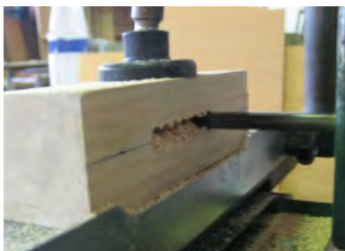
شکل ۹-۳۸ - برداشتن فاصله‌ی دو سوراخ.
