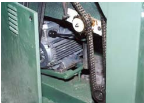
شکل ۸-۱۴- باز کردن درپوش برای روغن‌کاری.
