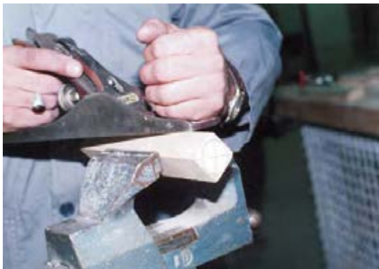
شکل ۱۱-۵۳- مراحل آماده‌سازی چوب برای فرایندی کردن.
