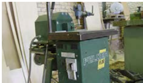
شکل ۹-۹ - گیره، برای ممکم کردن چوب (روی صفحه).
