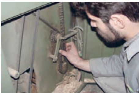
شکل ۲۷-۷- تنظیم و آزمایش سفتی (زنجیر انتقال نیرو).
