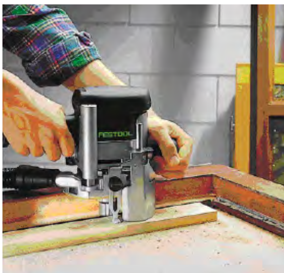
شکل ۱۶-۷- برداشتن قسمت اضافی سه لایی.
