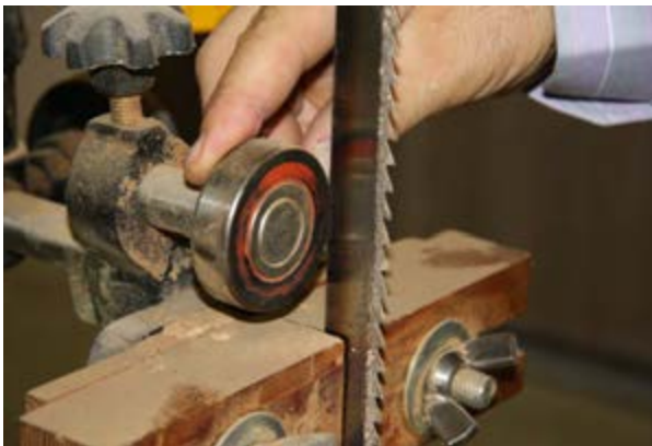
شکل ۳۰-۱- کنترل بلبرینگ پشت تیغه.
