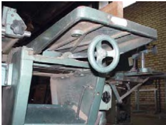
شکل ۳-۶- پیچ فلک‌های تنظیم صفحه را باید با گازوییل شستشو نمود.
