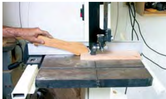
شکل ۵۵- ۱- برش چوب‌های باریک به وسیله‌ی چوب کمکی. توجه کنید که برش به انتها نزدیک شده است.
