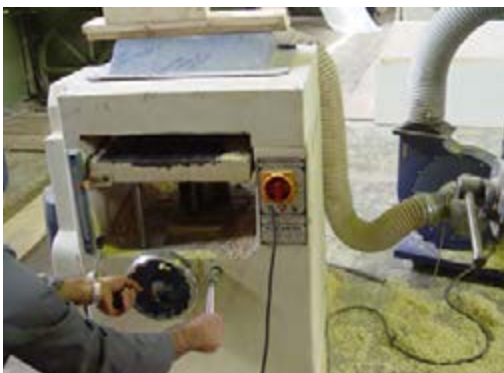
شکل ۷-۴۶- تنظیم بار تیغه به اندازه‌ی مورد نیاز.
