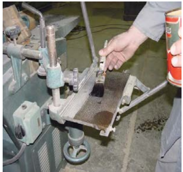
شکل ۱۰-۱۲- چرب کردن صفحات با روغن.
