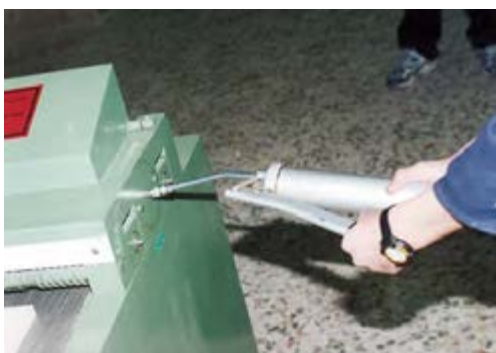
شکل ۸-۱۳- گریس‌کاری یاتاقان‌های ماشین.
