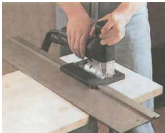
شکل ۲۰-۱۵. برش عرضی چوب به کمک ریل راهنما.
