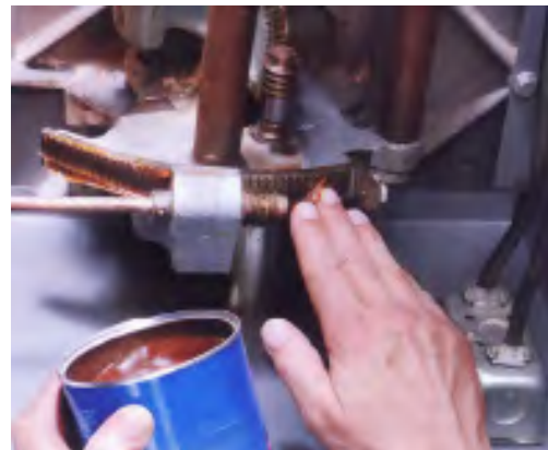
شکل ۱۲-۳۴- گریس‌کاری یرغ دنده‌ها.
