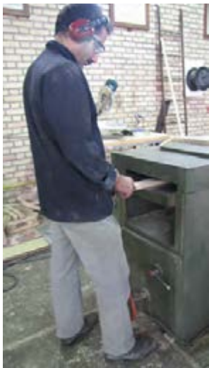
شکل ۷-۳۱- استفاده از گوشه‌ی ایمنی.
