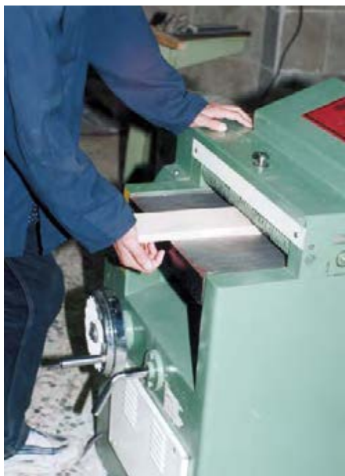
شکل ۷-۴۲- روش ایمنی هدایت چوب به داخل ماشین.
