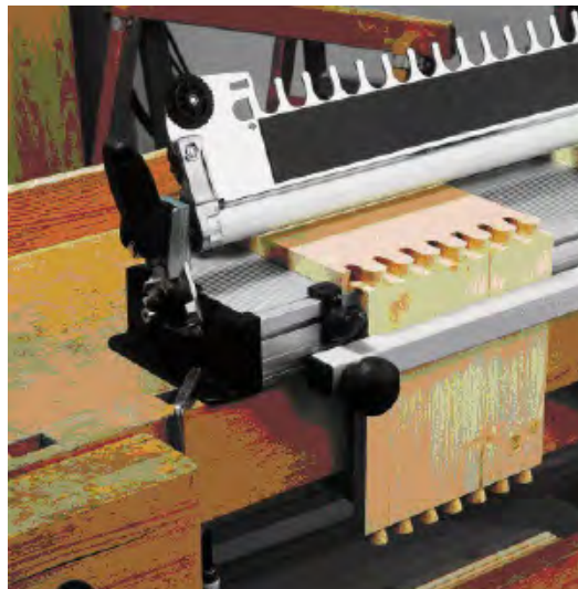
شکل ۱۶-۵- اتصال دم چلچله و انگشتی.
