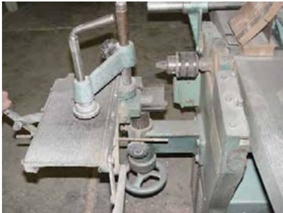
شکل ۹-۲ - ماشین سه‌کاره شامل: کُم‌کنی، رنده و
