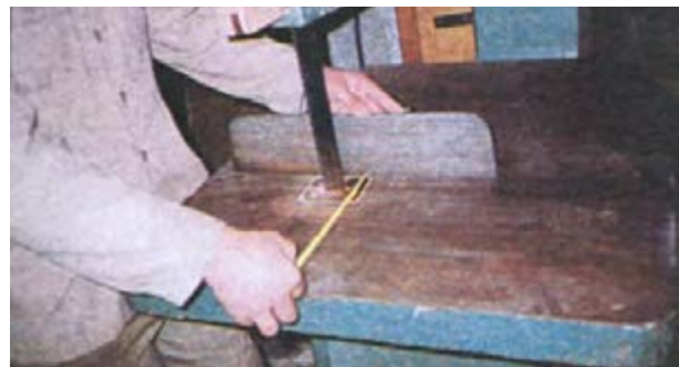
شکل ۱-۴۳-۱- اندازه‌گیری فاصله تیغه با گونیا.
