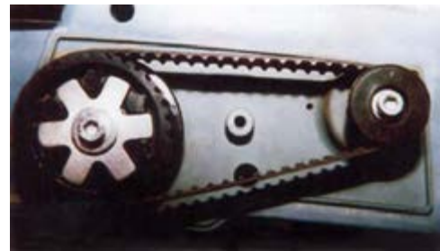
شکل ۹-۱۴- وضعیت قرار گرفتن تسمه روی پیرغ‌دنده.
