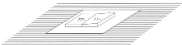
شکل ۱۴-۱۵- کلید تنظیم برق ۱۱۰ به ۲۲۰ ولت و برعکس.
