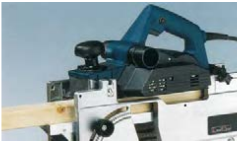
شکل ۱۴-۲۲- گندگی کردن چوب با استفاده از میز کمکی.
