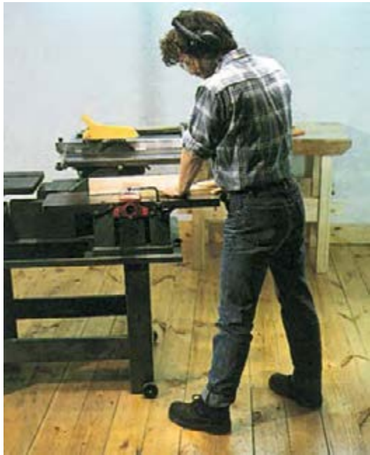
شکل ۳۱-۴. ایستادن صحیح در کنار ماشین.
