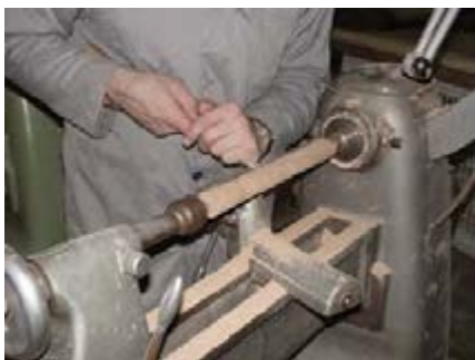
شکل ۱۱-۶۱- گرد کردن کامل قطعه چوب هشت ضلعی.
