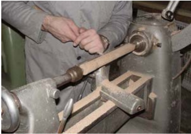
شکل ۱۱-۲۷- نمونه‌ی قرار گرفتن مغار گلوبی هنگام فراطی.
