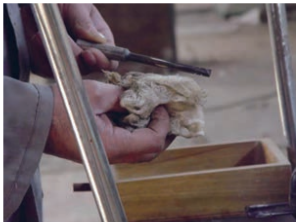
شکل ۱۶-۱۰- تمیز کردن مته‌های خارج شده از ماشین.
