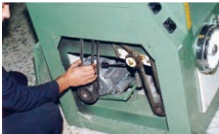
شکل ۲۶-۷- کنترل سفتی تسمه‌ی انتقال نیرو.
