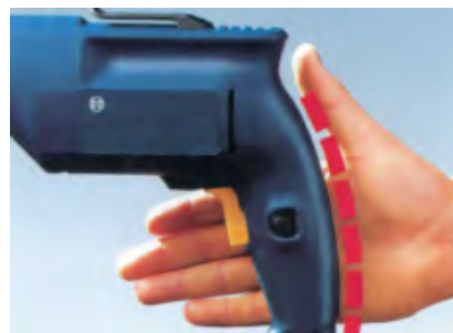
شکل ۱۹-۴۰- دسترسی دکمه‌ی روشن و خاموش دریل.
