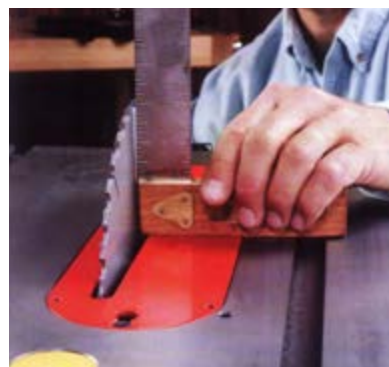
شکل ۱۶-۱۲- کنترل زاویه‌ی تیغه.
