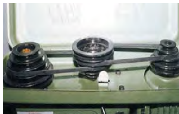
شکل ۱۹-۱۳- تغییر دور پله‌ای در دستگاه دریل ستونی.
