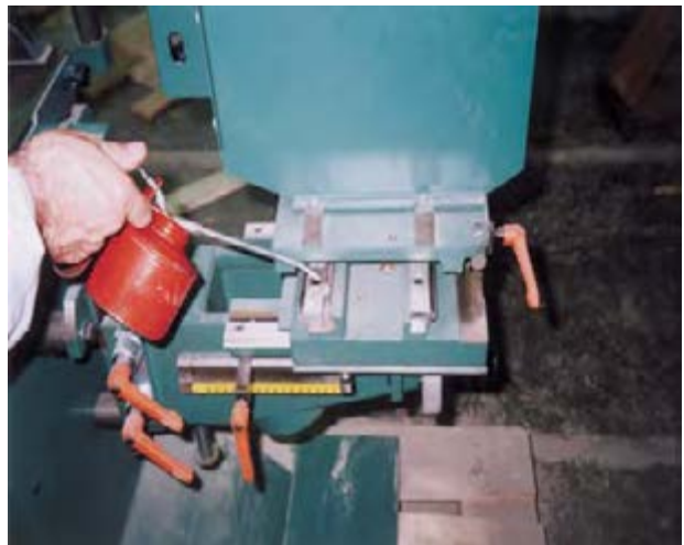
شکل ۱۰-۱۳- (روغن‌کاری) ممل (ریل‌ها).
