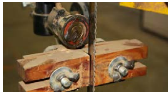
شکل ۳-۲- گریس‌کاری بلبرینگ تیغه اهره.
