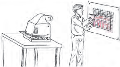
شکل ۱۶-۱۸. استفاده از پروژکتور اوپک برای بزرگنمایی.
