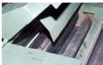
شکل ۲۲-۷- برداشتن درپوش تیغه‌ها.
