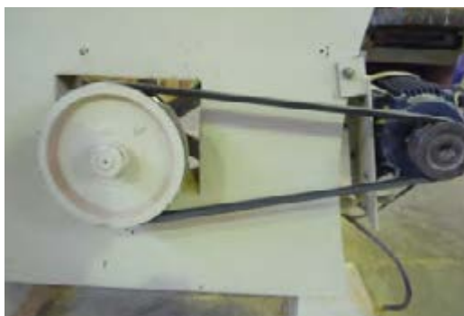
شکل ۳-۱۷- استقرار تسمه در داخل چرخ تسمه.
