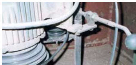
شکل ۳-۱۴- باز کردن درپوش (روی تسمه‌ها).
