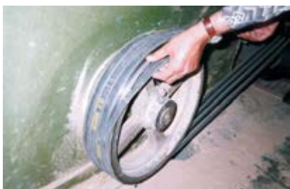
شکل ۹-۳- پیکونگی تعویض تسمه.
