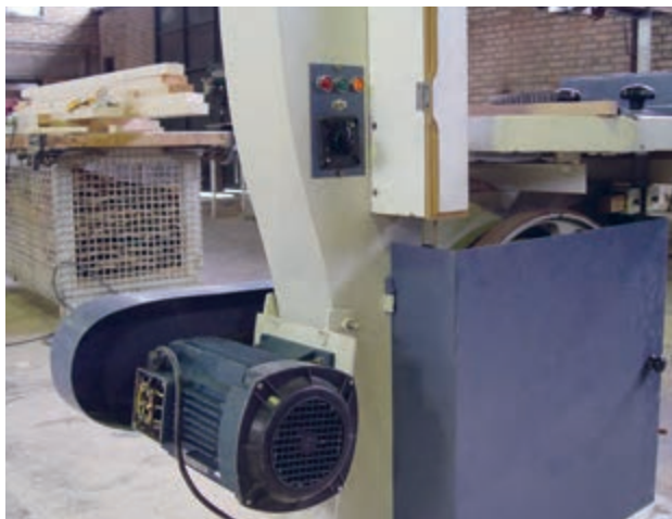
شکل ۲۷- ۱- الکتروموتور تک فاز با هازن راه انداز.
