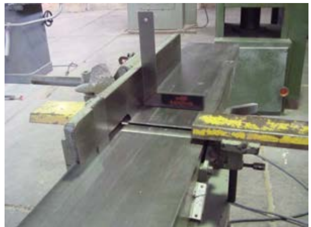
شکل ۳۰-۴. کنترل گونیا ماشین.
