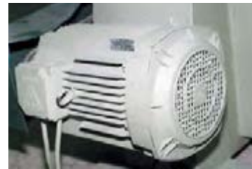
شکل ۵-۱۱- الکتروموتور سه‌فاز یک ماشین خراطی.
