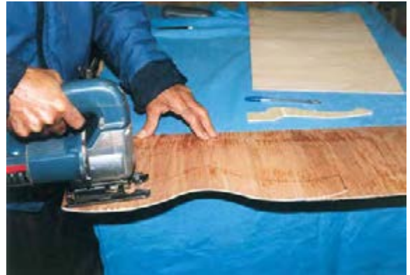
شکل ۲۱- ۱۸. برش تخته سه لایی با توجه به طرح الگو.
