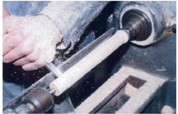
شکل ۱۱-۶۲- یکنواخت کردن چوب.
