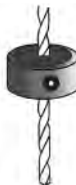
شکل ۱۹-۵۳- قطعه به‌جای میله‌ی عمق سنج.
