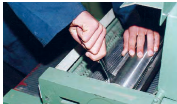
شکل ۲۴-۷- نمونه‌ی بستن تیغه‌ها به توپی.
