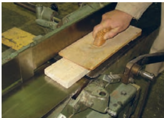
شکل ۱۷-۴ ب - رنده کردن چوب‌های کم ضخامت.
