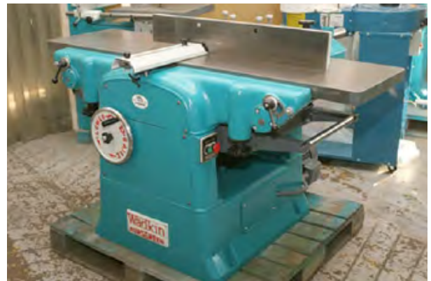
شکل ۴-۴- ماشین کفرند با بدنه چدنی.
