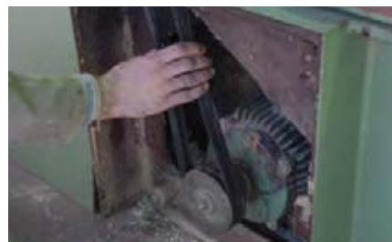
شکل ۲-۶- کنترل سفتی تسمه.
