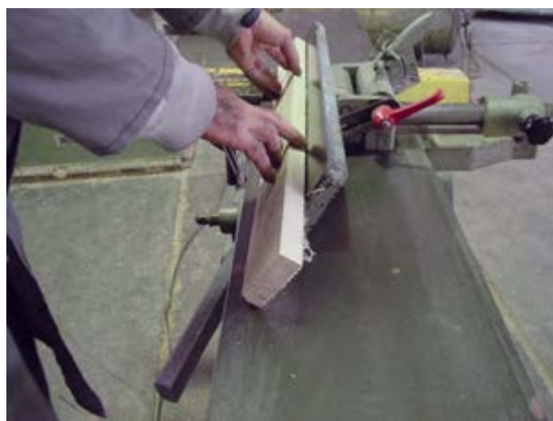
شکل ۴-۳۵. رنده کردن نر چوب با زاویه ۴۵ درجه.
