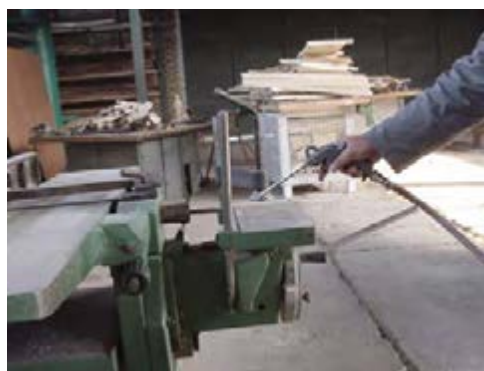
شکل ۱۰-۱۹ - غبارگیری ماشین کُمن کنی.
