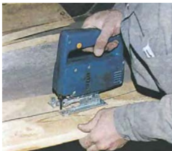
شکل ۱۹-۱۵. برش طولی چوب بدون استفاده از گونیا.
