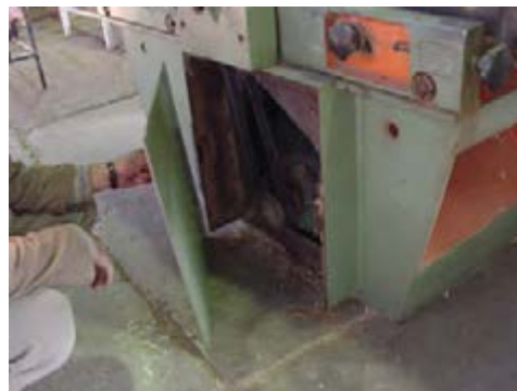
شکل ۹-۶ حفاظ تسمه در جای خود قرار گیرد.
