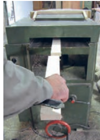
شکل ۷-۳۲- روش صحیح وارد کردن چوب.
