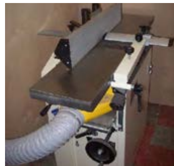
شکل ۴-۲۲ - مکندهی قابل اتصال به ماشین کفرنده.
