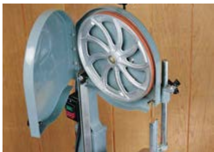
شکل ۴-۲- محافظ باز شده‌ی روی فلکه و تیغه. تیغه از روی فلکه‌ها خارج شود (شکل ۵-۲).
