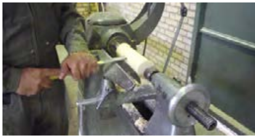
شکل ۱۱-۱۰- تکیه‌گاه کوپک مغار، برای قطعات کوتاه.
