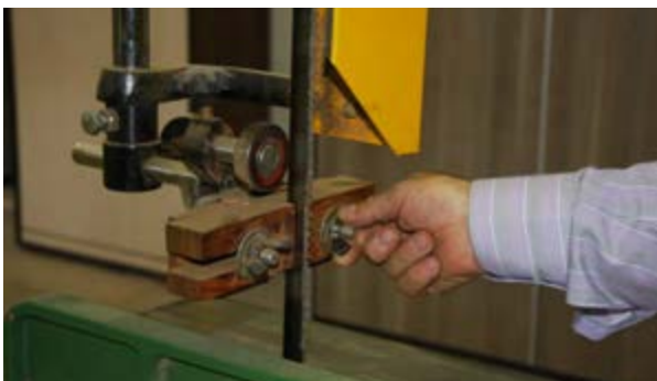
شکل ۳۱-۱- کنترل دستگاه هدایت تیغه در قسمت جانبی تیغه.
