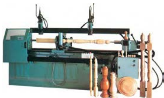
شکل ۱۱-۲ - ماشین فرای نیمه اتوماتیک.
