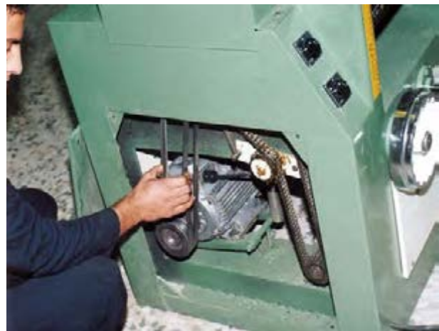
شکل ۸-۱۶- کنترل تسمه‌های انتقال نیرو
