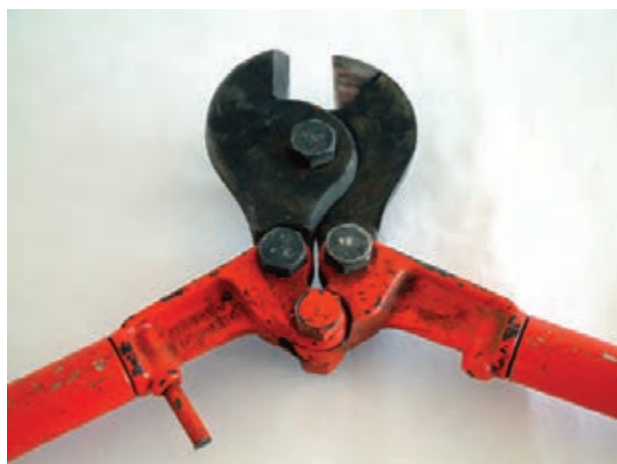
شکل ۵-۷۳- قیچی کابل بری
