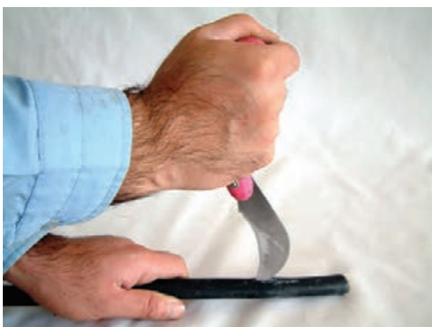
شکل ۳۲-۵ روکش برداری غلط
