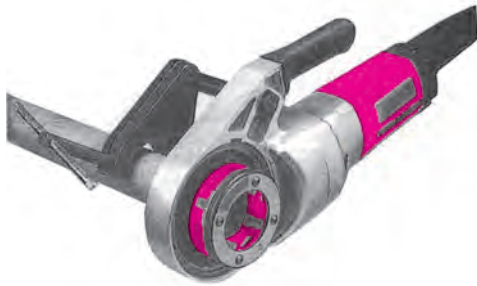
ب - دستگاه حديد هيدروليكي شکل ۱۱-۴ - حديدی لوله فولادی
