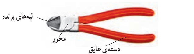
الف - سیم چین معمولی با دسته‌ی عایق
