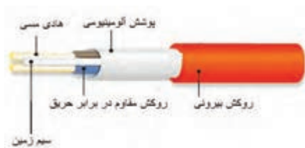
شکل ۱-۲۴ قسمت‌های مختلف یک کابل اعلام حریق
