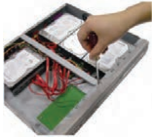
شکل ۳-۶۸ دیسک سخت نصب شده در داخل دستگاه
