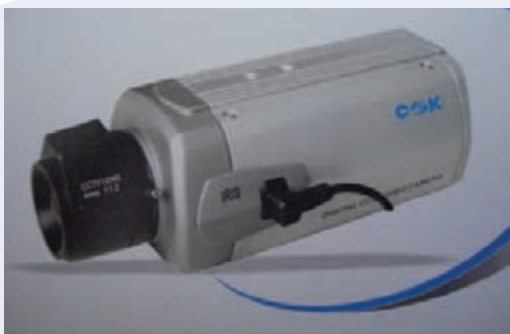
شکل ۳-۲۲ اتصال کابل لنز اتوایریز به دوربین
