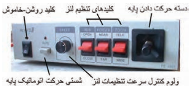
شکل ۳-۵۵ قسمت‌های مختلف جلو کنترل کننده
