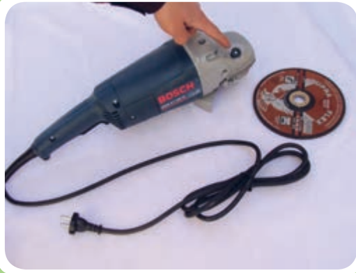
کلید مخصوص قفل کردن محور سنگ
