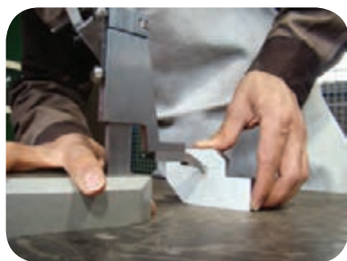
ترسیم خطوط موازی و انتقال اندازه ها بر روی قطعه کار
