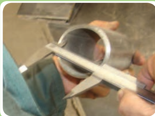
اندازه گیری قطر داخلی لوله توسط کولیس
