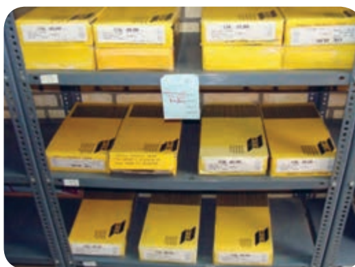
ثبت مشخصات فنی و شرایط نگهداری الکترودها روی جعبه بسته بندی آنها
