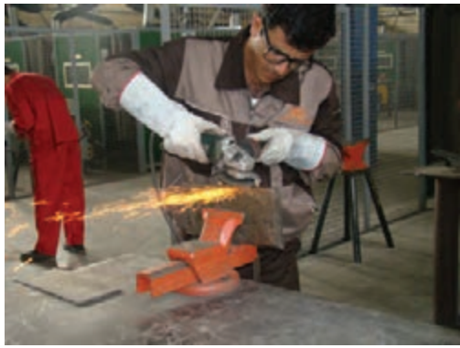
تشخیص نوع فولاد بر اساس آزمایش جرقه
