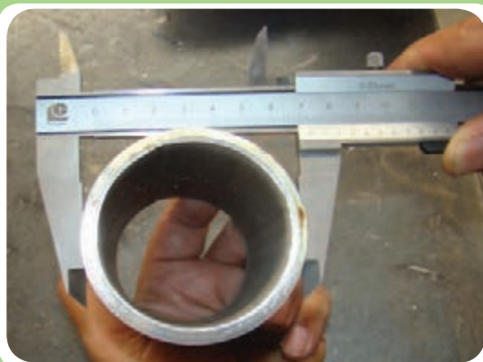
اندازه گیری قطر خارجی لوله توسط کولیس
