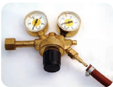
اتصال شیلنگ به رگولاتور گاز
