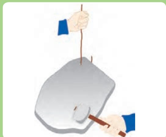
آزمایش ضربه یکی از روش‌های شناخت کارگاهی فلزات است
