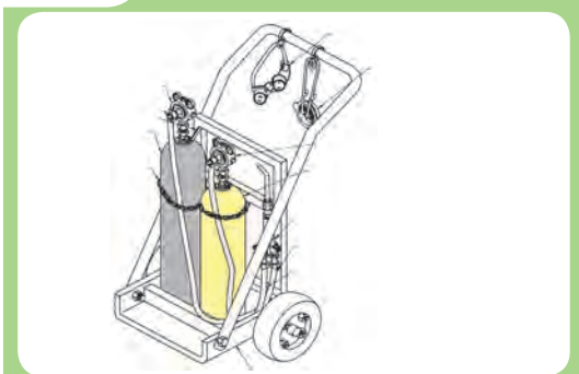
گاری مخصوص حمل کپسول‌های گاز در کارگاه
