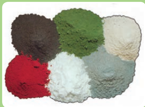
مواد پودری تشکیل دهنده روپوش الکتروود
