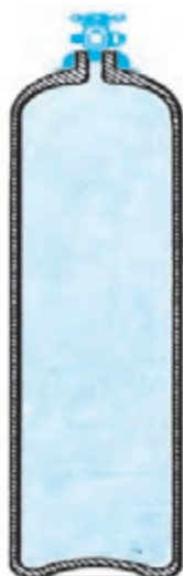
کپسول فولادی مخصوص برای ذخیره اکسیژن
