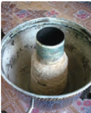
شکل ۸- تشکیل رسوب در سماور و لوله‌ها
