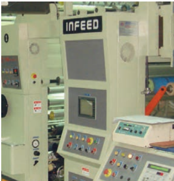
شکل ۴۴- واحد کنترل مجموعه غلتک‌های تنظیم کشش
