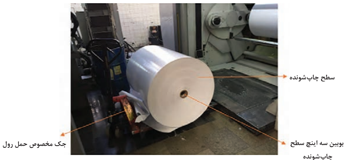
شکل ۳۳- انتقال سطح چاپ شونده به واحد تغذیه
