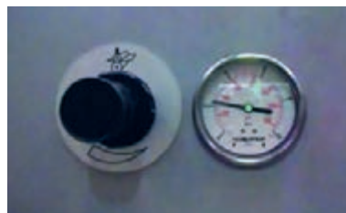
شکل ۵۴- دستگیره تنظیم فشار و گیج آن
