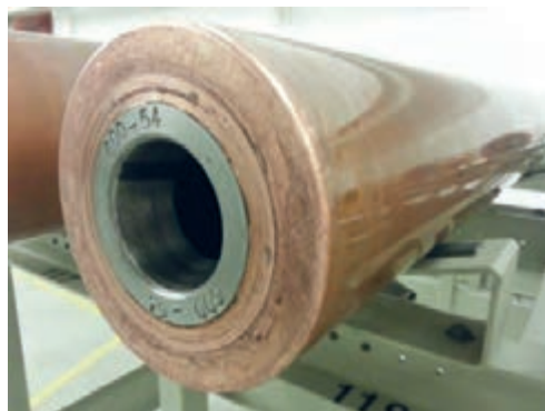
شکل ۴- بوش نصب شده بر روی سیلندر
