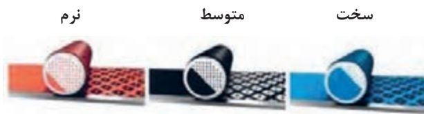
شکل ۱۱- شماتیک فشردگی ذرات فوم چسب پایه
