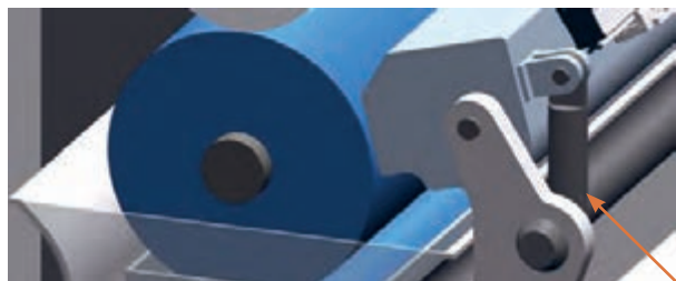
شکل ۸۶- جک تنظیم فشار داکتر بلید
