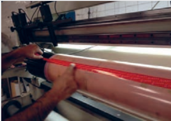
شکل ۲۸- نحوه چسباندن چسب لبه کلیشه
