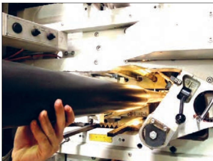
شکل ۳۲- قرار دادن آداپتور بر روی شفت
