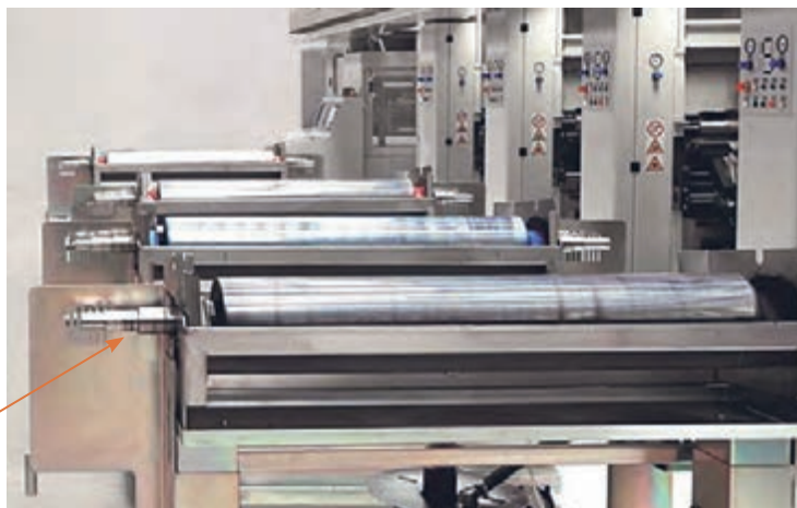
شکل ۴۴- واگن سیلندر جهت نصب در ماشین چاپ
