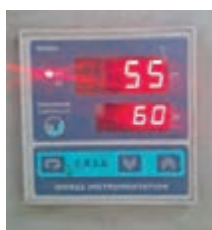
شکل ۱۴- نشانگر و تنظیم کننده دما
