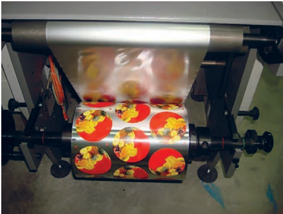
شکل ۵- سطح چاپ شونده فلزی در حال عملیات تکمیلی «پانچ»
