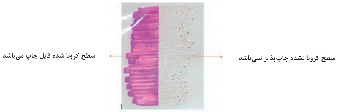
شکل ۲۳- نمونه دیگری از تست کرونا
