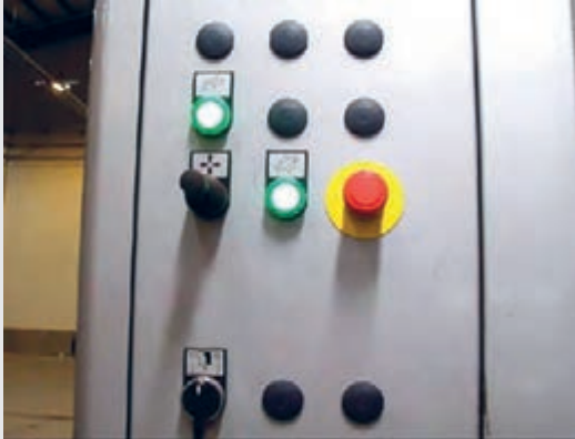
شکل ۴۹- کلیدهای رجیستر به وسیله سرور و رجیستر طولی و عرضی سیلندر
