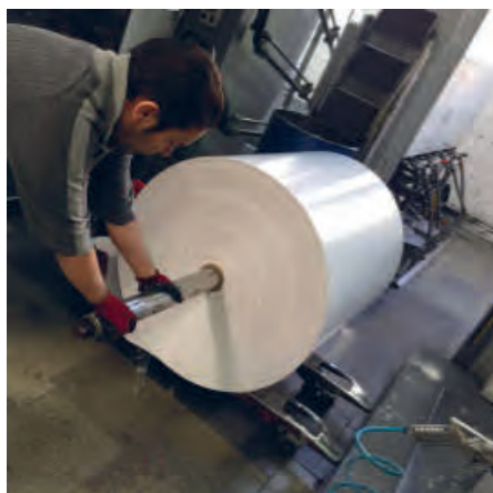
شکل ۳۴- قرار دادن شفت بادی درون بوبین دستگاه
