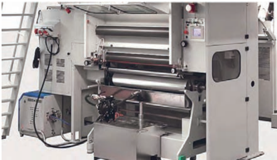
شکل ۴۰- کنترل اتوماتیک گرانیوی مرکب
