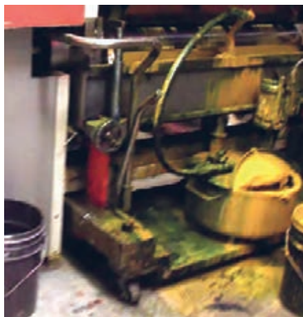
شکل ۴۸- سر ریز شدن مرکب
