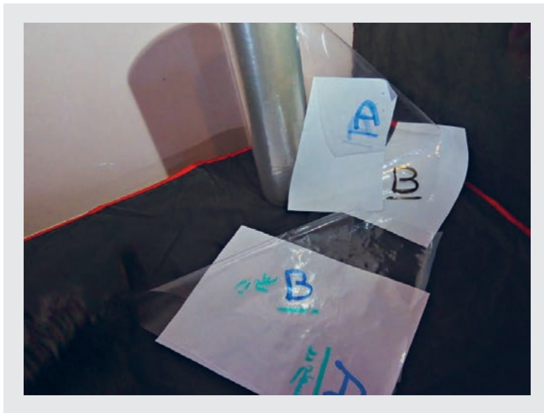
شکل ۲۵- مشخص کردن سطح فیلم با حروف
