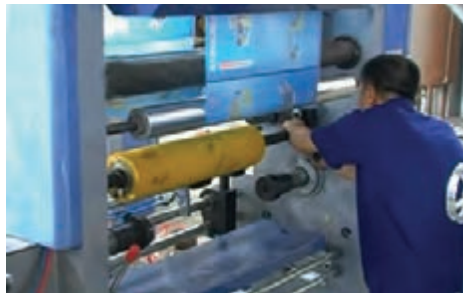
شکل ۶۴- نصب پرس رول سمت اپراتور
