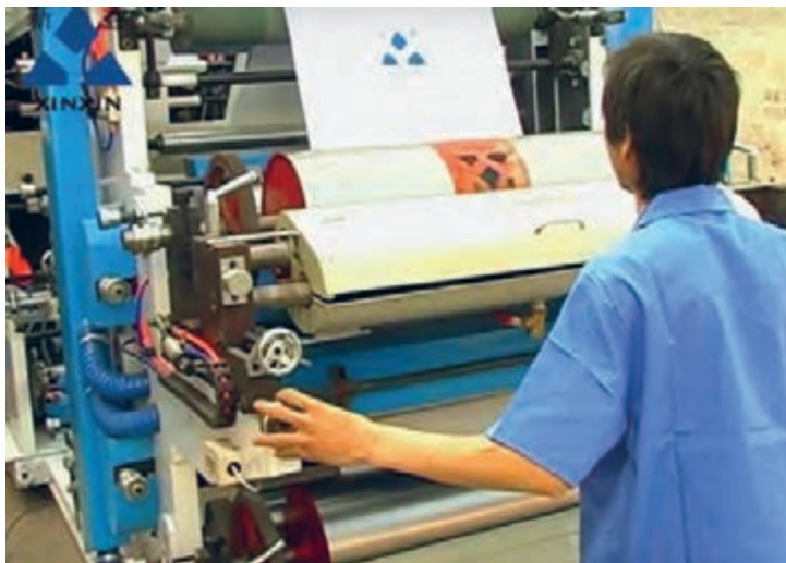
شکل ۲- تنظیم فشار پلیت و سیلندر چاپ
