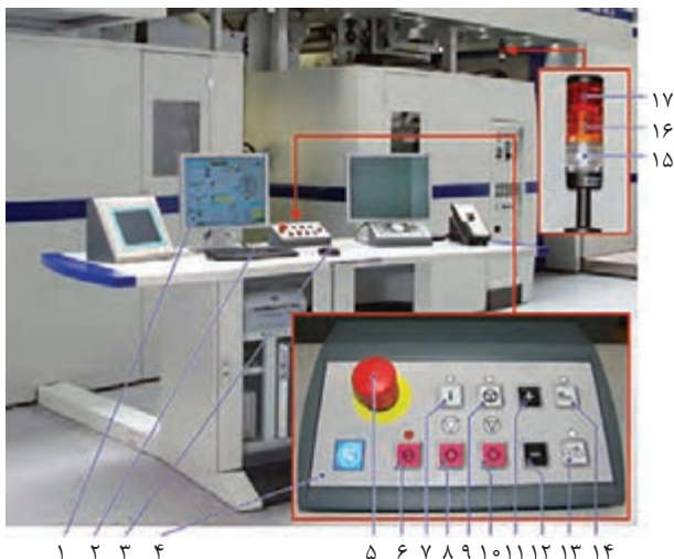
شکل ۶۳- مهم ترین اجزای میز کنترل ماشین
