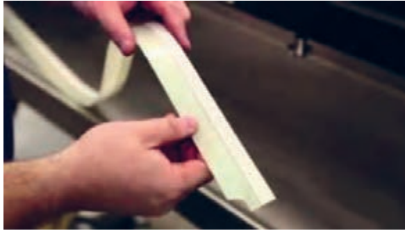
شکل ۷۵- آزمایش لبه تیغه
