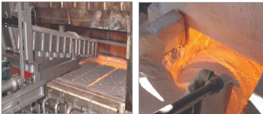
شکل ۲۳- ریختن آمیز به درون کوره
