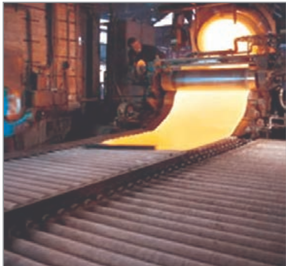
شکل ۲۰- فرایند ساخت شیشه تخت
