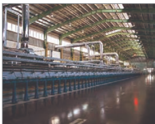
شکل ۳۰- گرمخانه تنش زدایی شیشه
