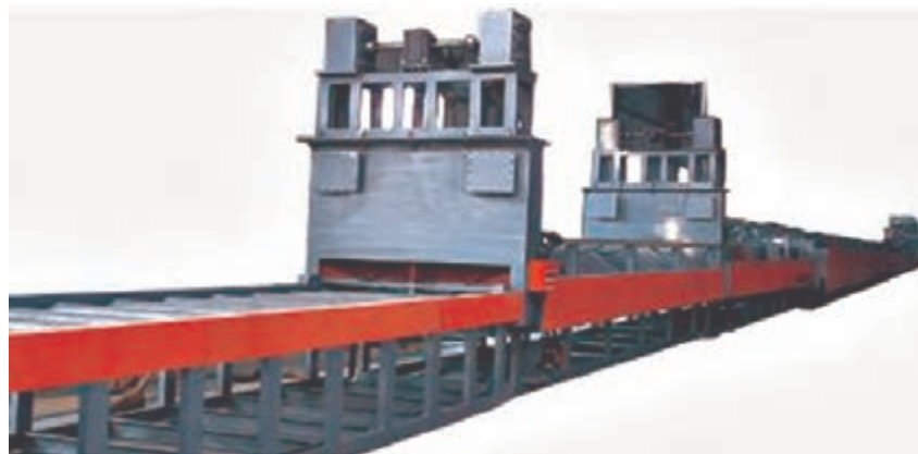
شکل ۱۲- کوره رولری برای عملیات تمپر حرارتی
