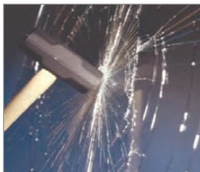
شکل ۹- شکسته شدن شیشه تنش‌زدایی شده در اثر ضربه
