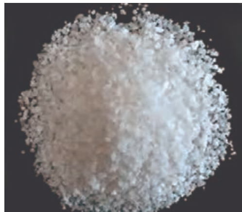
شکل ۲۷- الف) سیلیس دانه درشت ب) سیلیس دانه ریز
