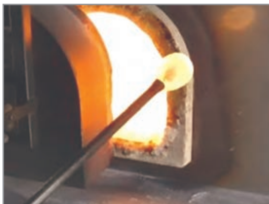
شکل ۹- برداشت بار از حوضچه بارگیر
