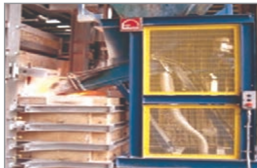
شکل ۱۶- دریچه بارریز کوره‌های شیشه ظروف و بطری
