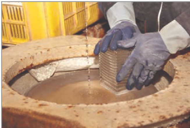
شکل ۲۷- حذف لبه‌های تیز بدنه شیشه‌ای با دستگاه سایش و پرداخت
