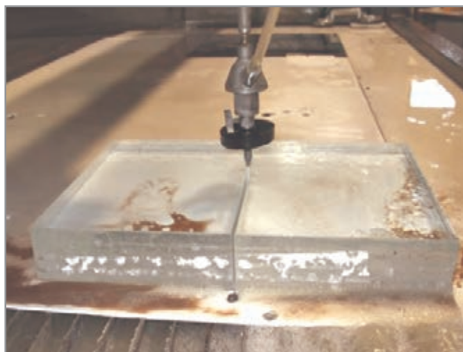
شکل ۳۱- برش شیشه با واترجت
