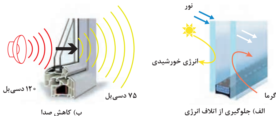
شکل ۴۲- عایق حرارتی و صوتی شیشهٔ دو جداره
