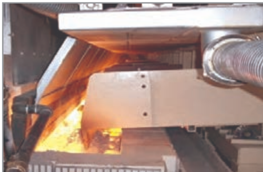
شکل ۱۷- دریچه بارریز کوره‌های شیشه تخت
