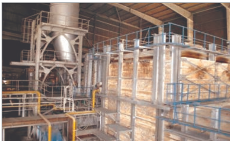
شکل ۳۶- کوره و سیلوی خوراک دهنده
