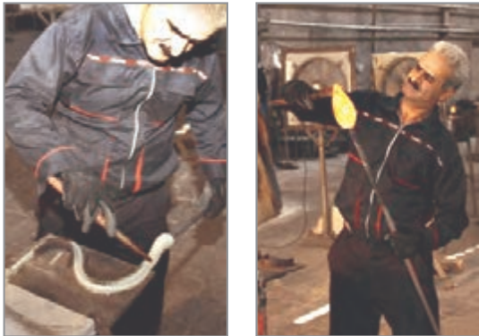
شکل ۷- شکل‌دهی گوی با کمک ابزار
