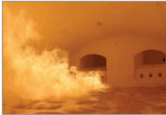
الف) مخزن ذوب کوره ریجنراتوری پشت گذر
