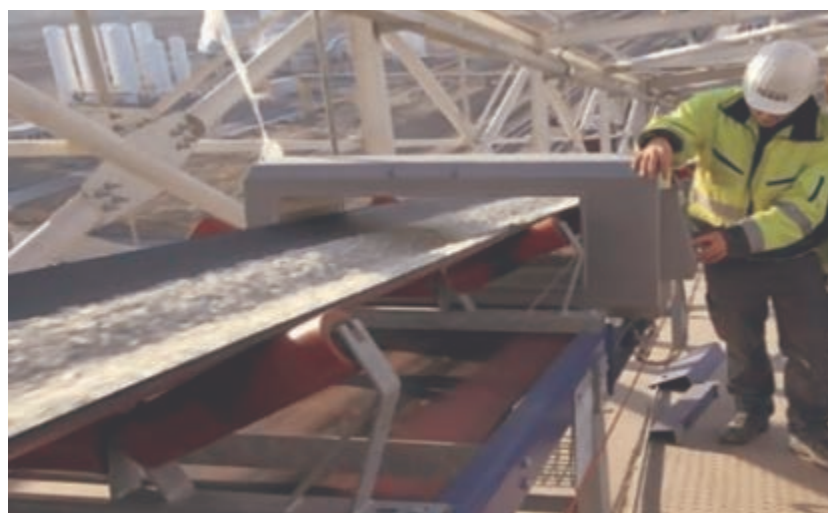
شکل ۳۱- فرایند آهن‌گیری هنگام انتقال مواد پودر شده
