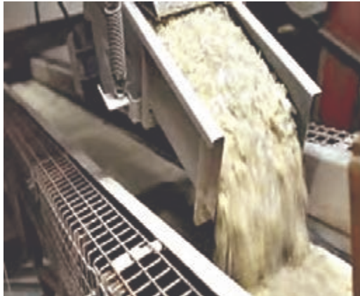
شکل ۲۶- خردایش و آهن‌گیری مواد اولیه
