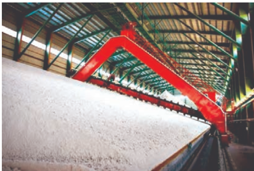
شکل ۳۰- سیلوی سقف دار و برداشت برشی مواد
