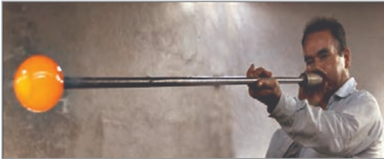
شکل ۵- ایجاد حباب در لقمه مذاب با دمیدن
