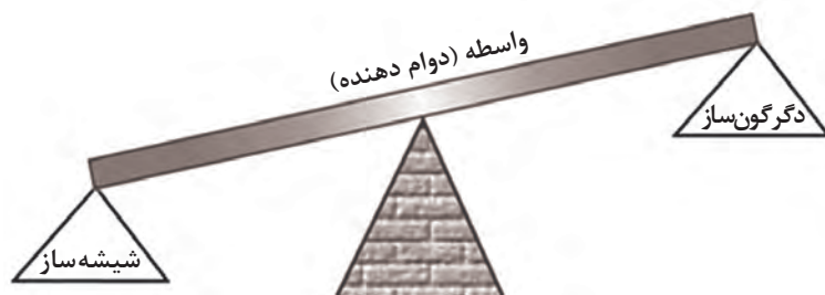
شکل ۱۳- کنترل خواص شیشه با افزودن مواد واسطه
