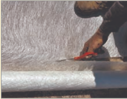
(ب) پارچه تولید شده از الیاف شیشه
