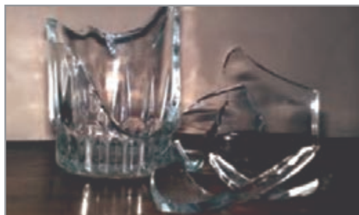
شکل ۸- شکستن شیشه سرد با ریختن مایع داغ
