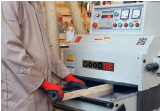
شکل ۷۸- نحوه گندگی کردن چوب‌های کم عرض
