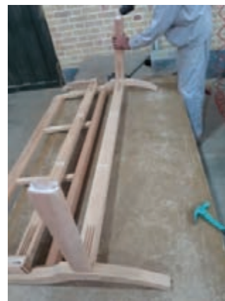
شکل ۵۴- مونتاژ مجموعه پشتی مبل با جلو مبل توسط قیدهای بغل
