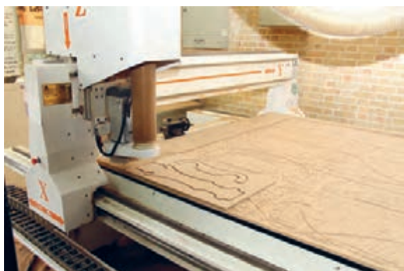
شکل ۶۷- تهیه شابلون با دستگاه فرز CNC
