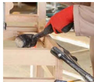
شکل ۱۰۷- جا زدن نبشی به وسیله چکش پلاستیکی
