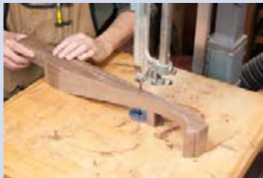
شکل ۴۹- قوس‌بری چوب: مرحله دوم
