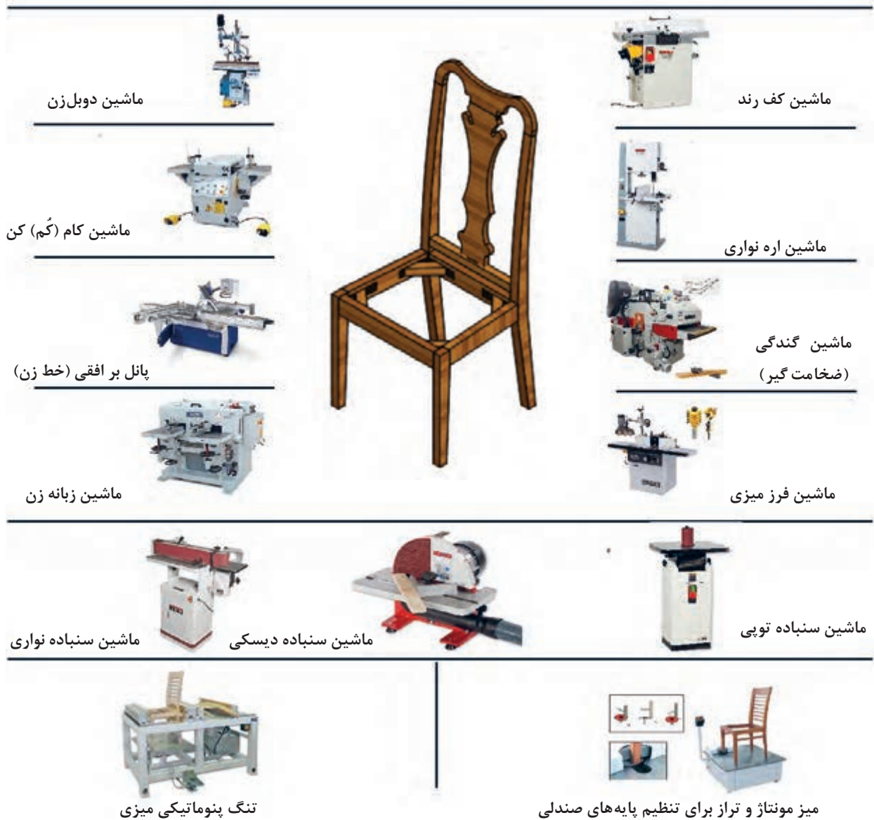
شکل ۲۵- ماشین آلات مورد استفاده در ساخت پروژه
