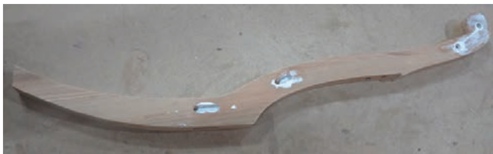
شکل ۴۶- روش چسب زدن اتصال دوبل پایه‌های عقب
