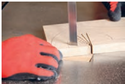
شکل ۸۱- عمل قوس‌بری (الف) به روش برش مستقیم از خارج کار (ب) به روش قوس‌بری از گوشه مماس بر دایره
