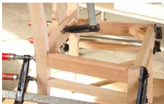
شکل ۱۱۰- نصب نبشی ها
