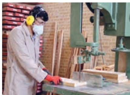
شکل ۷۶- نحوه برش کاری صحیح، چوب و وضعیت استقرار دست‌ها هنگام برش کاری مستقیم
