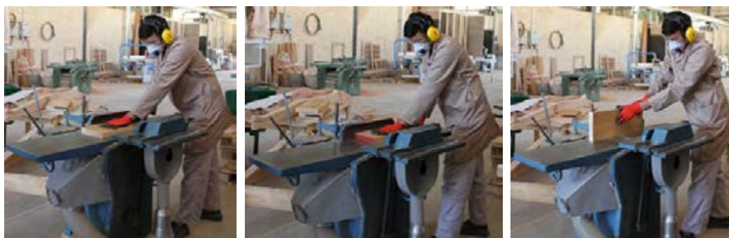
شکل ۷۰- یک رو و یک نرکردن چوب
