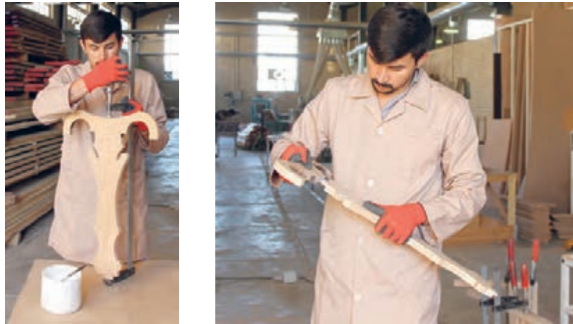
شکل ۱۰۴- کنترل صحیح بودن اتصالات و مونتاژ تاج و پشتی
