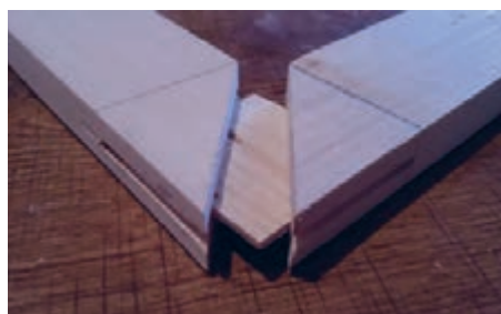
ج) مونتاژ اولیه زاویه برای صحیح بودن و همرو بودن اتصال
