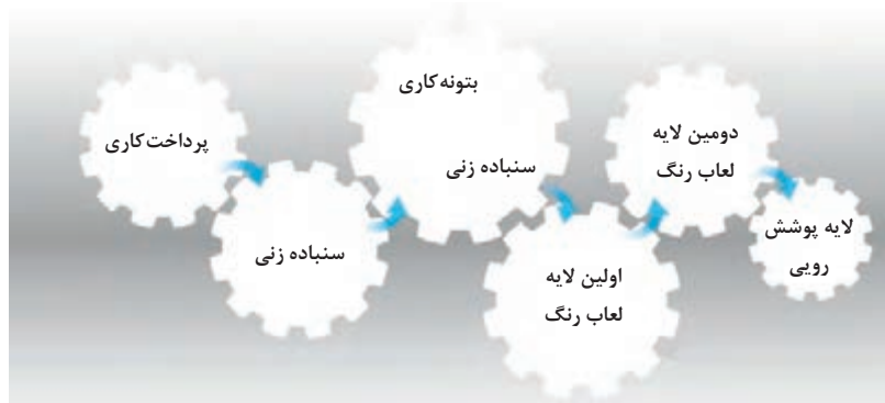
شکل ۱۱۵- مراحل اجرای رنگ کاری
