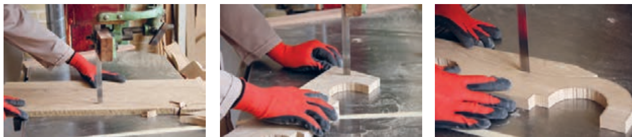
شکل ۸۳- عمل قوس‌بری یک مرحله‌ای بغل، پشتی، کناره و بالای تاج
