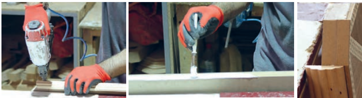
شکل ۷۴- چسب زدن و مونتاژ زهوار با چسب و دستگاه میخکوب
