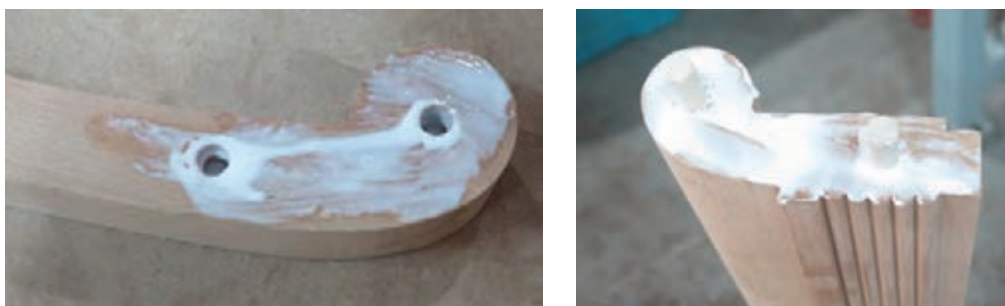
شکل ۴۶- روش چسب زدن اتصال دوبل پایه‌های عقب
