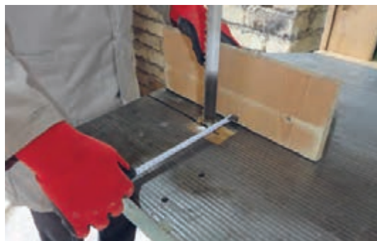
شکل ۷۴- اندازه‌گیری فاصله تیغه با گونیا
