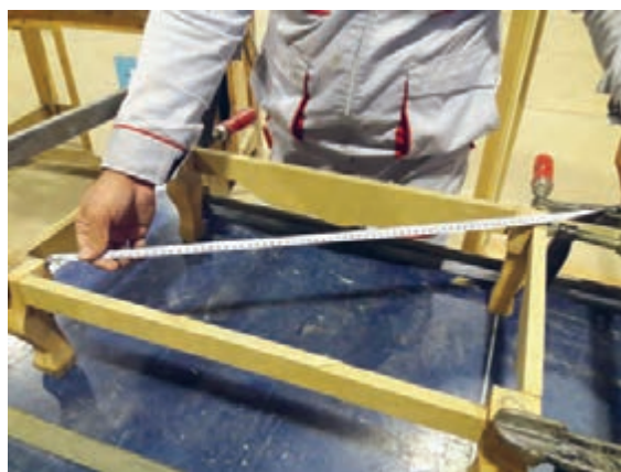
شکل ۷۲- مونتاژ به وسیله گیره دستی و کنترل دوئیدگی
