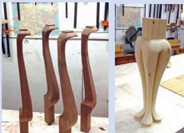
شکل ۵۱- آماده شدن پایه‌ها برای ایجاد کام
