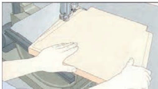
بریدن کفی توسط دستگاه اره نواری
