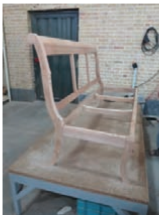
شکل ۵۴- مونتاژ مجموعه پشتی مبل با جلو مبل توسط قیدهای بغل
