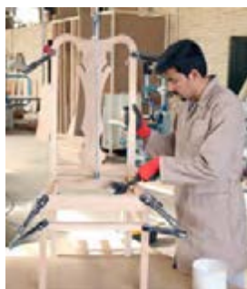
شکل ۱۰۷- جا زدن نبشی به وسیله چکش پلاستیکی
