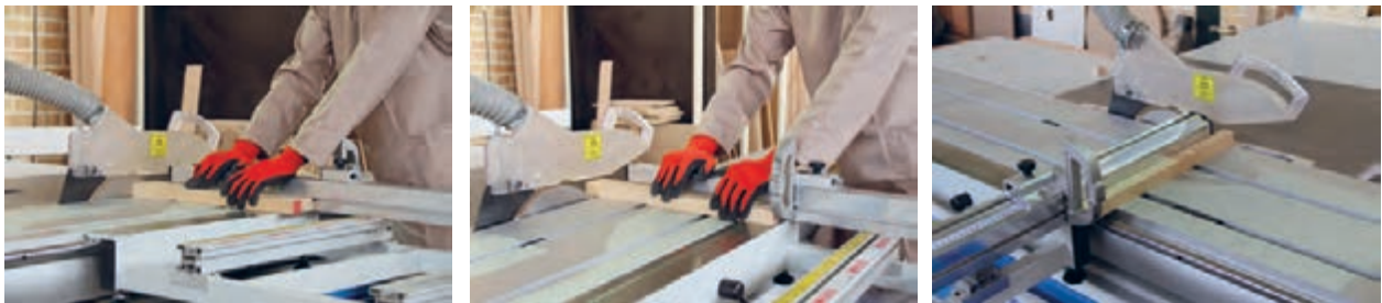
شکل ۷۹- مراحل مختلف یک اندازه کردن قیدها با دستگاه اره مجموعه ای
