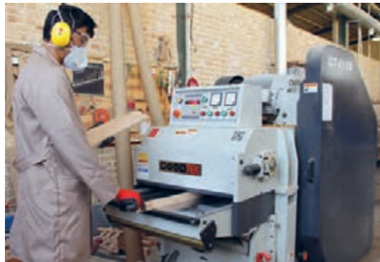
شکل ۷۸- نحوه گندگی کردن چوب‌های کم عرض
