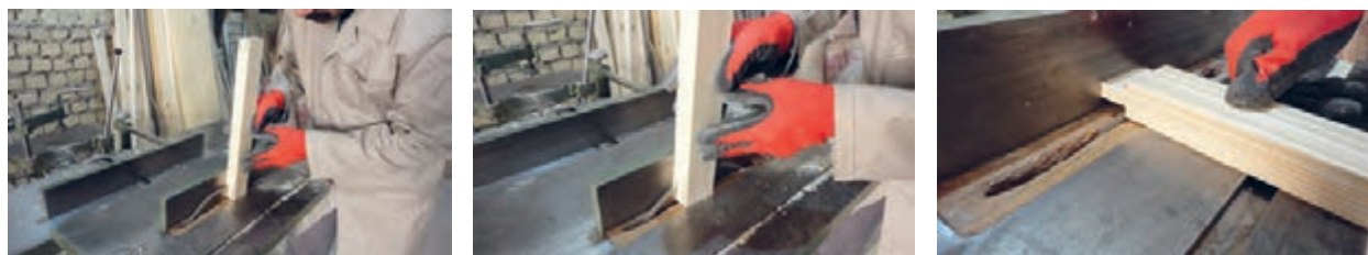
شکل ۹۱- عملیات برش زبانه با دستگاه اره گرد
