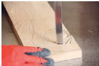
شکل ۸۱- عمل قوس‌بری (الف) به روش برش مستقیم از خارج کار (ب) به روش قوس‌بری از گوشه مماس بر دایره
