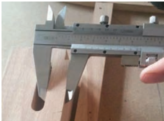
شکل ۴۱- کنترل دقیق بودن اندازه اتصال به وسیله کولیس
