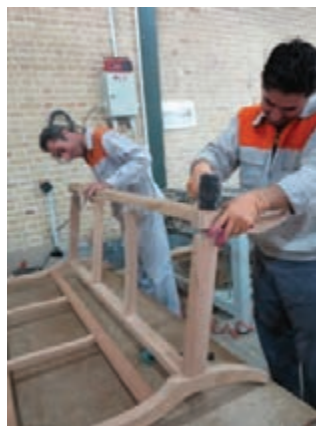
شکل ۵۴- مونتاژ مجموعه پشتی مبل با جلو مبل توسط قیدهای بغل
