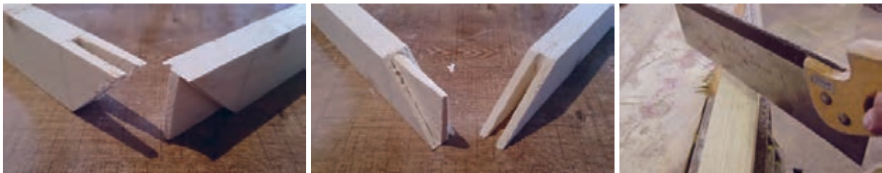
شکل ۲۰- برشکاری اتصال دو رو فارسی
