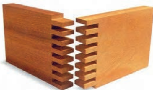
شکل ۱۱- اتصال انگشتی با تعداد زبانه زوج
