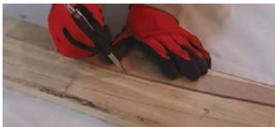
شکل ۴۳- انتقال الگوی پایه میز عسلی، از شابلون به روی چوب
