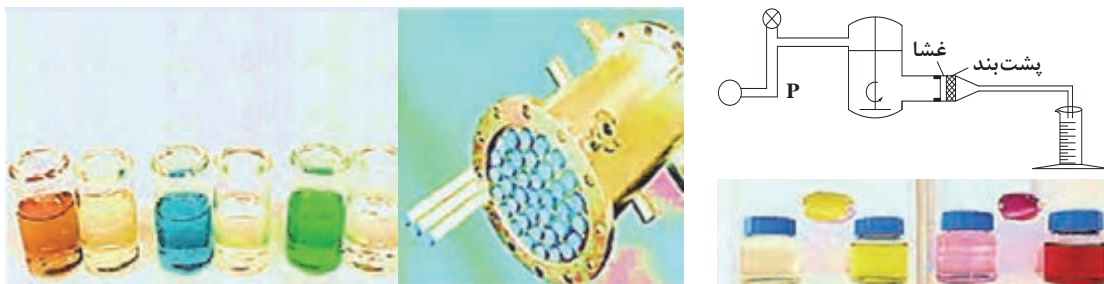
شکل ۲۳- غشای نانوفیلتراسیون به همراه نمونه پساب رنگی قبل و بعد از فیلتراسیون پساب رنگی
