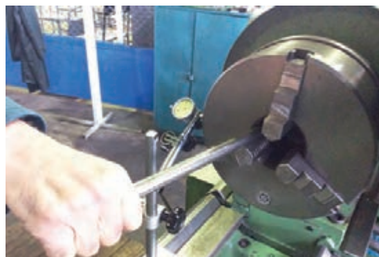
شکل ۳- اندازه گیری لقی شعاعی
