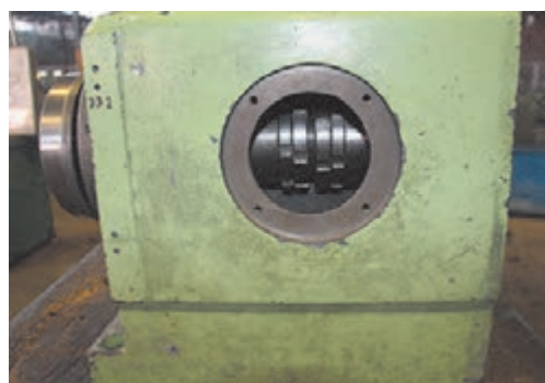
شکل ۵- سفت کردن یاتاقان جلوی دستگاه
