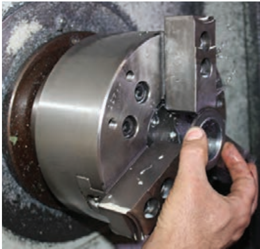
شکل ۳۰- بستن قطعه کار روی سه نظام
