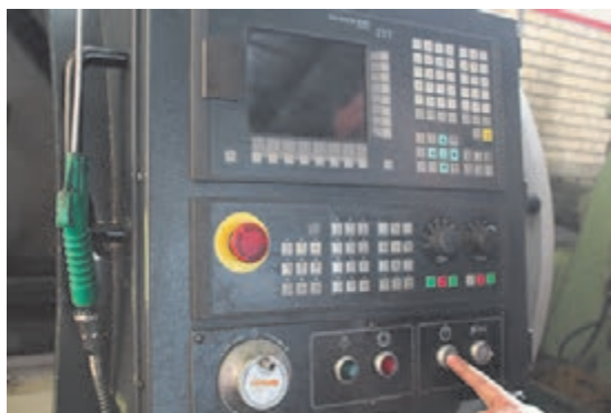
شکل ۱۹- روشن کردن سیستم هیدرولیک دستگاه
