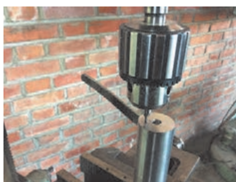
شکل ۲۳ - مته‌مرغک‌زنی به وسیله ماشین مته ستونی
