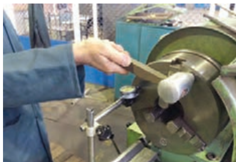
شکل ۷- اندازه‌گیری میزان لقی محوری
