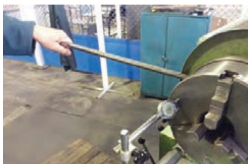
شکل ۷- اندازه‌گیری میزان لقی محوری
