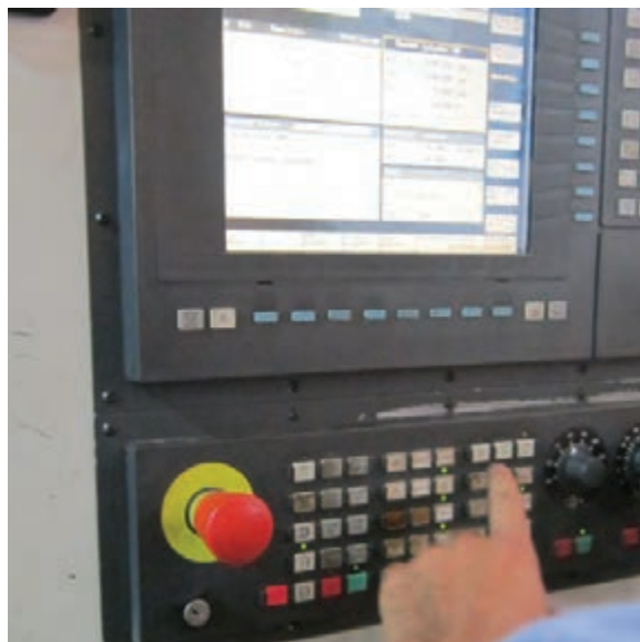
شکل ۲۴- زدن کلید TURRET
