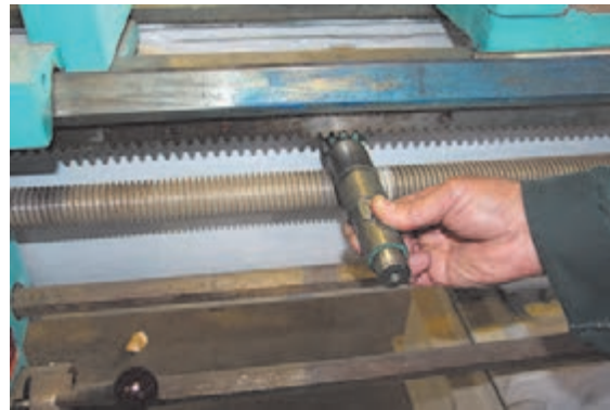
شکل ۱۵- درگیری چرخ دنده با دنده شانهای
