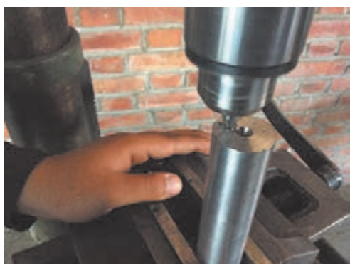
شکل ۲۳ - مته‌مرغک‌زنی به وسیله ماشین مته ستونی
