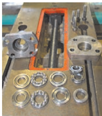
شکل ۹- یاتاقان‌بندی پیچ هادی محور عرضی
