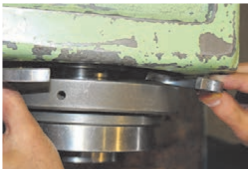
شکل ۴- خارج کردن نیم‌واشرها
