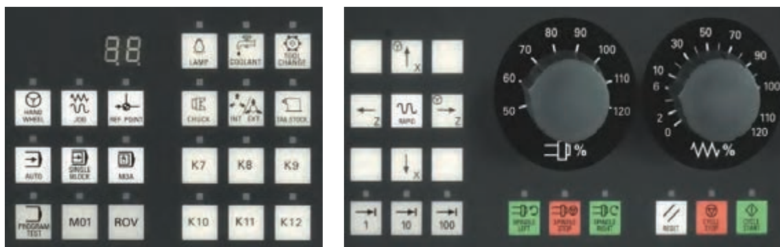
شکل ۱۷- کلیدهای اپراتوری سیستم کنترل
