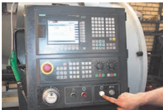
شکل ۲۱- زدن مجدد کلید سیستم هیدرولیک
