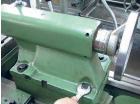
شکل ۲۸- سفت کردن پیچ‌های تثبیت
