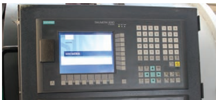
شکل ۱۴- قسمت برنامه‌نویسی سیستم کنترل
