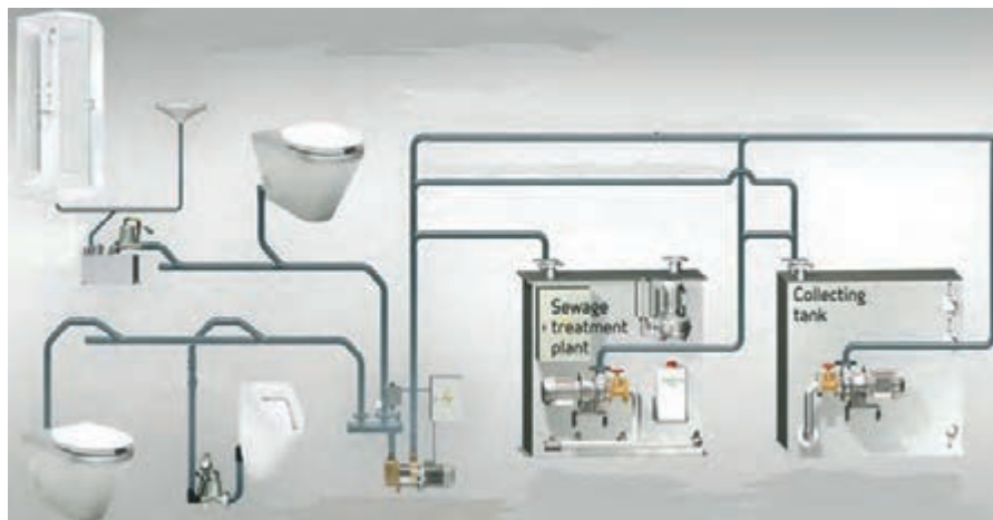
شکل ۱۴- نمودار سامانه دفع فاضلاب یک کشتی
