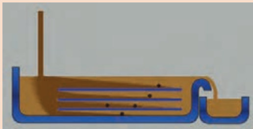
شکل ۲۰- نحوه قرار دادن صفحات موازی درون فیلتر
