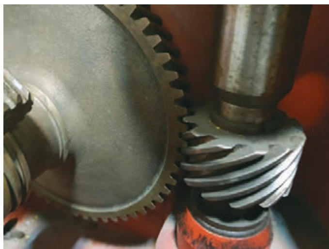
شکل ۲۵ - نحوه اتصال چرخ‌دنده‌های محور افقی و محور عمودی
