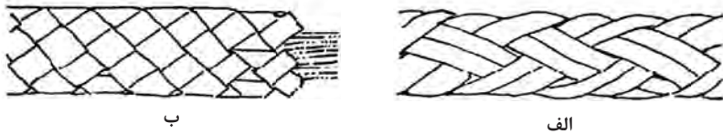
شکل ۲۵- ساختار نخ‌های بافته شده. الف) گیس باف ب) لوله‌ای با مغزه
