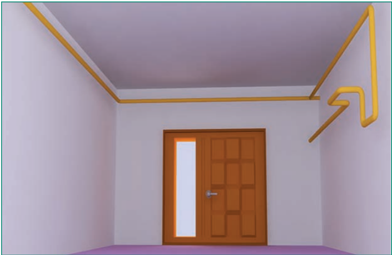
شکل ۴-۲۳ الف نمایش مسیر لوله‌ها در داخل راهرو
