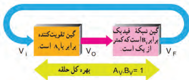
شکل ۶-۳۰ بررسی اصل بارک‌هاوزن
