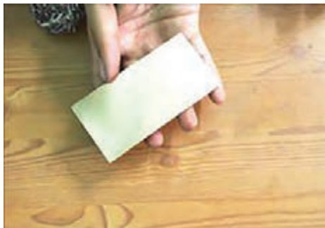
شکل ۳-۱۰- فیبر مسی تمیز شده
