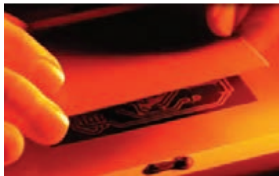
شکل ۳-۲۱- قرار دادن فیبر روی نقشه
