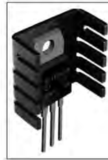
شکل ۷-۶۸ ترایاک متصل شده به گرماگیر
