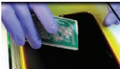
شکل ۳-۲۶- فیبر ظاهر شده پس از شست‌وشو شکل ۳-۲۷- قرار دادن فیبر داخل اسید شکل ۳-۲۸- خروج فیبر از اسید
