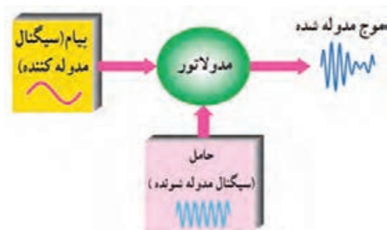
شکل ۶-۴۸ بلوک دیاگرام نحوه انجام مدولاسیون
