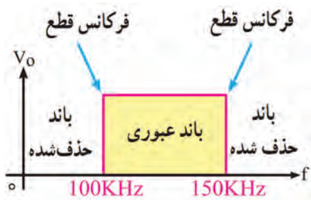
شکل ۵-۶ منحنی پاسخ فرکانسی فیلتر ایده‌آل
