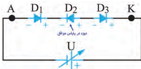
شکل ۷-۵ دیود چهار لایه در بایاس مخالف
