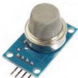
شکل ۹۸-۴- ماژول تشخیص گاز خانگی
