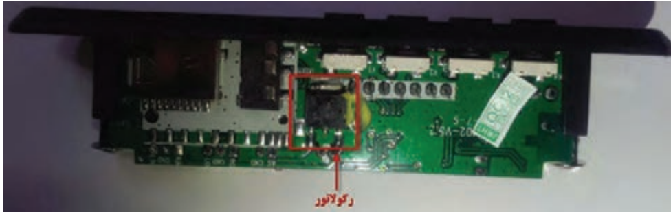
شکل ۵-۸- برد MP۳ با رگولاتور ۷۸۰۵ داخلی
