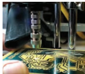
شکل ۳-۲۹- سوراخ کاری فیبر مدار چاپی
