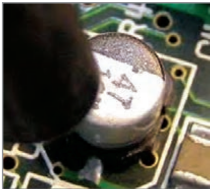
شکل ۲-۳ دمونتاز خازن سرامیکی و الکترولیت SMD
