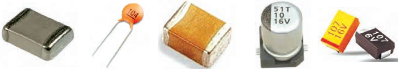
شکل ۱-۲۳ خازن سرامیکی SMD و معمولی
