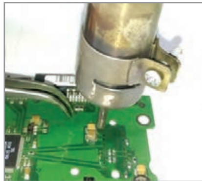
شکل ۲-۳ دمونتاز خازن سرامیکی و الکترولیت SMD
