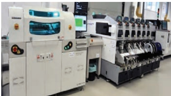
شکل ۳-۱۱ دستگاه تمام خودکار مونتاژ قطعات SMD
