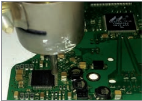
شکل ۲-۴ دمونتاز آی سی های چهار طرفه (خرچنگی)
