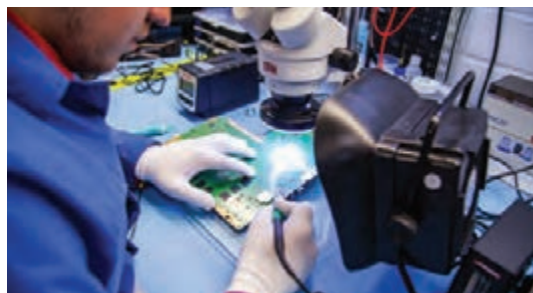
شکل ۲-۳ مونتاژ دستی بردهای الکترونیکی
