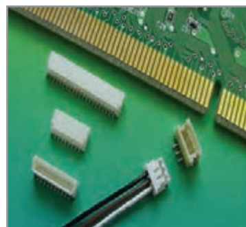
شکل ۲-۶ کانکتور پلاستیکی SMD
