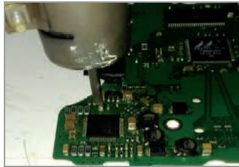
شکل ۲-۴ دمونتاز آی سی های چهار طرفه (خرچنگی)
