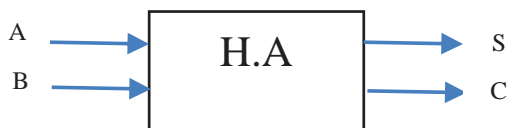
شکل ۲-۵ بلوک دیاگرام جمع کننده ناقص
