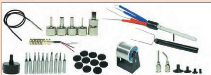
شکل ۱-۶ اتصالات و ملحقات هویه SMD
