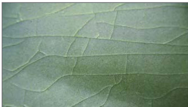
شکل ۲۶- عیب ترک برداشتن لعاب
