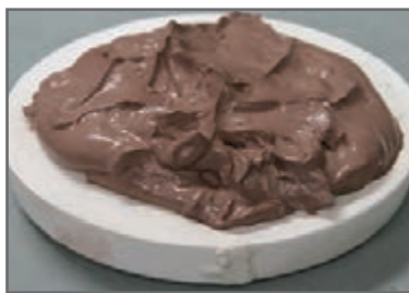
الف - گل پخش شده روی سطح گچ
