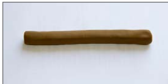
گل با شکل‌پذیری مناسب - بدون ترک
