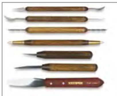
شکل ۱۰- ابزارهای برشی برای ایجاد نقش بریده
