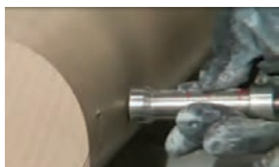
شکل ۷- اندازه‌گیری سختی شمش گل قبل از شکل‌دهی
