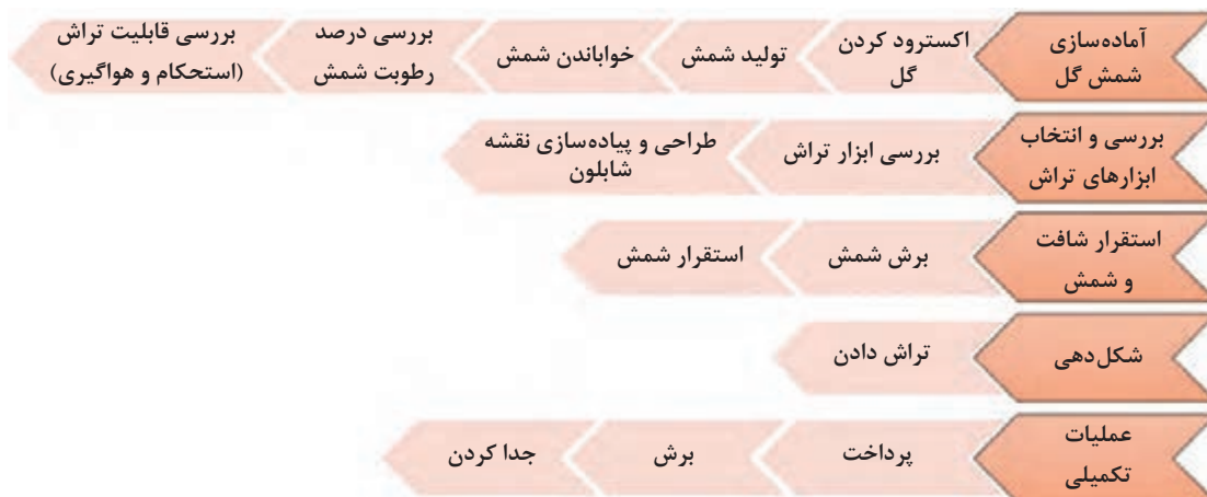
شکل ۷- مراحل شکل‌دهی گل پلاستیک به روش تراش
