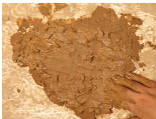
شکل ۱۰- تهیه گل یکنواخت با دوغاب
