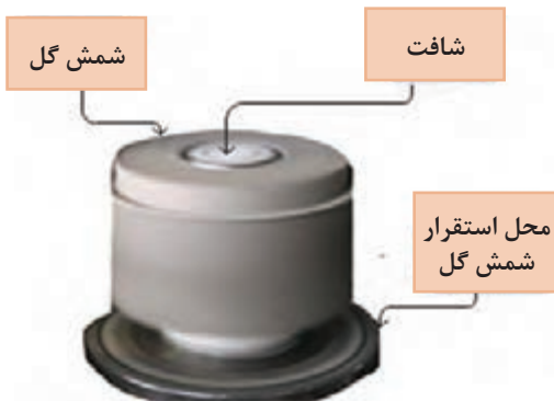
شکل ۱۵- استقرار شافت و شمش گل
