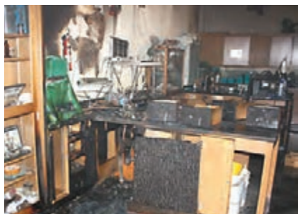
شکل ۱۹-۵- تصویری از سانحه روی داده به دلیل نگهداری نادرست مواد آتش‌گیر
