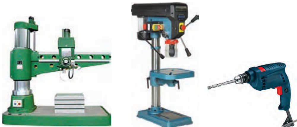
شکل ۱۱- چند نمونه ماشین سوراخ کاری (دریل)
