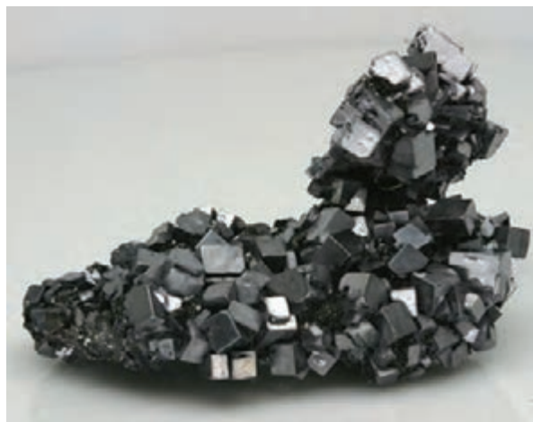
شکل ۲-۱۲- جلائی فلزی در گالن
