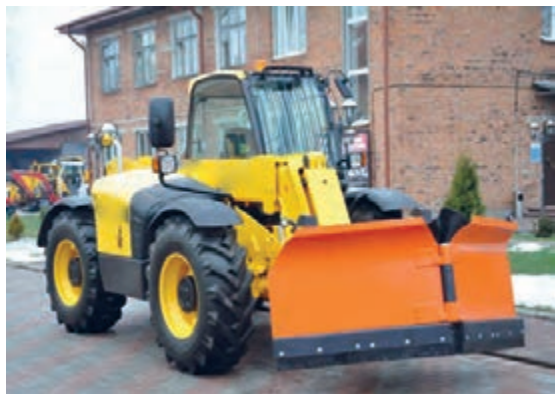
(ب) ماشین برف‌روب تراکتوری
