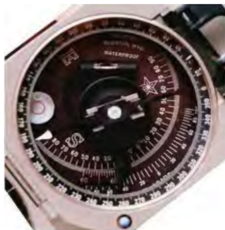
تنظیم تراز لوبیایی (استوانه‌ای) برای قرائت مقدار شیب
