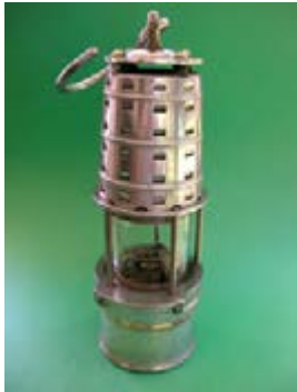
چراغ سنجنده مقدار اکسیژن در معدن
